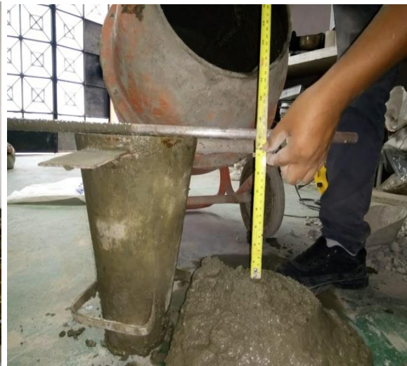
Medida del Slump concreto reciclado
