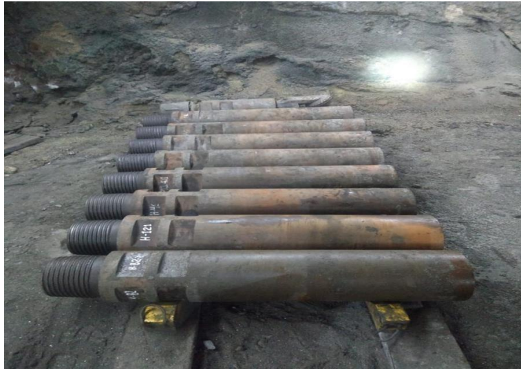
Tuberías de perforación 254 mm * 0.91 m
