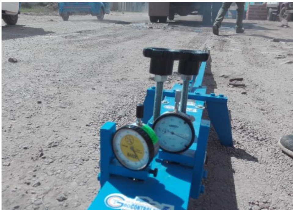
Fotografía 112. "Medidas de los diales a medida que el camión avanza"
