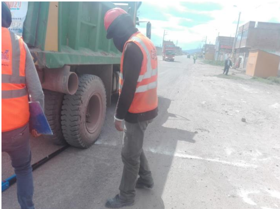
Fotografía 116. "Camión puesto en marcha en el ensayo de deflectometría"
