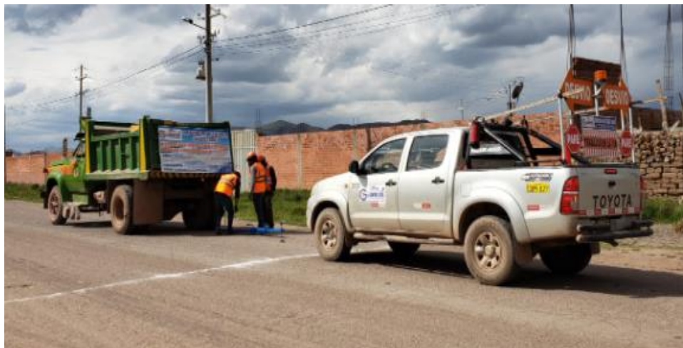
Fotografía 105. "Vehículo de señalización del ensayo y ubicación de la viga Benkelman"
