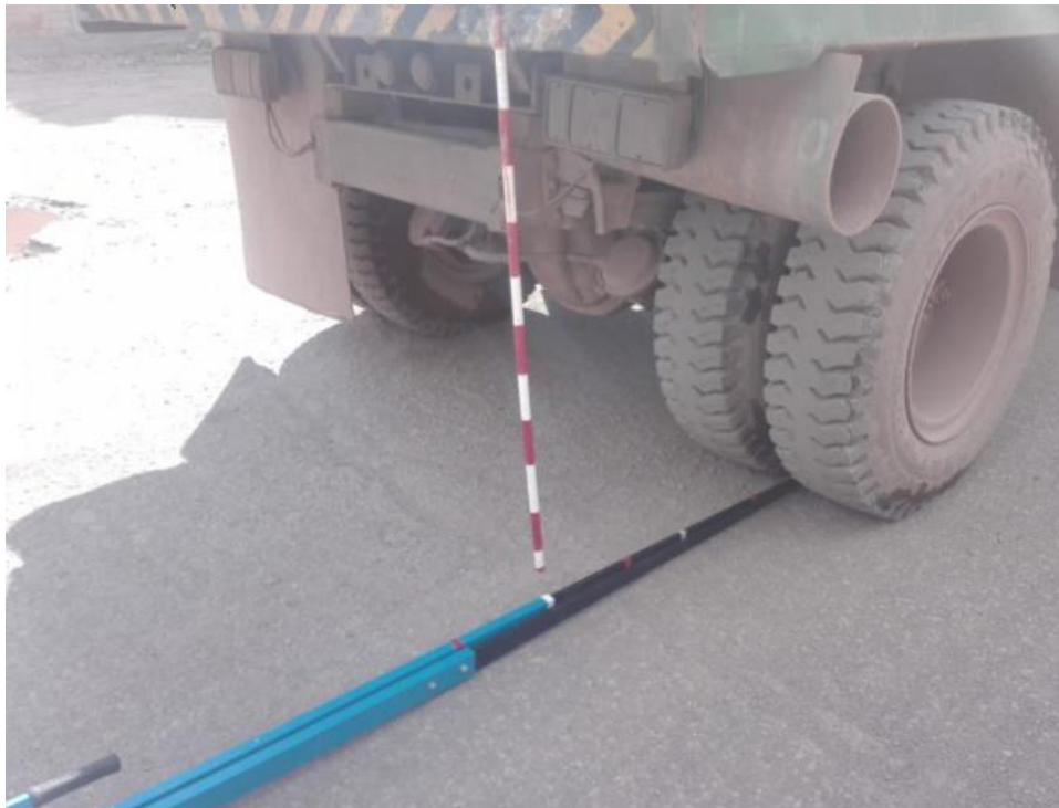
Fotografía 110. "Ubicación de la punta de la viga Benkelman y verificación de las marcas para las medidas que serán registradas"
