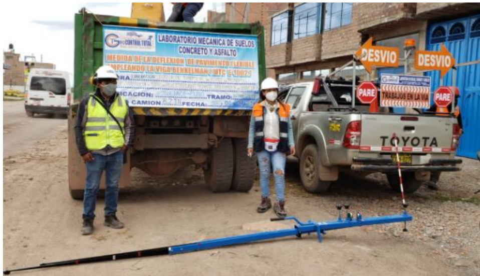
Fotografía 104. "Camión cargado y la viga Benkelman para el ensayo de deflectometría"
