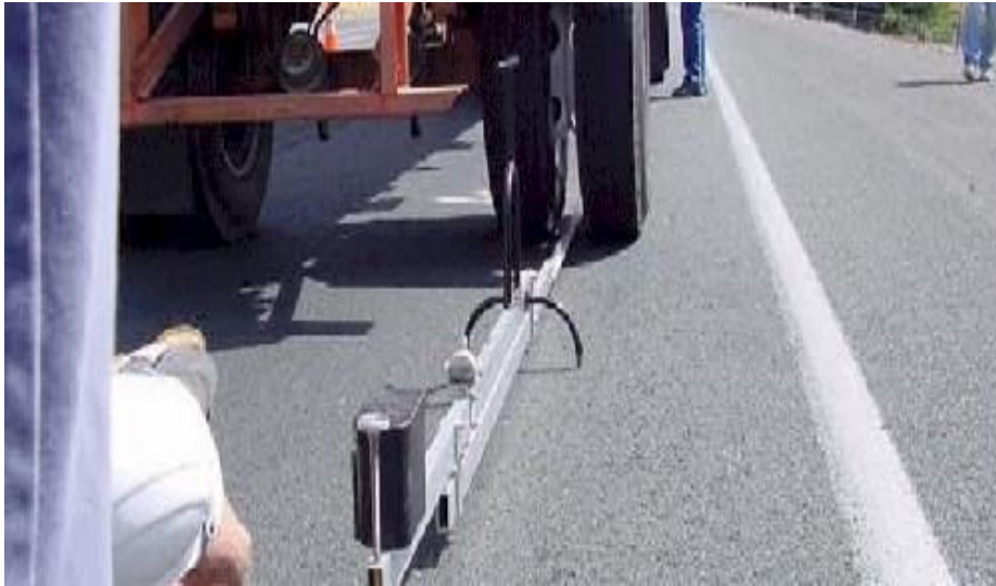
Figura 20. "Ensayo de la viga Benkelman"
