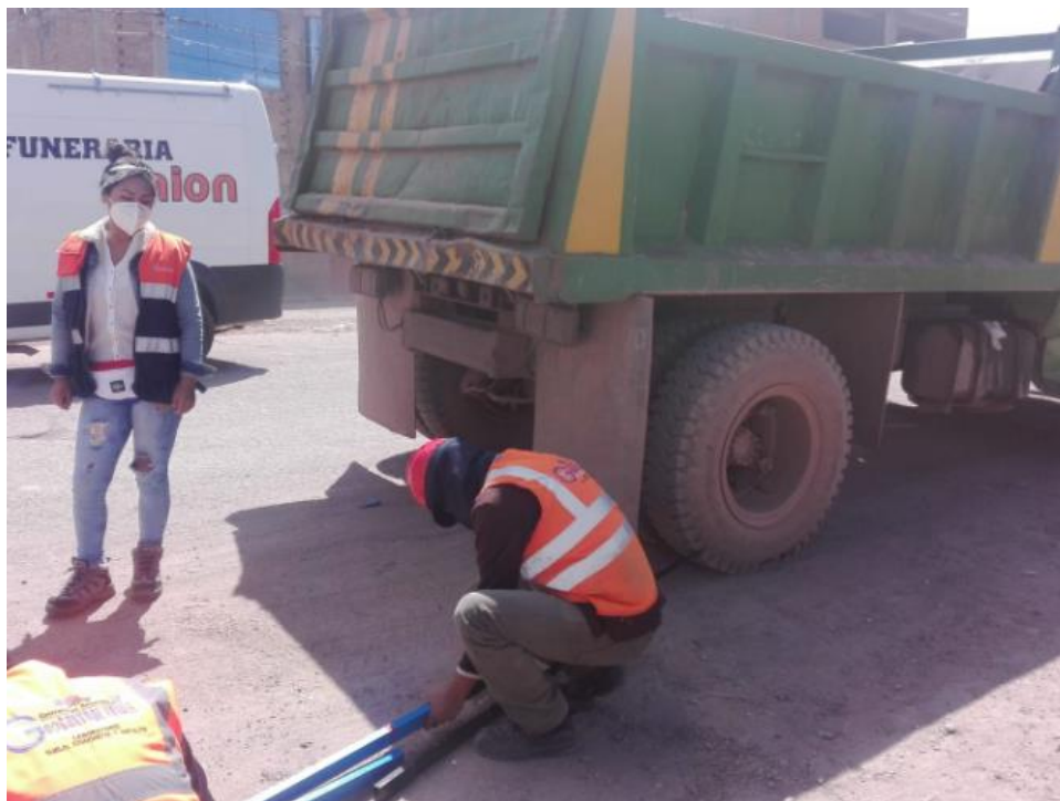
Fotografía 114. "Armado de la viga Benkelman en el punto de ensayo"
