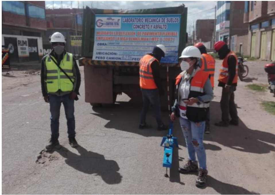
Fotografía 113. "Ensayo de deflectometría con la viga Benkelman"
