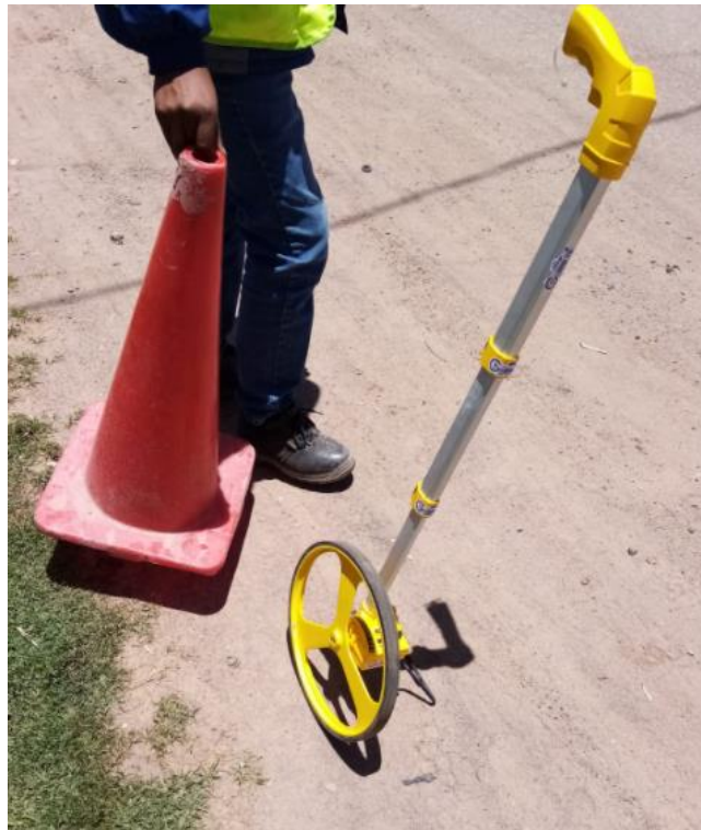
Fotografía 23. "Instrumentos necesarios para las marcas en campo de las unidades o puntos a evaluar"
