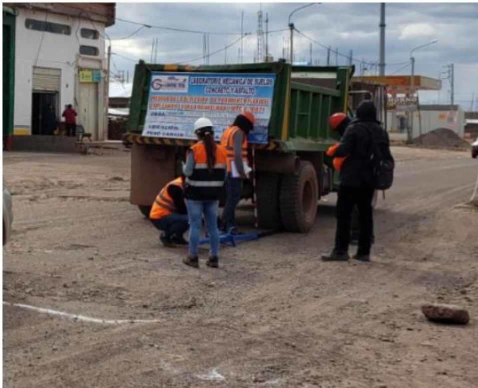
Fotografía 108. "verificación de la puesta de la viga Benkelman en el punto de ensayo"
