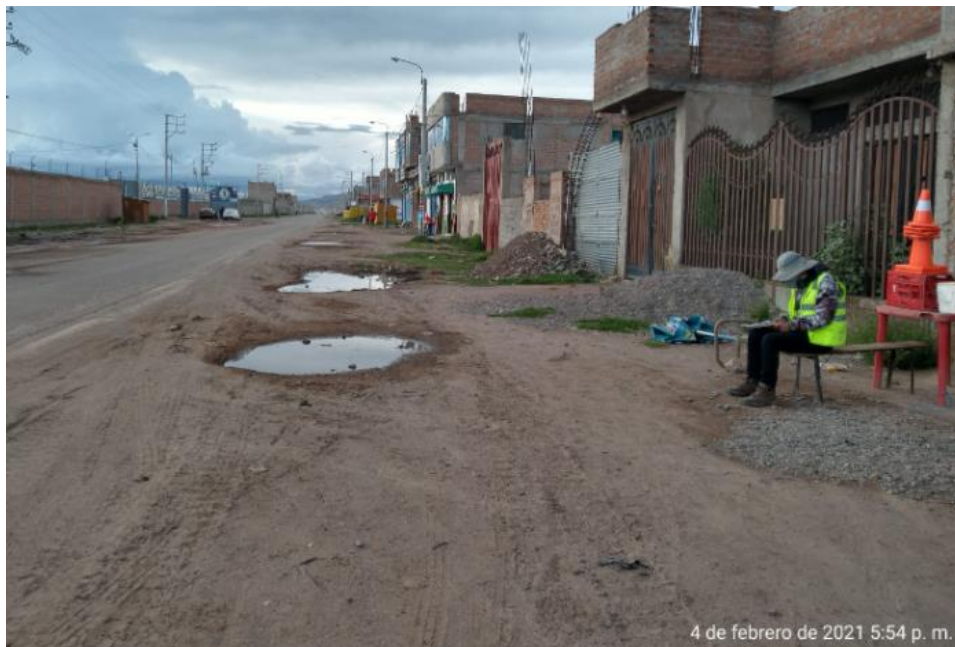
Fotografía 24. "Registro de vehículos para el estudio de tráfico de la vía Juliaca - Lampa"
