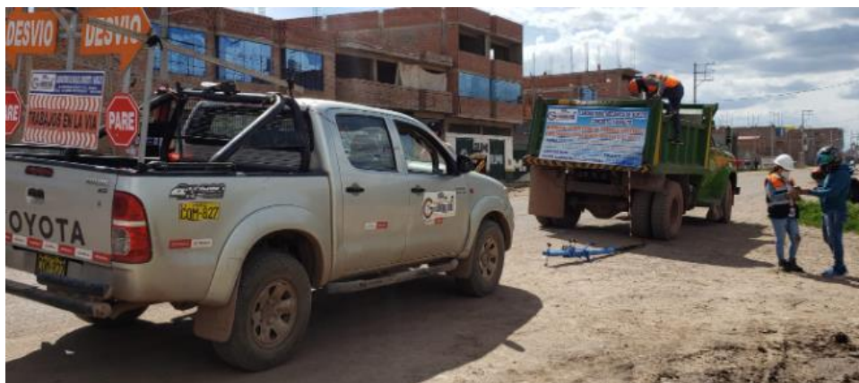
Fotografía 106. "Ensayo de deflectometría lista para que el camión avance"
