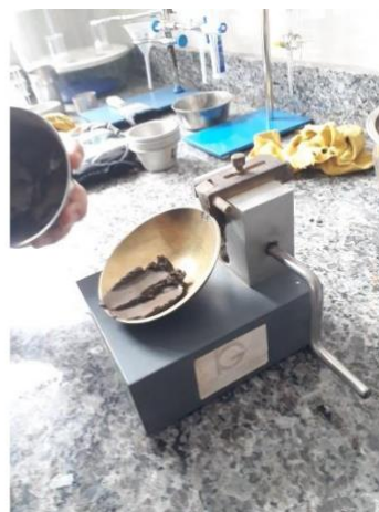
Cuchara de Casagrande con muestra que cerró en 25 golpes.
