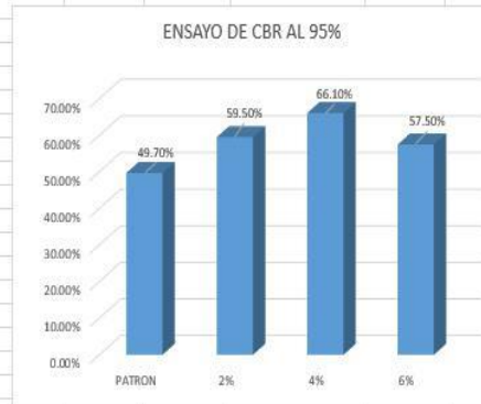
Gráfico de los resultados del ensayo de CBR al 95% del suelo natural y el suelo añadiendo las diferentes dosificaciones
