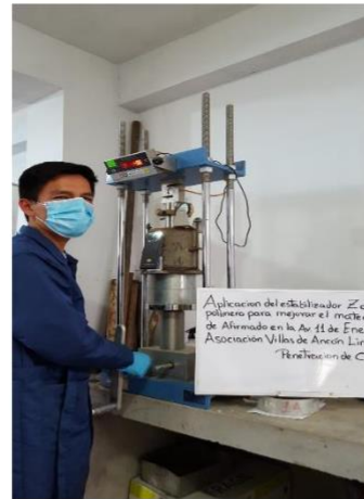
Realización de la penetración con la máquina de presiones
