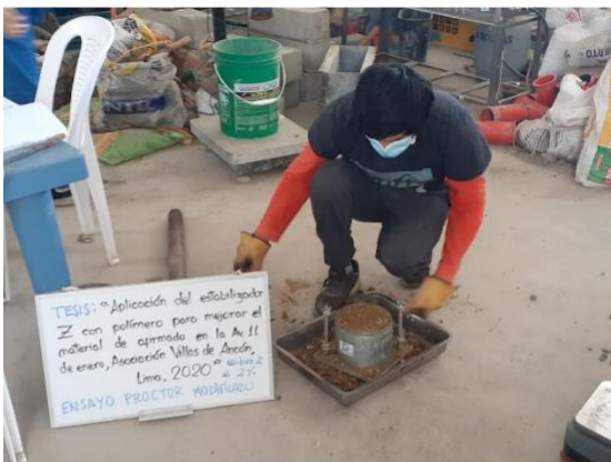
Colocamiento de la última capa en el molde para el Compactación del suelo cada 3 capas con proctor modificado
