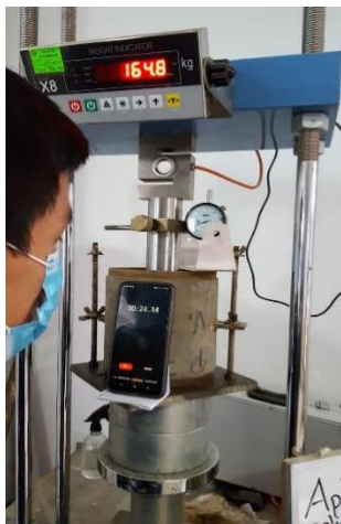
Lectura de penetración con máquina de presiones
