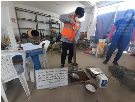
Tesista hace la compactación del suelo cada 3 capas con 56 golpes con pisón manual
