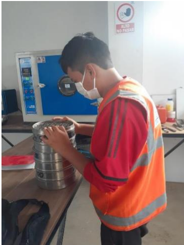
Acomodando los tamices para el ensayo de granulometría
