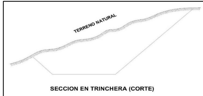
Figura 3: Sección en trinchera.
