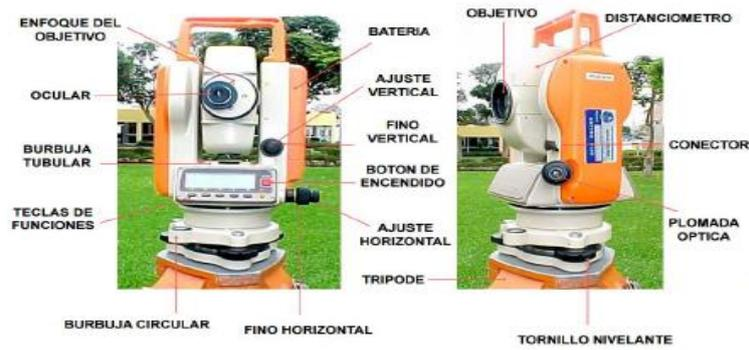
Figura 6: Partes del equipo topográfico estación total.
