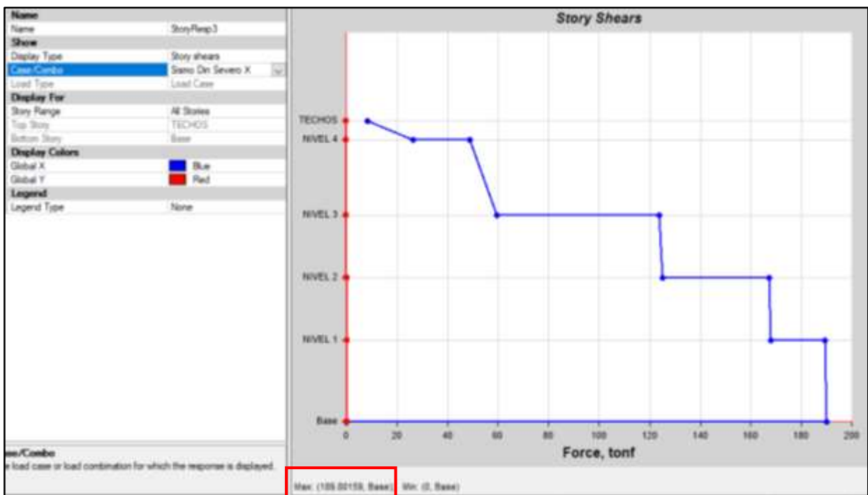
Figura 25. Elaboración propia, Gráfico de la cortante basal dinámica para el eje "X".
