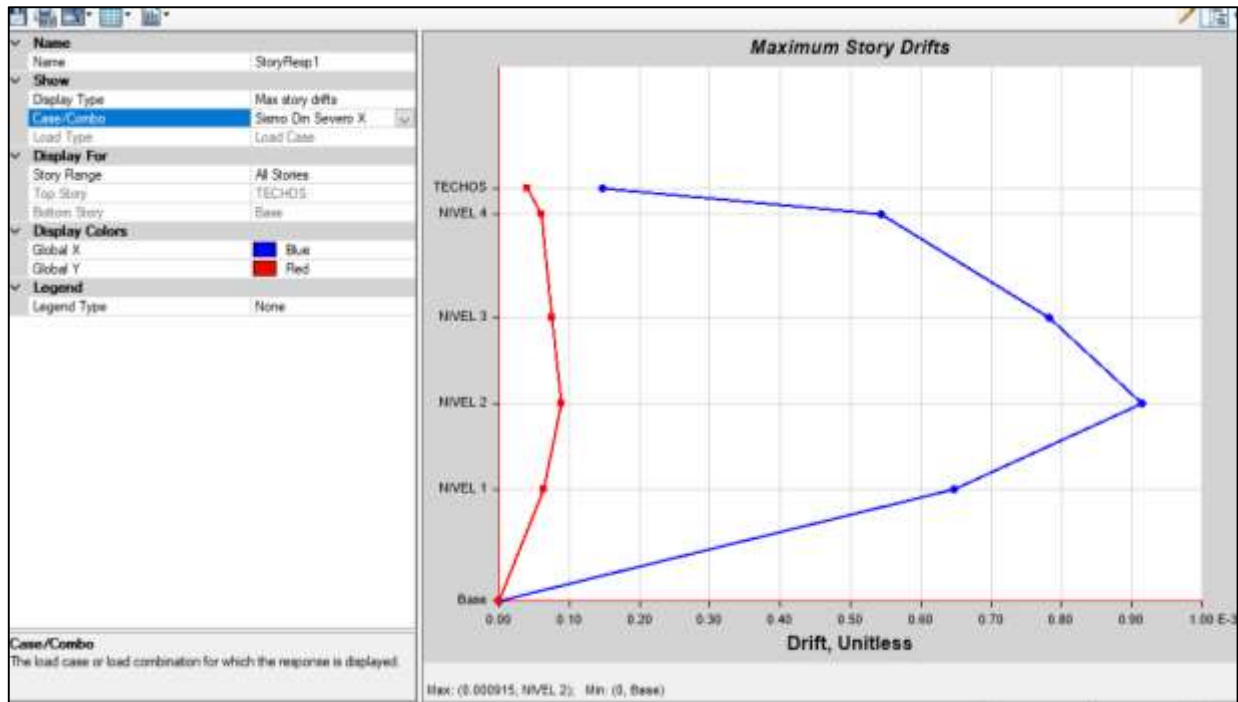
Figura 36. Elaboración propia, Derivas inelásticas en eje X-X.
