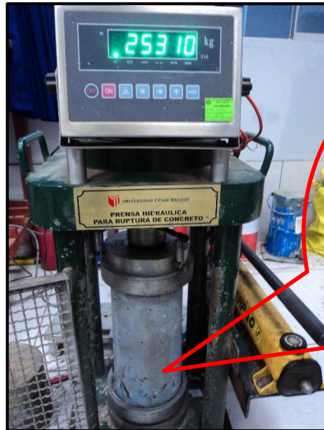
Probeta N°01, según IMCYC falla 5
