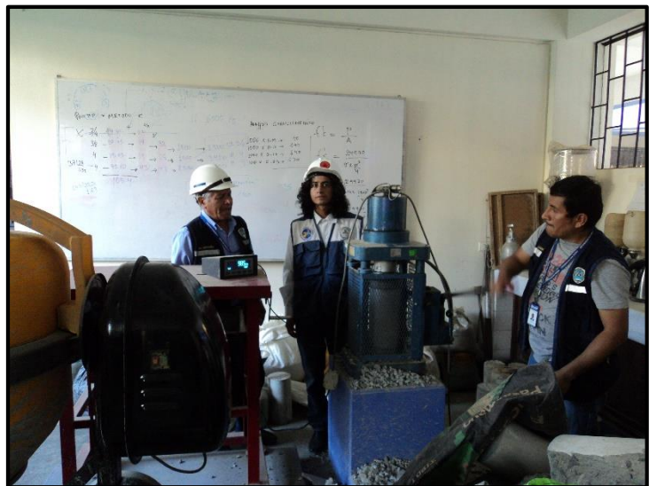
Imagen 09: Ensayo de a compresión de 4 probetas de concreto patrón, 10 probetas de Exp. N°01 y 10 probetas de Exp. N°02, en el laboratorio de suelos de la UCV – Nuevo Chimbote, Santa Ancash. Fuente propia, 2019.
