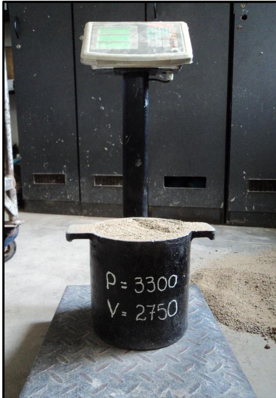
Grupo de imágenes 02: Ensayo de Peso Unitario suelto y compactado seco de los agregados, en el laboratorio de suelos de la USP - Chimbote, Santa Ancash. Fuente propia, 2019. Fuente propia, 2019.
