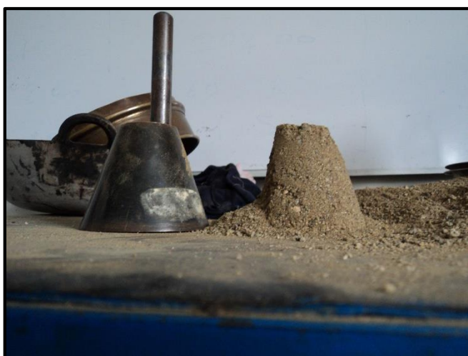
Grupo de imágenes 01: Procesos en el ensayo de absorción y peso específico de los agregados, en el laboratorio de suelos de la USP - Chimbote, Santa Ancash. Fuente propia, 2019.
