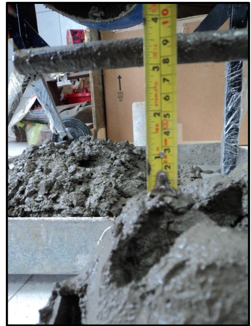
Grupo de imágenes 06: Se hizo la colocación de concreto en moldes, se realizó 6 probetas del Exp. N°01 para una edad de 14 y 28 días con un slump de 3.3", 6 probetas del Exp. N°02 para una edad de 7 y 14 días con un slump de 3.4" y 4 probetas del Exp. N°02 para una edad de 28 días con un slump de 3.4", en el laboratorio de suelos de la UCV – Nuevo Chimbote, Santa Ancash. Fuente propia, 2019. Fuente propia, 2019.
