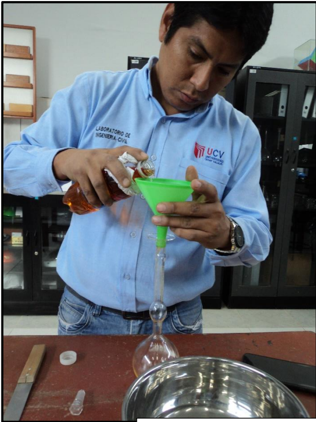
Grupo de imágenes 07: Se determinó el peso específico de las cenizas de cascara de arroz y donax sp (marucha), también se determinó los pesos específicos del Exp. N°01 y Exp. N°02, en el laboratorio de suelos de la UCV – Nuevo Chimbote, Santa Ancash. Fuente propia, 2019.
