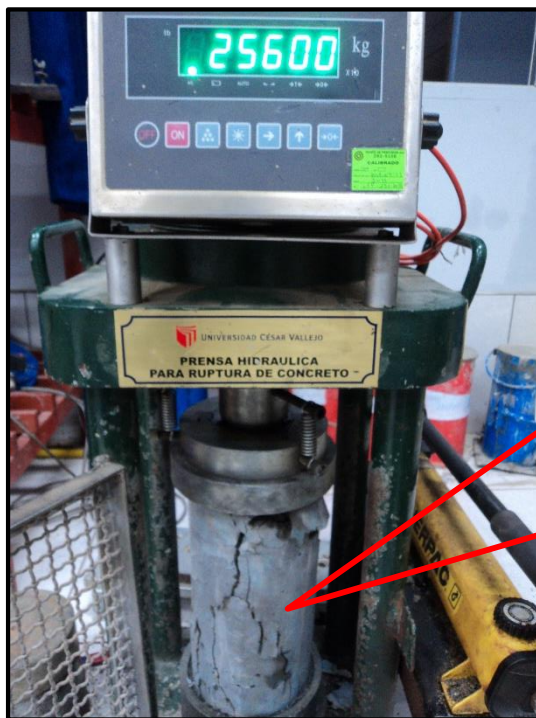
Probeta N°02, según IMCYC falla 6 (Cono y hendedura)
