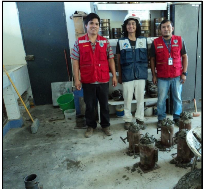
Grupo de imágenes 05: Se hizo la colocación de concreto en moldes, se realizó 10 probetas patrón (Para una edad de 7, 14 y 28 días) con un slump de 3.5” y 4 probetas del Exp. N°01 para una edad de 7 días con un slump de 3.13”. Hecho en el laboratorio de suelos de la USP- Chimbote, Santa Ancash. Fuente propia, 2019.
