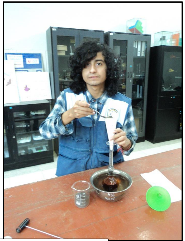
Grupo de imágenes 07: Se determinó el peso específico de las cenizas de cascara de arroz y donax sp (marucha), también se determinó los pesos específicos del Exp. N°01 y Exp. N°02, en el laboratorio de suelos de la UCV – Nuevo Chimbote, Santa Ancash. Fuente propia, 2019.
