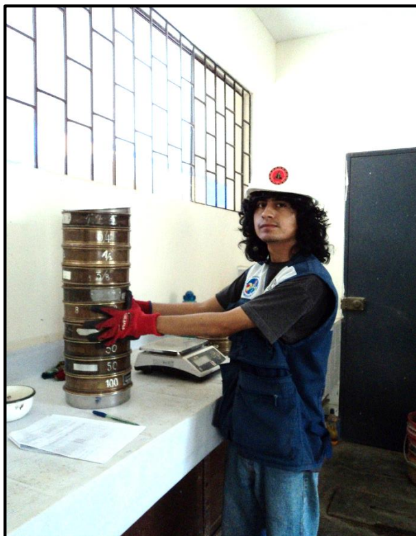
Imagen 03: Granulometría en agregado fino, más luego se procedió con el grueso en el laboratorio de suelos de la USP - Chimbote, Santa Ancash. Fuente propia, 2019.
