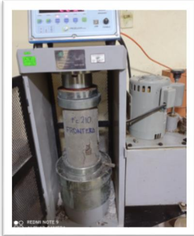
Figuras 15. Resistencia a la compresión cemento Frontera.
