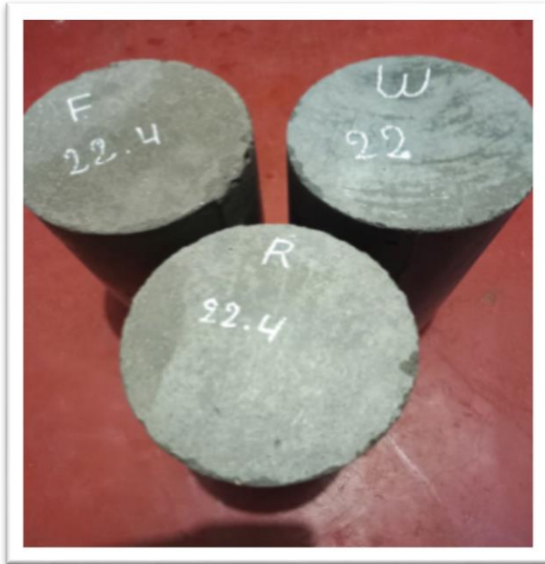
Foto 20: Probetas de concreto de los 3 tipos de cemento
