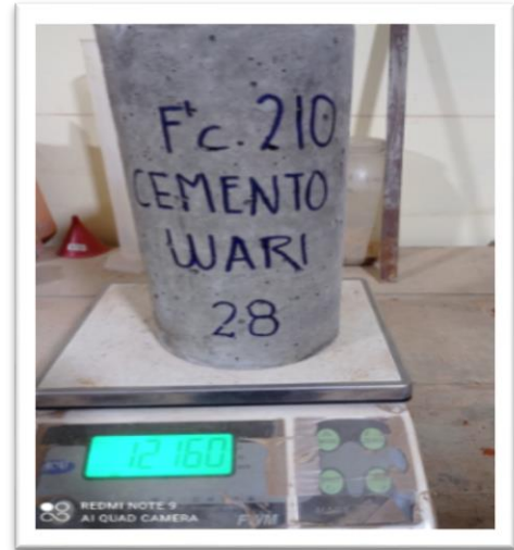
Foto 28: Peso de Probetas elaborado con cemento Wari.
