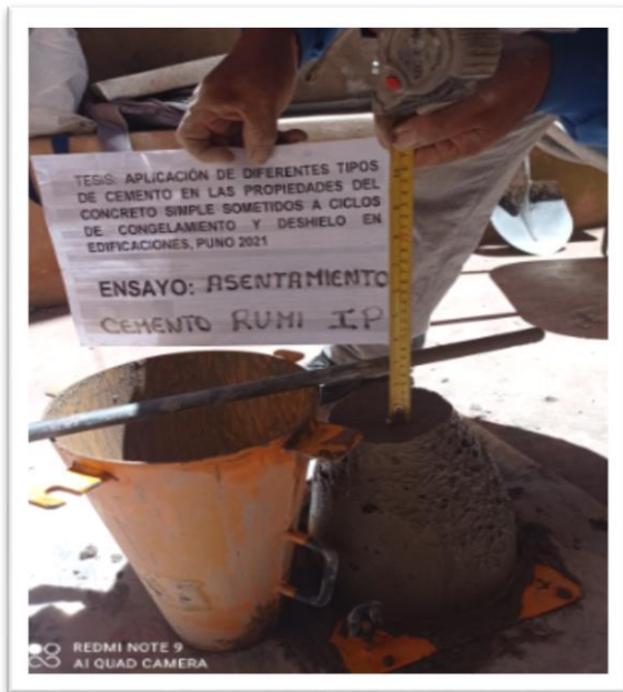
Foto 18: Asentamiento de concreto elaborado con cemento Rumi
