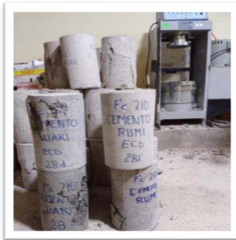
Foto 33: Resistencia a la compresion de Probetas elaborado con distintos cementos.
