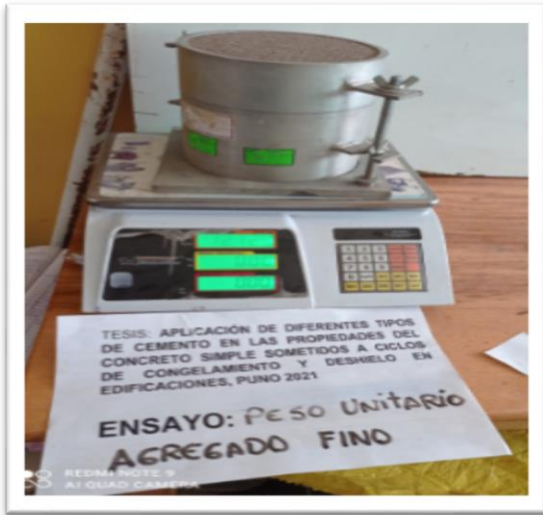
Foto 13: Peso Unitario del agregado fino.
