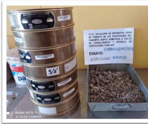
Foto 5. Granulometría del agregado grueso.
