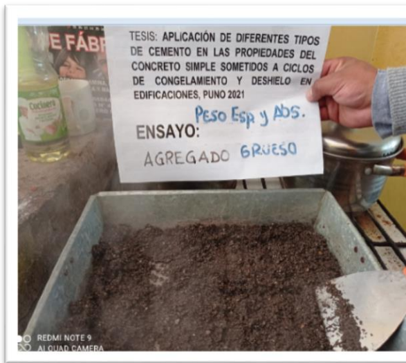
Foto 7. Secado del material para la determinación del peso específico y absorción.
