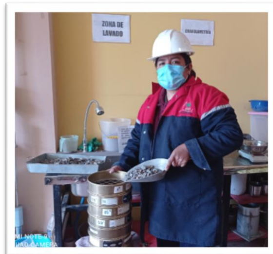
Foto 4. Realizando el tamizaje del agregado grueso.
