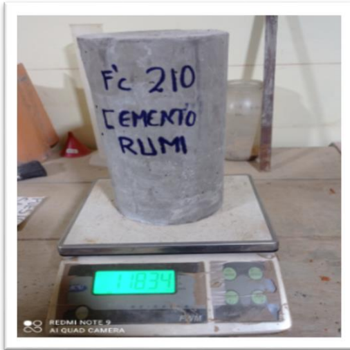
Foto 27: Peso de Probetas elaborado con cemento Rumi.
