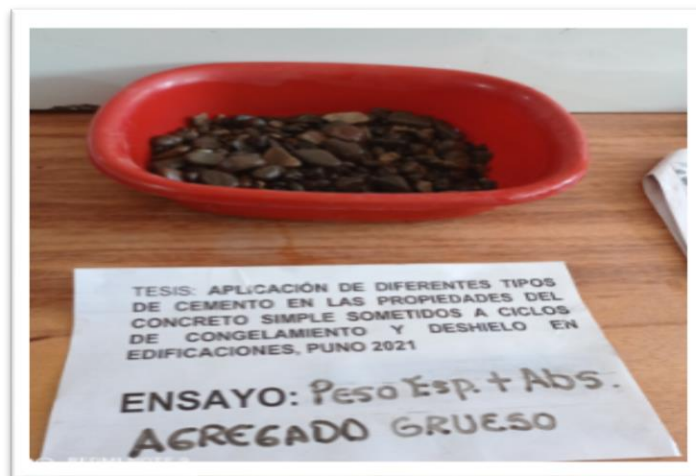
Foto 15: Determinando peso específico y absorción del agregado grueso.
