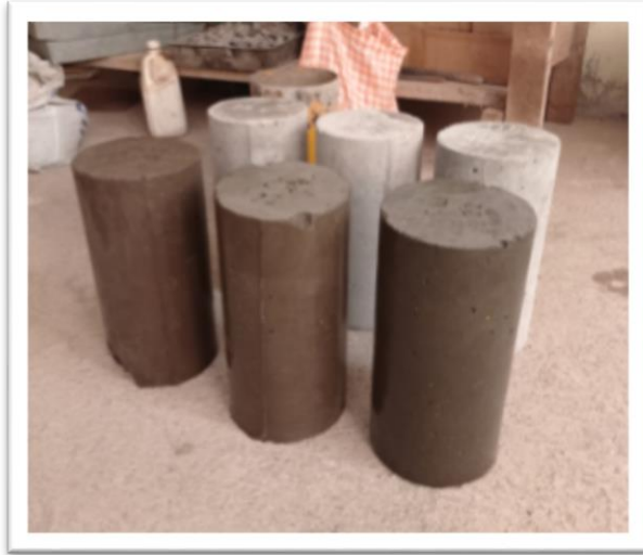
Foto 24: Probetas con y sin exposición al congelamiento y deshielo.
