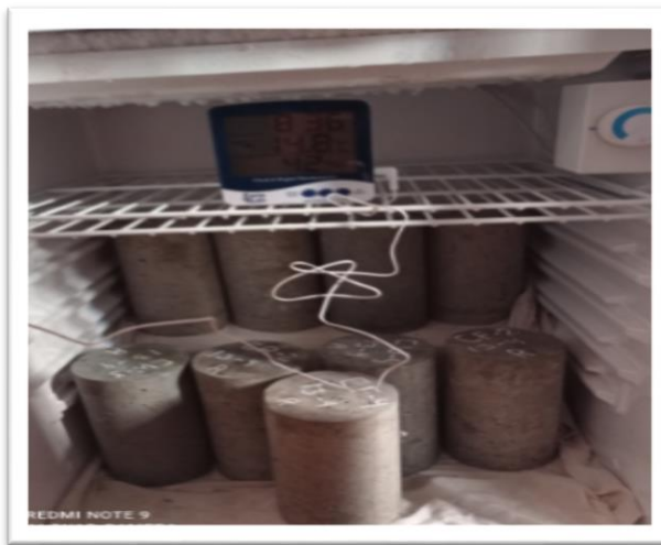
Foto 22: Exposición de Probetas al congelamiento controlado.
