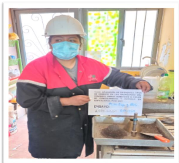
Foto 8. Determinando el peso específico y absorción.
