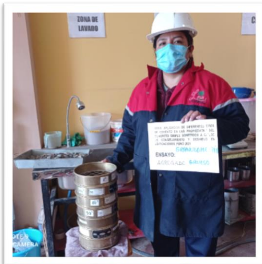
Foto 3. Realizando la granulometría del agregado grueso.
