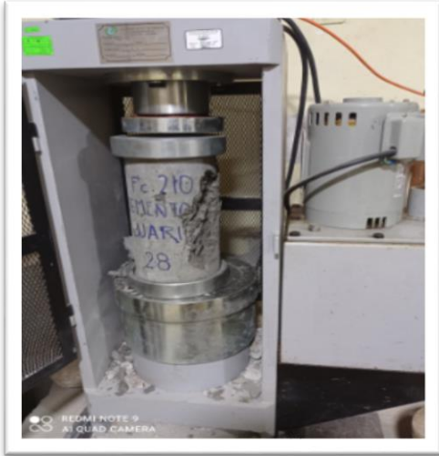
Foto 31: Resistencia a la compresion de Probetas elaborado con cemento Frontera.
