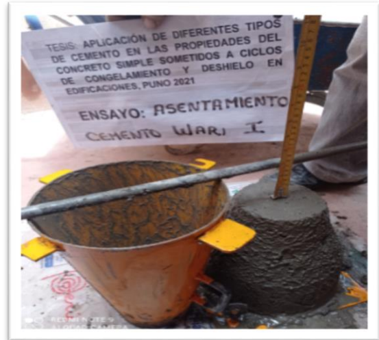
Foto 17: Asentamiento de concreto elaborado con cemento Wari.
