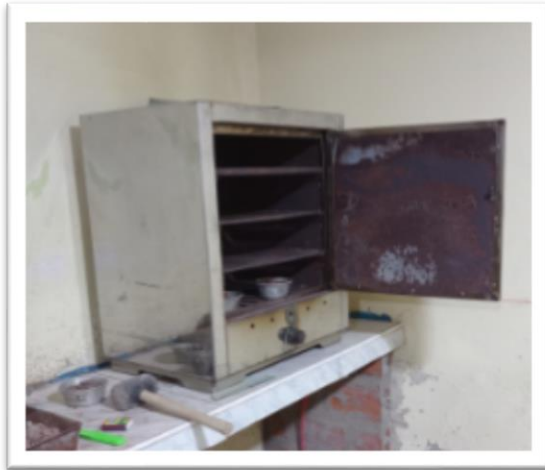
Foto 34: Estufa utilizada para secado de muestra.
