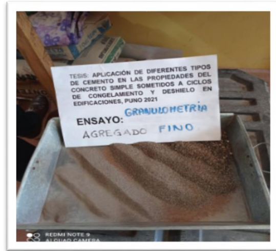
Foto 6. Granulometría del agregado fino.
