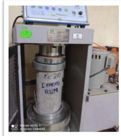
Figuras 16. Resistencia a la compresión cemento Rumi.
