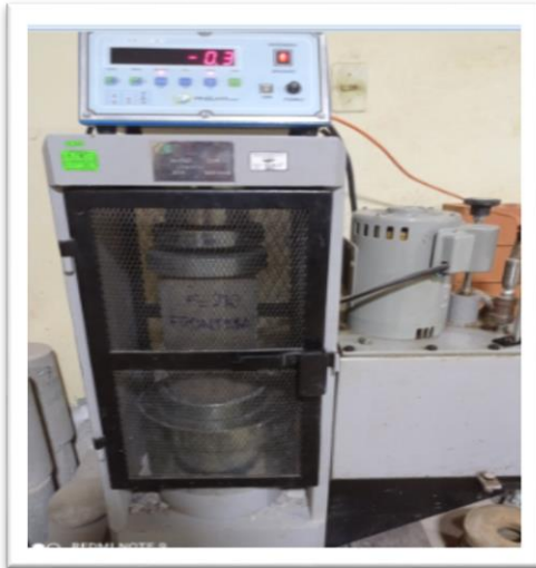
Foto 29: Resistencia a la compresion de Probetas elaborado con cemento Wari.
