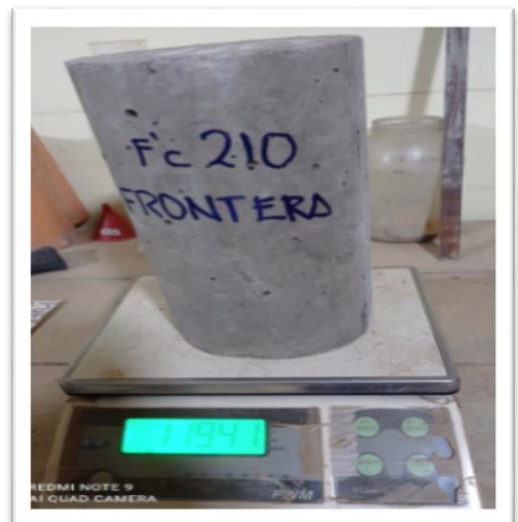
Foto 26: Peso de Probetas elaborado con cemento Frontera.
