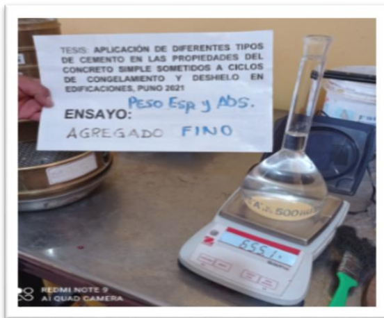
Foto 9. Determinando el peso específico y absorción del agregado fino.
