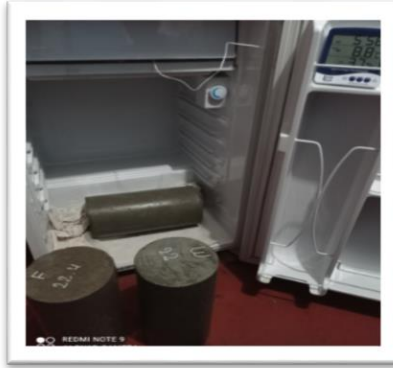
Figuras 19. Se expuso las Briquetas al congelamiento.
