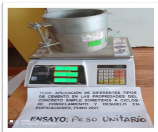
Foto 11: Determinando el Peso Unitario del agregado fino.
