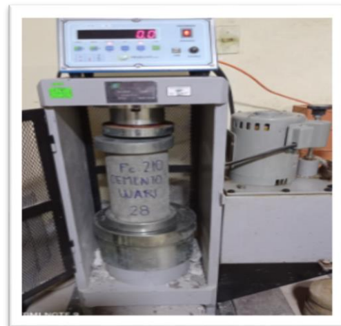
Foto 30: Resistencia a la compresion de Probetas elaborado con cemento Wari.
