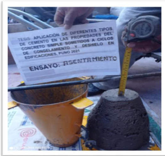
Foto 16: Asentamiento de concreto elaborado con cemento Frontera
