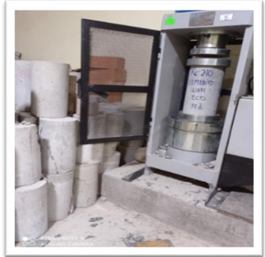
Foto 32: Resistencia a la compresion de Probetas elaborado con cemento Rumi.
