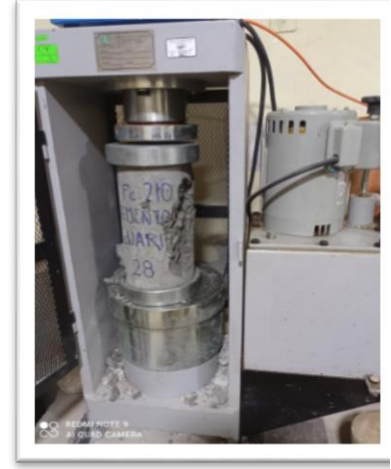
Figuras 17. Resistencia a la compresión cemento Wari.
