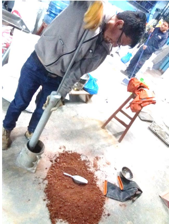
Imagen 17: Compactación con energía modificada
