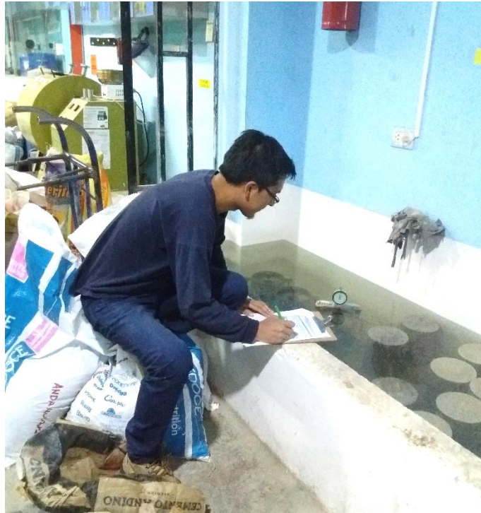
Figura 33: Vista del control de expansión de la muestra
