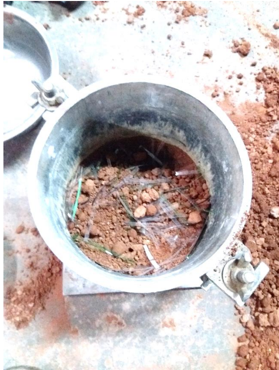
Imagen 19: Preparación de la muestra de suelo con la adición del tereftalato de polietileno reciclado
