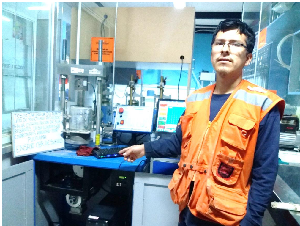
Figura 34: Vista del equipo multiusos para ensayo CBR
