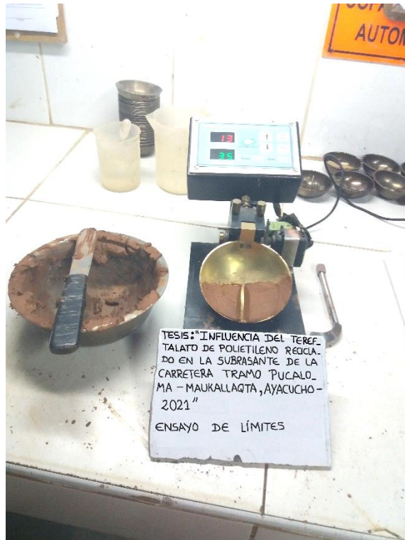
Imagen 15: Vista del ensayo de límites de atterberg
