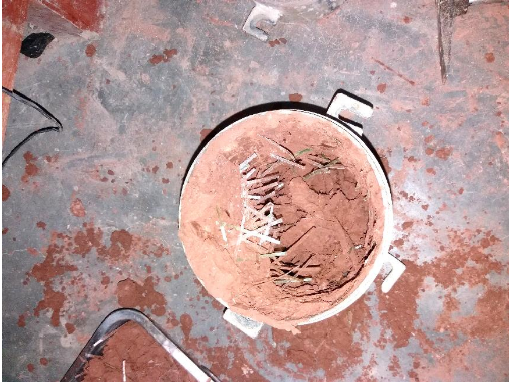
Imagen 27: Vista de la muestra con adición del tereftalato de polietileno después del ensayo de CBR
