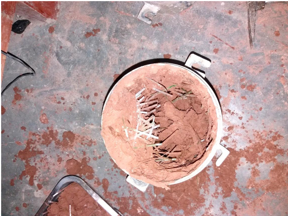
Imagen 28: Vista de la muestra con adición del tereftalato de polietileno después del ensayo de CBR
