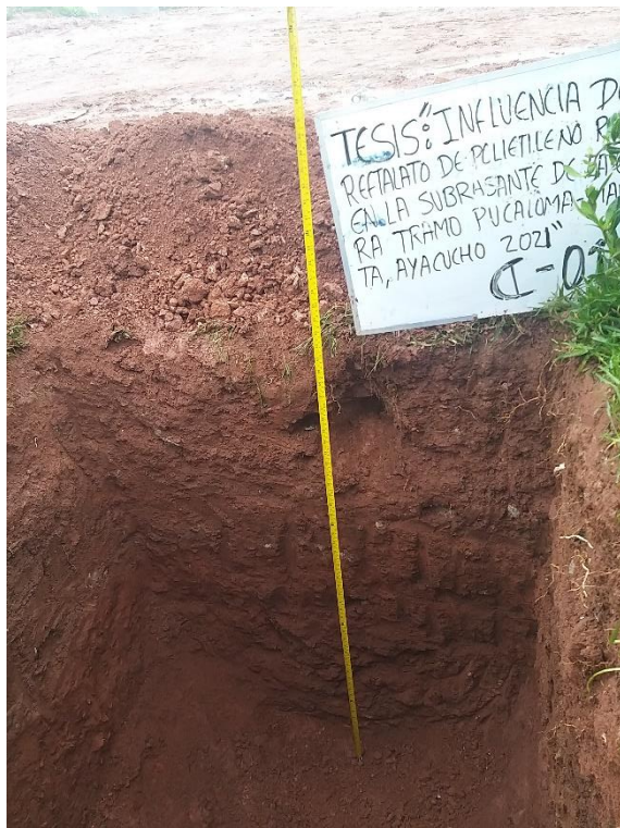
Imagen 10: Vista del perfil estratigráfico de la calicata C-01 a una profundidad de 1.50m
