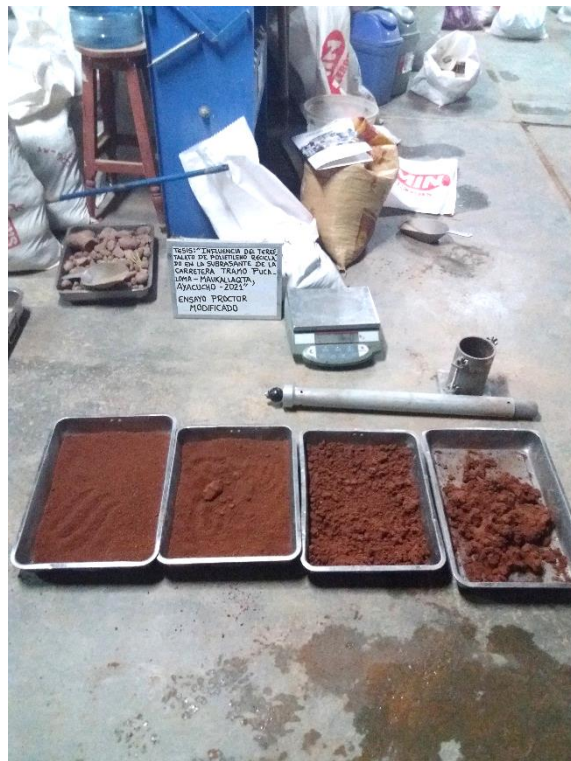
Imagen 16: Preparación de la muestra de suelo en estado natural
