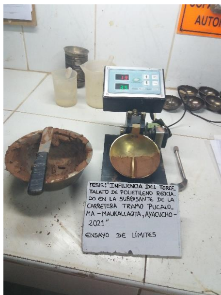
Figura 17: Vista del ensayo de límites de consistencia
