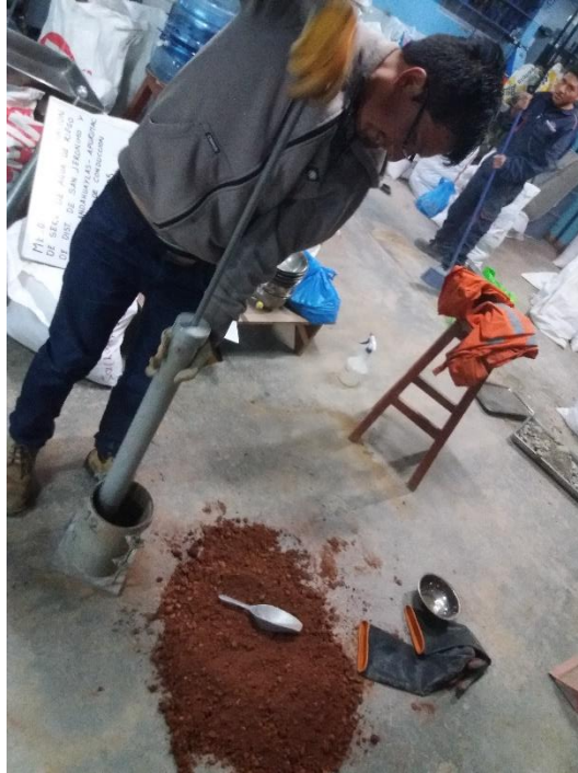
Figura 25: Vista del ensayo de proctor modificado
