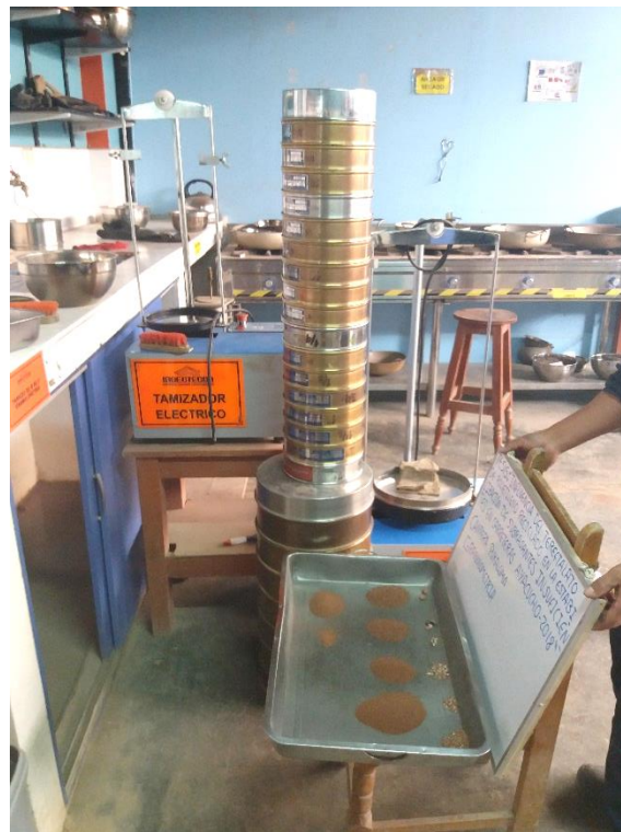
Imagen 14: Vista del ensayo de granulometría
