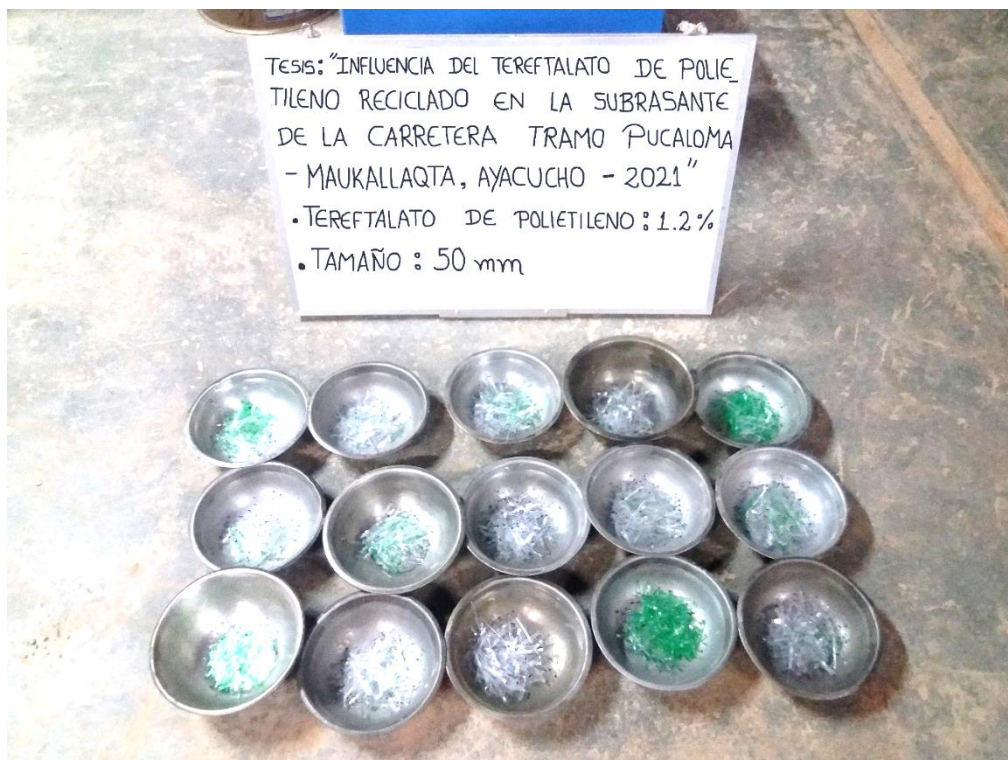
Imagen 26: Tereftalato de polietileno reciclado en porcentaje de 1.2% del peso seco de la muestra
