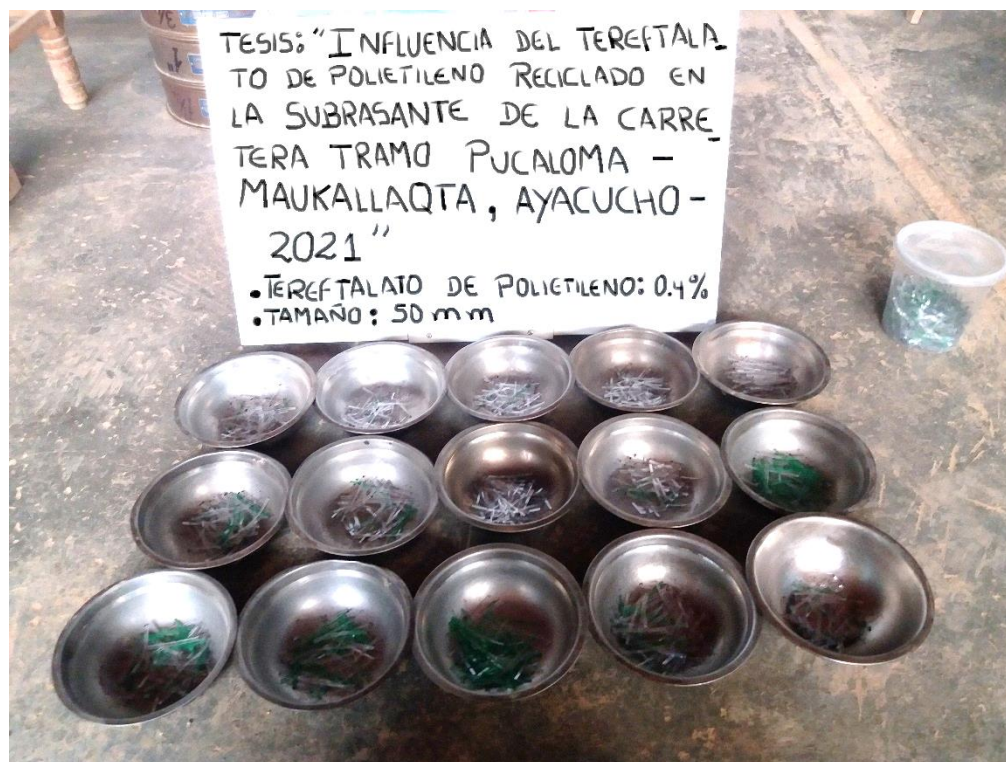
Imagen 24: Tereftalato de polietileno reciclado en porcentaje de 0.4% del peso seco de la muestra
