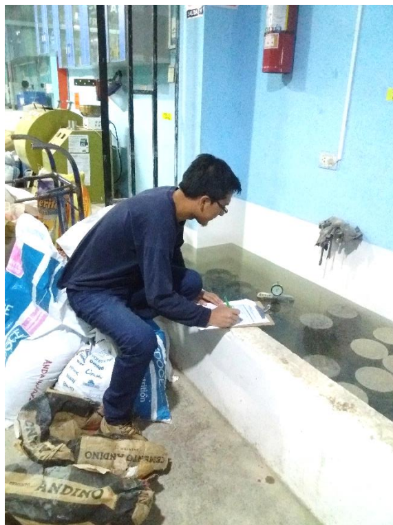
Imagen 20: Control de expansión de las muestras, sumergida en agua durante 4 días
