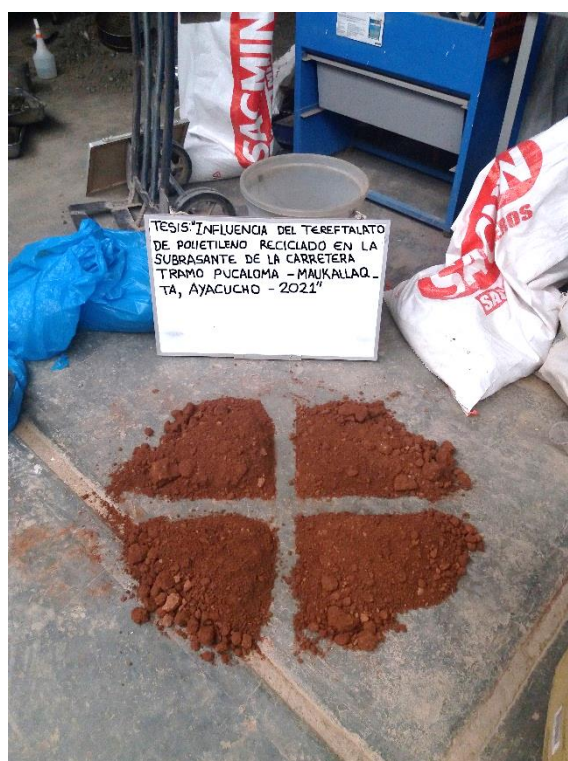
Imagen 12: Vista del cuarteo de la muestra de suelo de la calicata C-01
