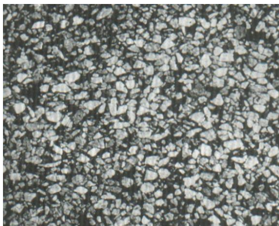
Figura 39. Pulimiento de agregados de baja severidad.
