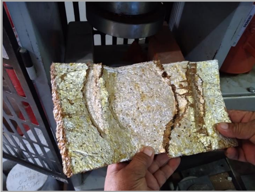
Muestra a la que midieron la resistencia a la flexión
