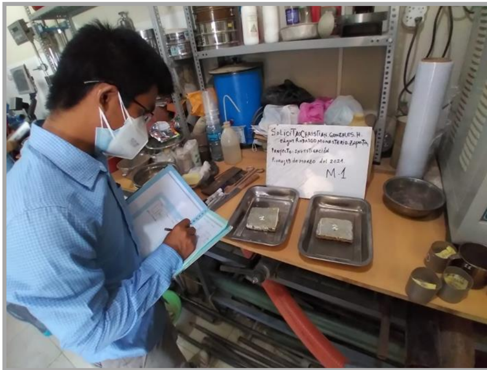
Registrando datos en medición de la absorción
