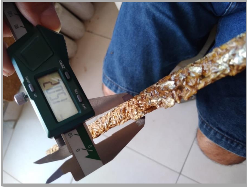
Midiendo el grosor para determinar la densidad
