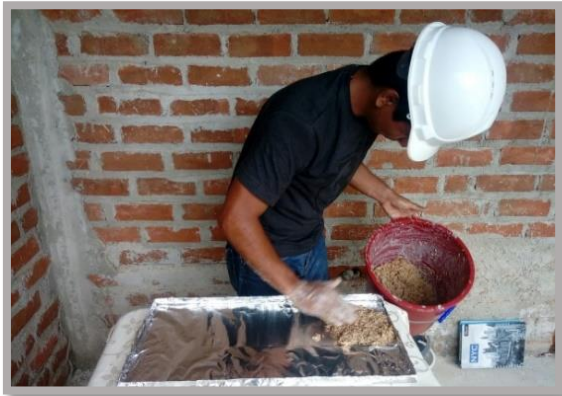
Vaciado de mezcla al molde
