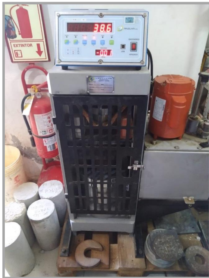
Máquina para medir la resistencia a la flexión
