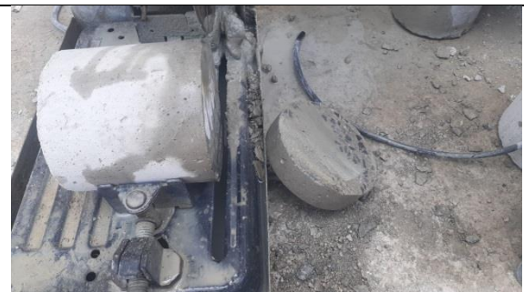
Nivelación de altura de las probetas
