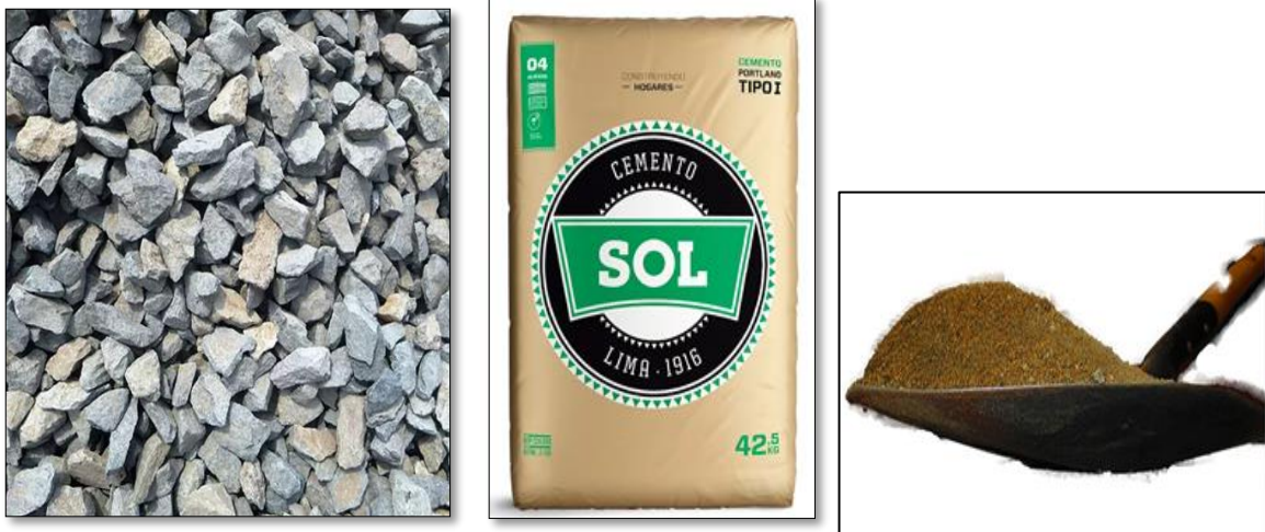
Figura 06: Agregado fino, grueso y cemento
