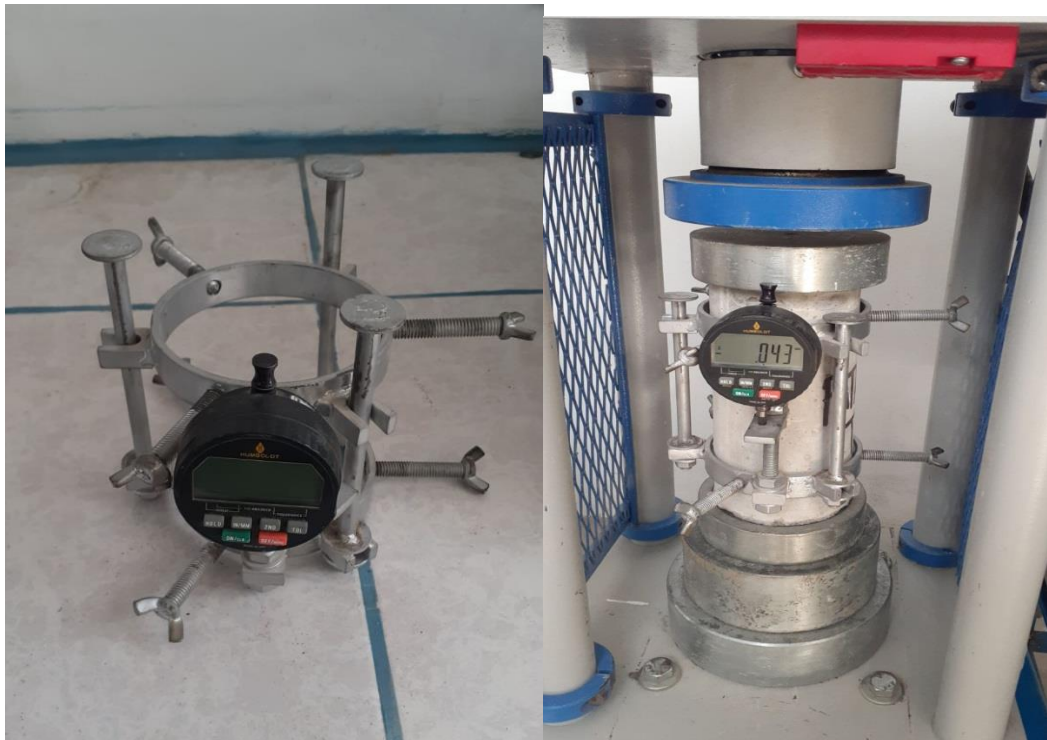
Figura 25: Ensayo de módulo de elasticidad
