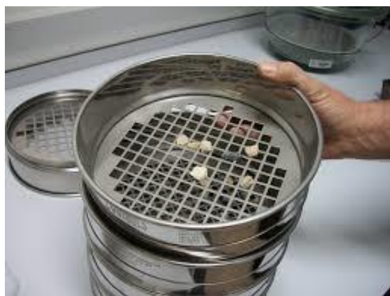
Figura 08: Tamizado del agregado grueso
