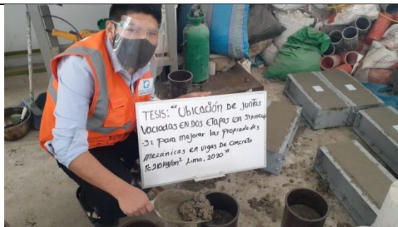
Vaciado en dos etapas de las probetas
