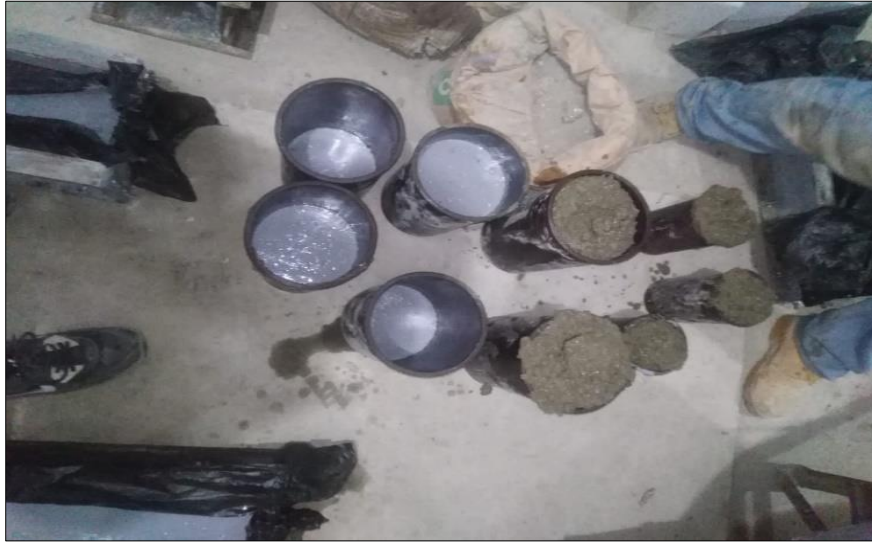
Figura 18: Aplicación del Sikadur en las probetas
