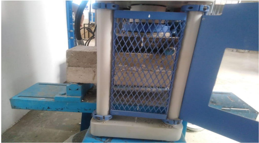
Figura 23: Ensayo a flexión (viga a 2/4 de altura)
