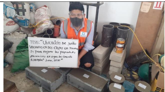
Vigas patrón vaciadas
