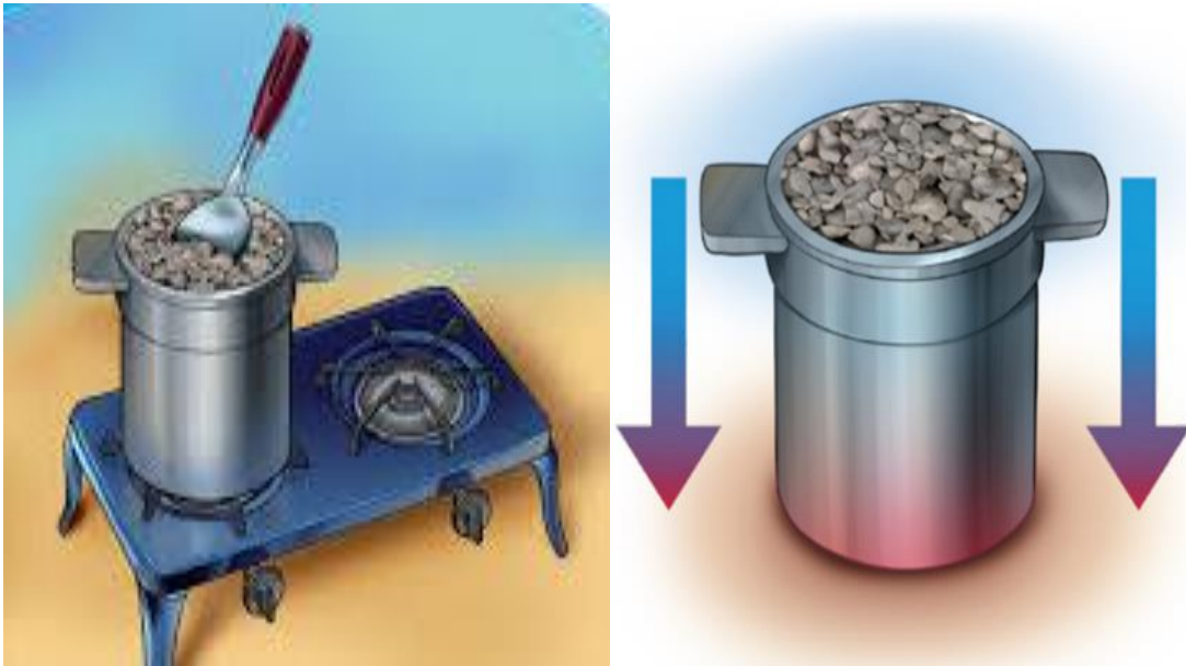
Figura 09: Ensayo de contenido de humedad de AG
