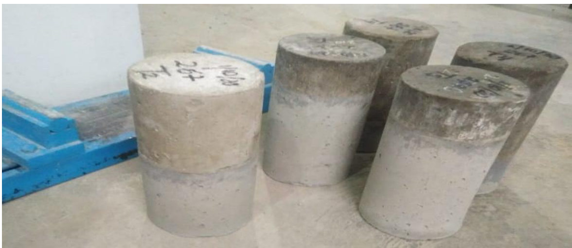
Figura 21: Probetas para el ensayo a compresión
