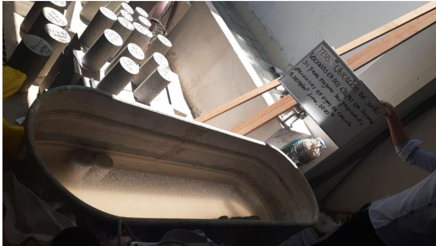
Figura 20: curado de las muestras (segunda etapa)
