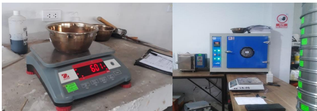
Figura 10: Ensayo de contenido de humedad AF
