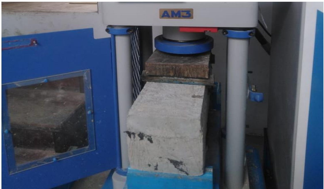
Figura 24: Ensayo a flexión de la viga monolítica
