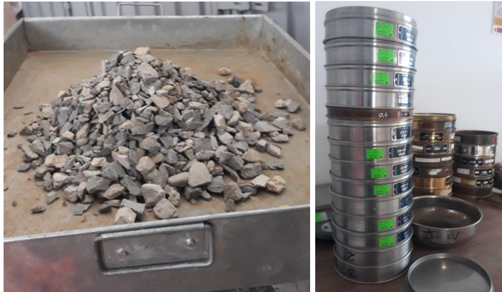
Figura 07: Distribución del agregado grueso
