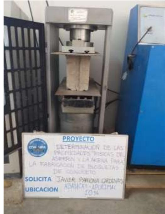
Rotura de la muestra de bloque de hormigón con 10% de adición
