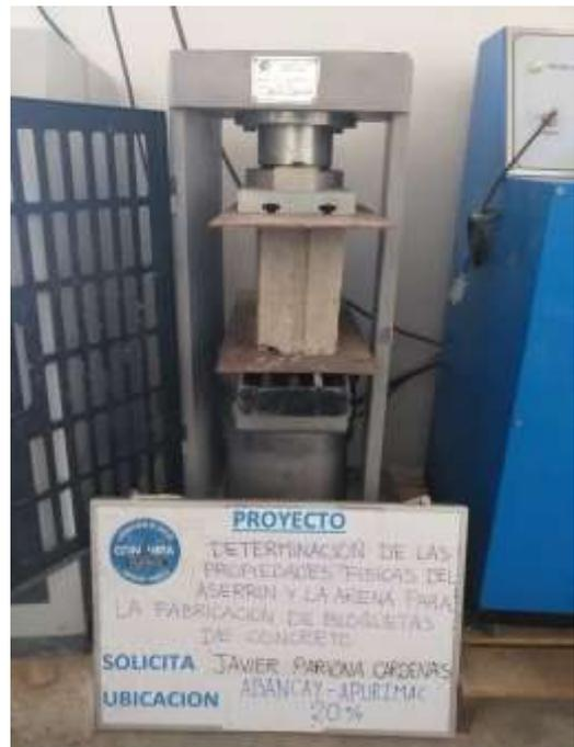
Rotura de la muestra de bloque de hormigón con 20% de adición
