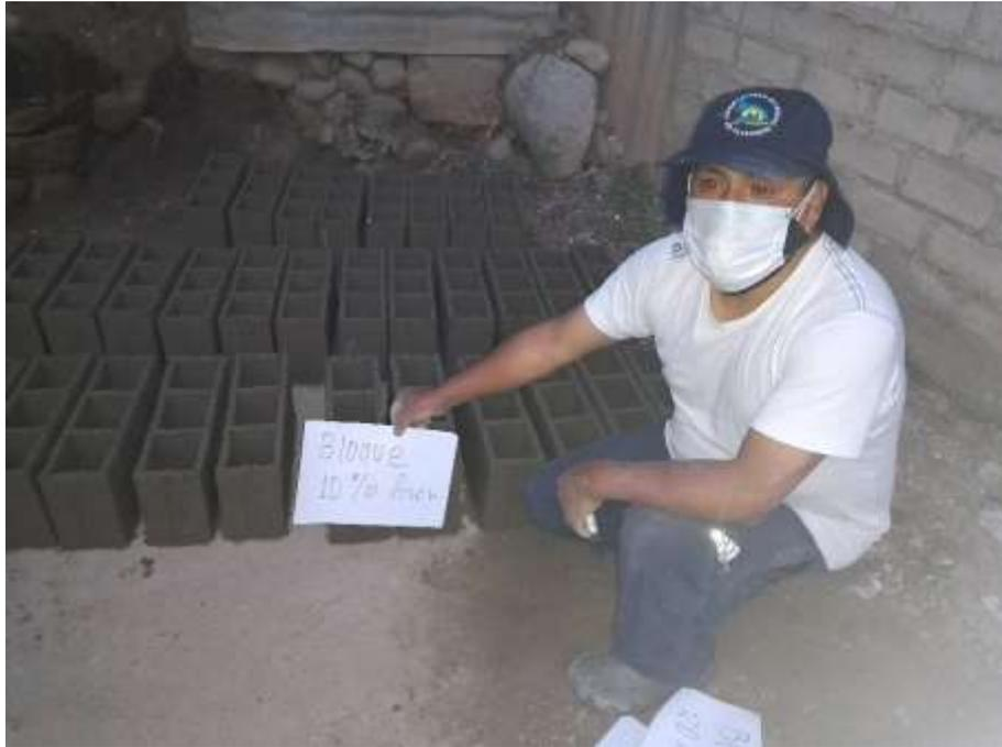
Elaboración de los bloques de concreto con adición de 10% de aserrín
