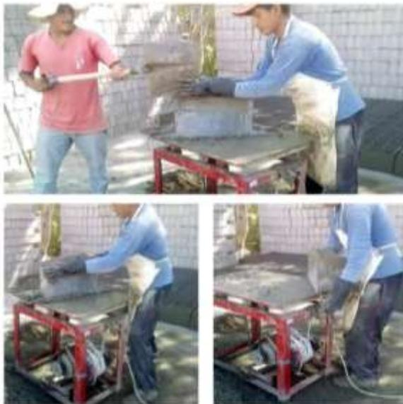
Figura 2.5. Moldeo de las unidades de concreto
