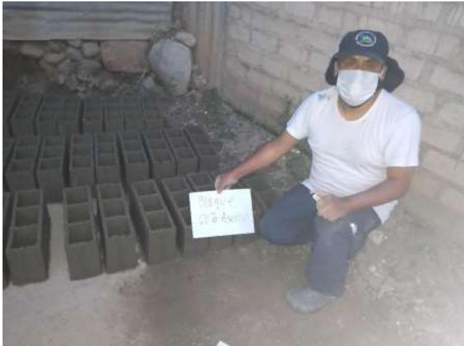
Elaboración de los bloques de concreto con adición de 20% de aserrín
