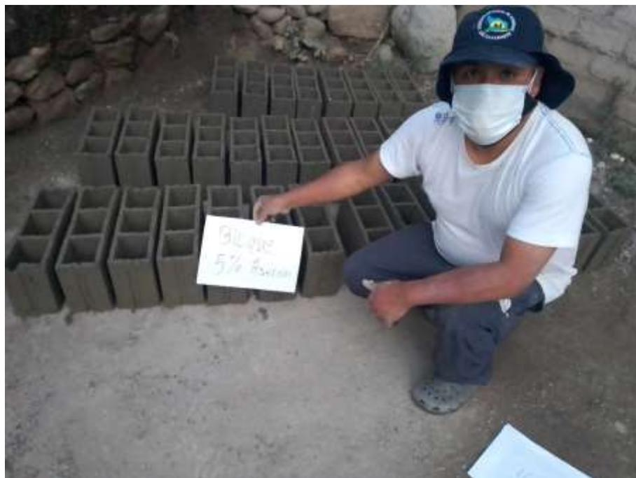
Elaboración de los bloques de concreto con adición de 5% de aserrín
