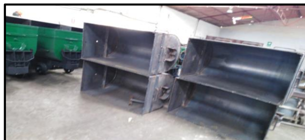
Figura 17. Limpieza mecánica de tolvas U-35
