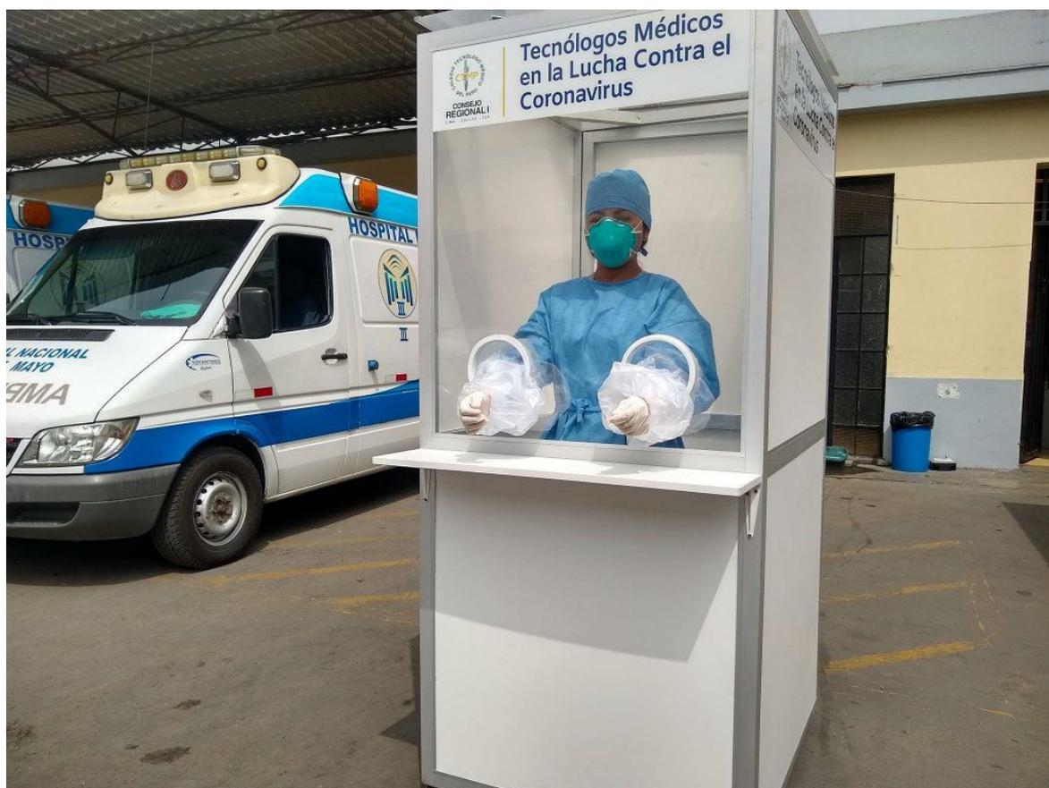
Se trata de una cabina de 2.10 metros de alto, 0.90 metros de frente y 1 metro de fondo, basada en una estructura de aluminio y panelas de policarbonato, la cual cuenta en su parte frontal con dos orificios con mangas de polietileno, mediante los cuales el personal de laboratorio podrá recoger las muestras del paciente.
