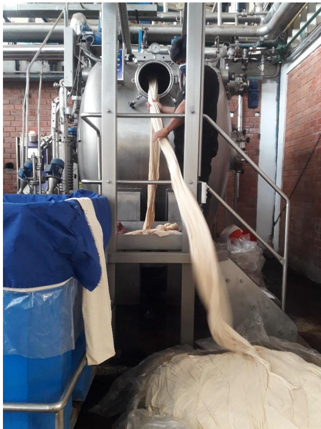
Anexo 1: Carga de tela cruda a la máquina Lab Pro 39
