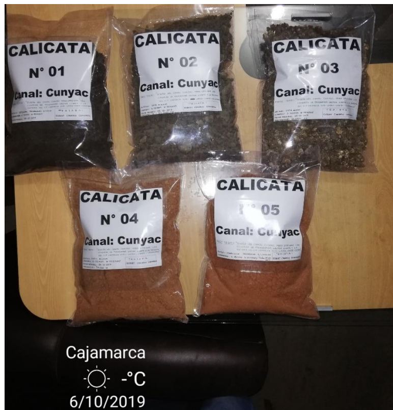
FOTO 11. Muestras de las 05 calicatas llevadas al Laboratorio de Suelos – UCV
