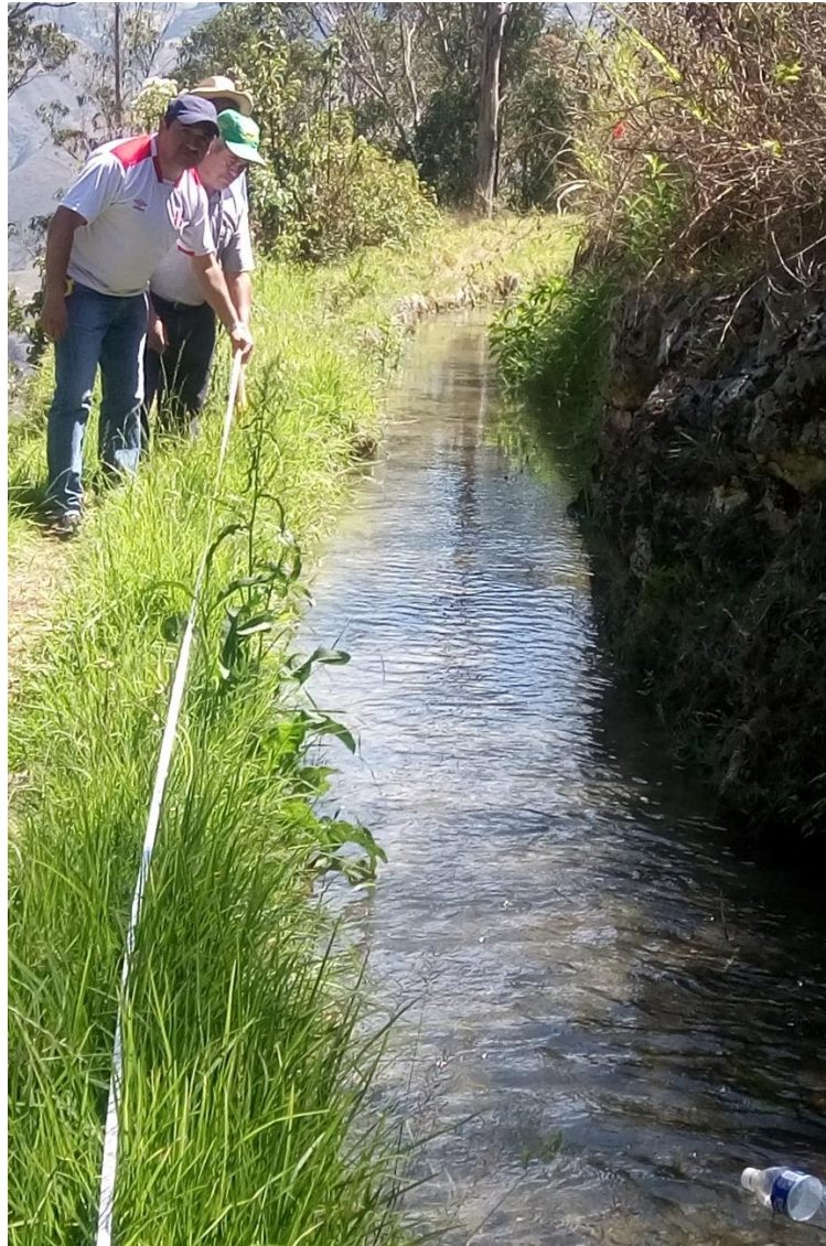
FOTO 1. Reconocimiento, Toma de medidas de la sección del Canal-Pruebas de Aforo.
