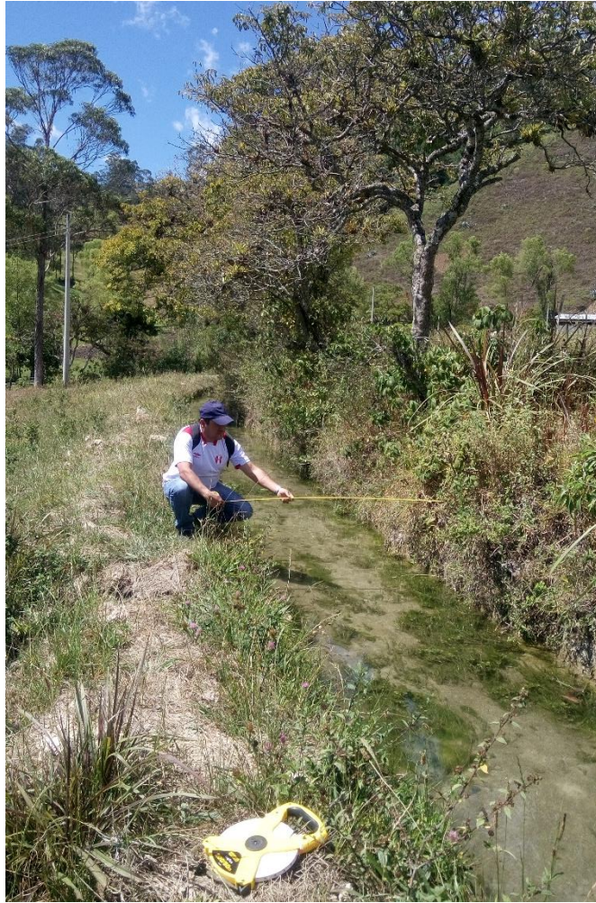
FOTO 4. Toma de medidas de la Sección del Canal.
