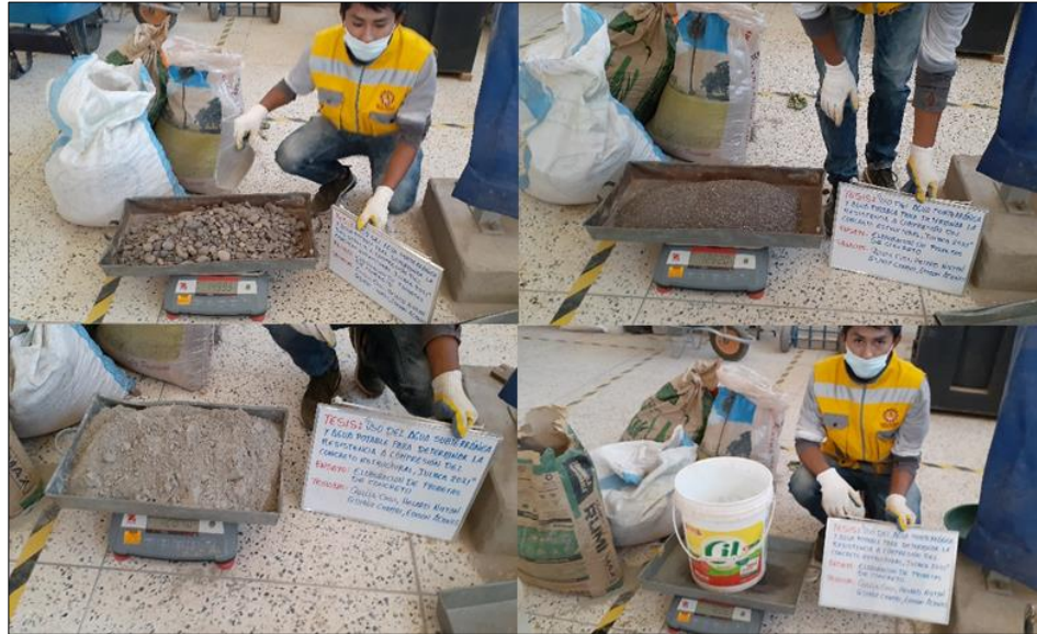
Figura 45. Proporciones para la elaboración de concreto con agua potable.
