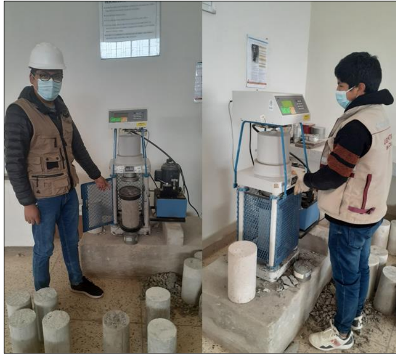
Figura 52. Ensayo de compresión de probetas cilíndricas.
