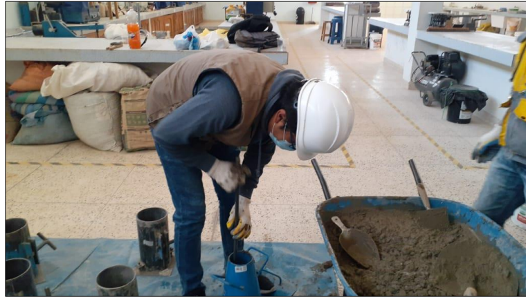
Figura 42: Slump (compactación con la varilla 25 golpes)
