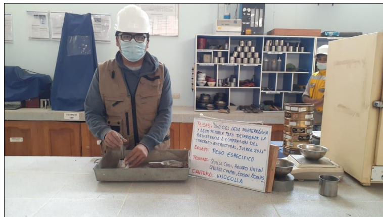
Figura 23: Ensayo de peso específico (apisonamiento con el cono truncado)
