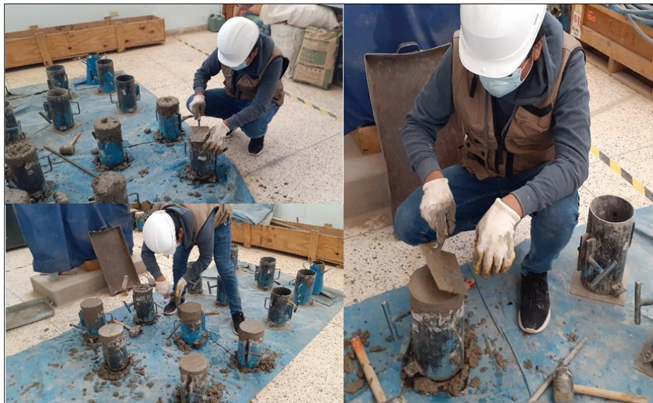
Figura 48. Enraizado y etiquetado de briquetas de concreto.
