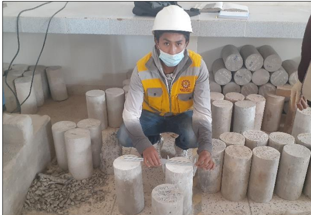
Figura 51. Toma de medición de probetas de concreto.
