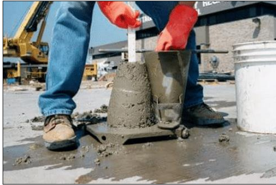
Figura 9. Slump (método para determinar trabajabilidad) Fuente: cotechno
