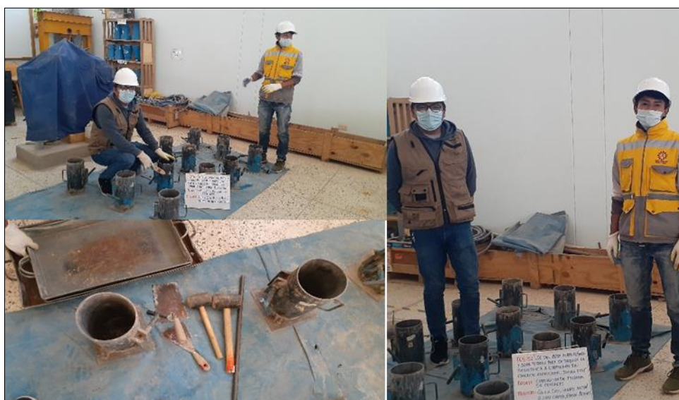
Figura 44. Preparación de los moldes y herramientas para elaboración de briquetas.
