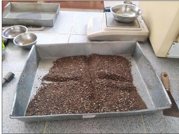
Figura 22: Ensayo peso específico (secado de la muestra).
