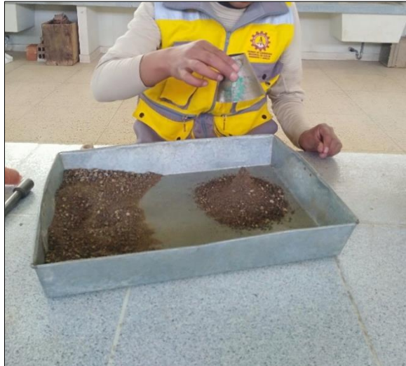
Figura 24: Ensayo de peso específico (retiro del cono)
