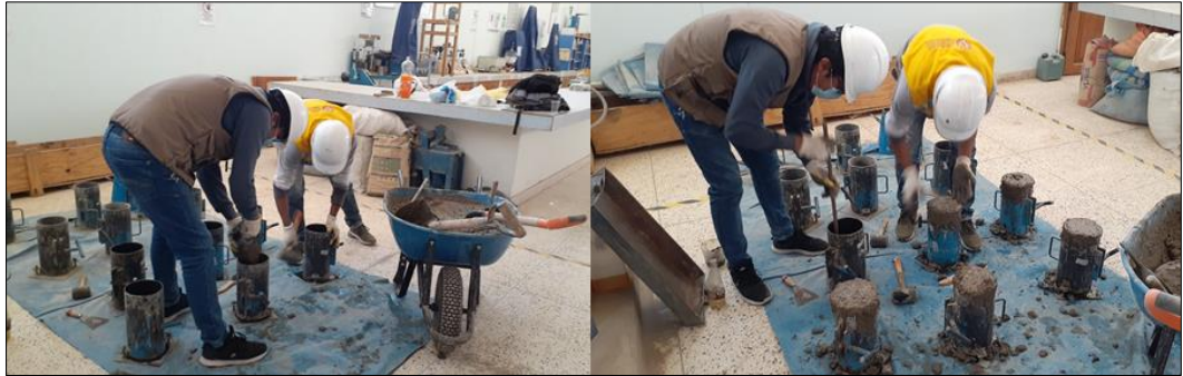
Figura 47. Elaboración de briquetas de concreto con agua subterránea y potable.
