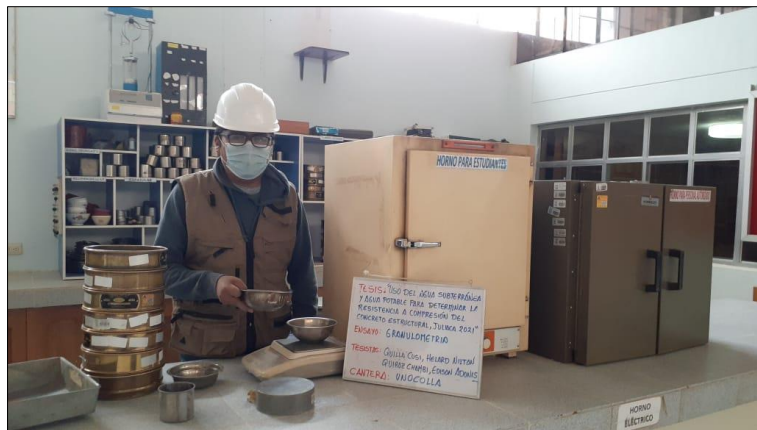
Figura 40: peso de muestra en tamiz retenido.
