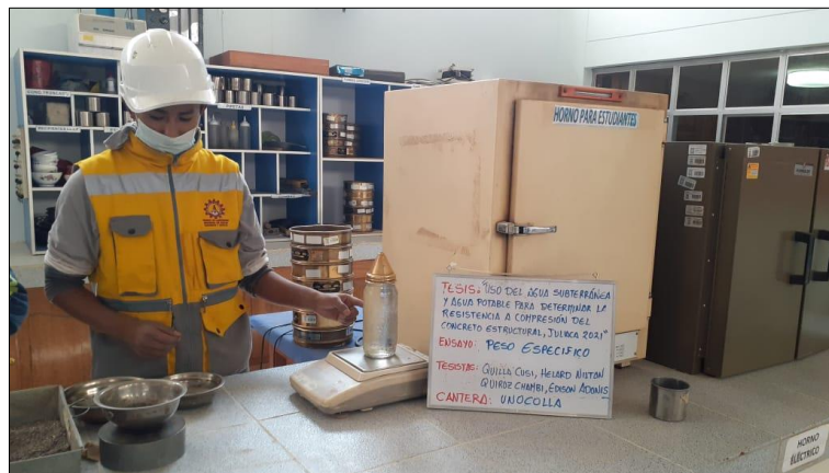
Figura 34: Ensayo de pesos específicos (peso picnómetro más agua).
