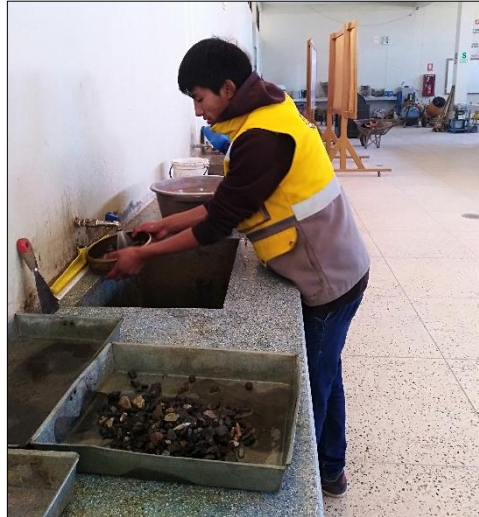
Figura 37: Ensayo de análisis granulométrico lavado da agregado grueso.
