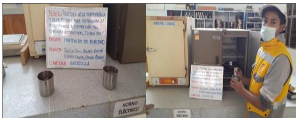
Figura 17: Ensayo de contenido de humedad, muestra puesta al horno.
