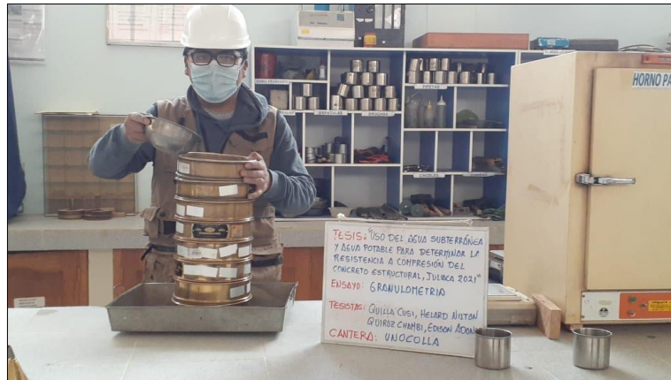
Figura 39: Ensayo de análisis granulométrico (tamizado de la muestra).
