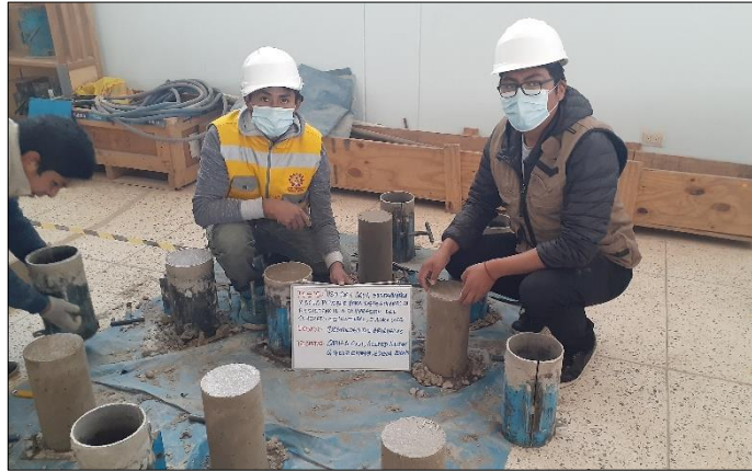
Figura 49. Desmóldelo de briquetas.
