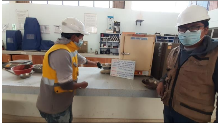
Figura 31: Ensayo de pesos específicos (peso de recipiente más muestra seca).
