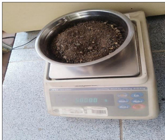
Figura 25: Ensayo de pesos específicos (peso de la muestra SSS 500g).
