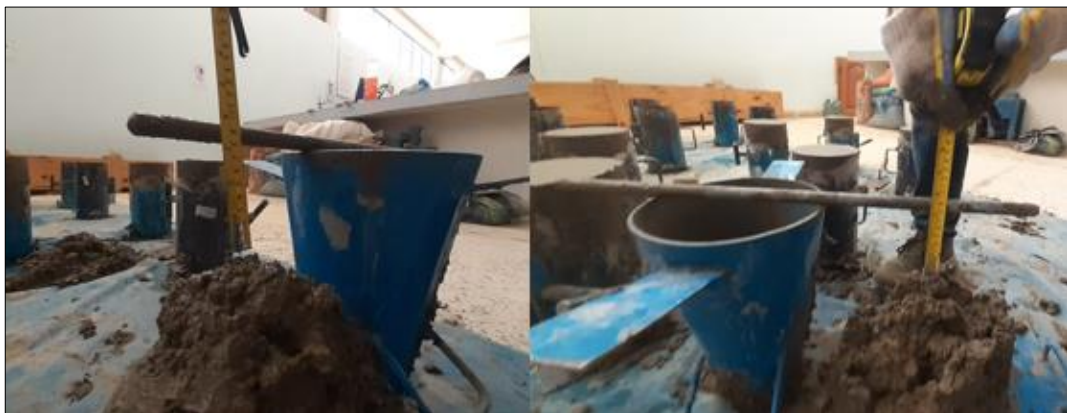
Figura 43. Elaboración del ensayo Slump
