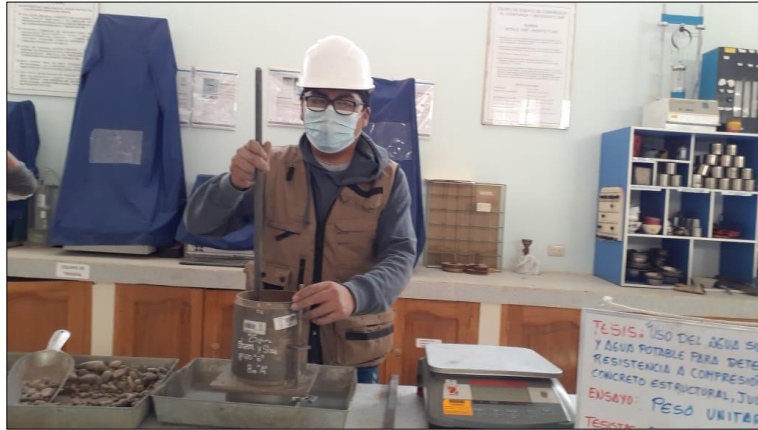
Figura 20: Ensayo de peso unitario (compactación de la muestra)
