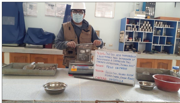
Figura 21: Ensayo de pesos unitarios (enrasamiento de muestra).
