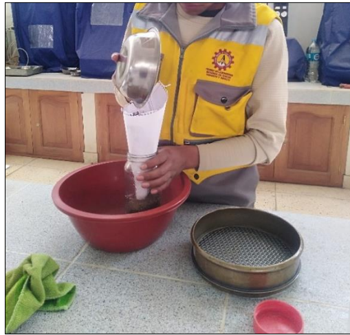
Figura 27: Ensayo de pesos específicos (llenado de la muestra SSS)
