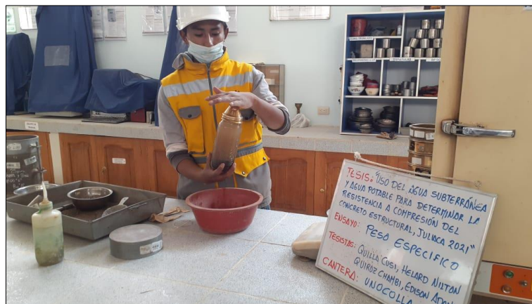
Figura 28: Ensayo de peso específico (agitación del picnómetro).
