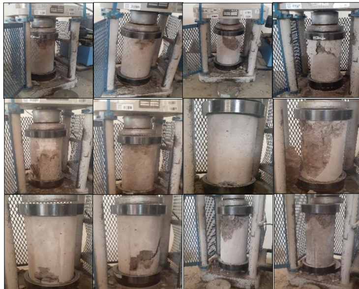
Figura 53. Tipos de fallas obtenidas después del ensayo de compresión.
