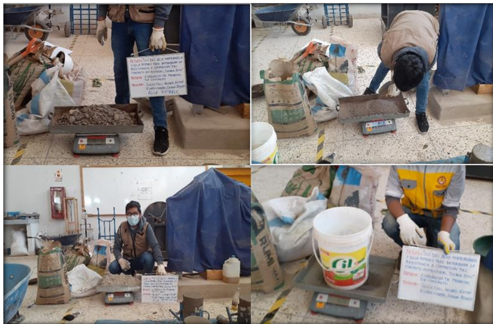
Figura 46. Proporciones para la elaboración de concreto con agua subterránea.
