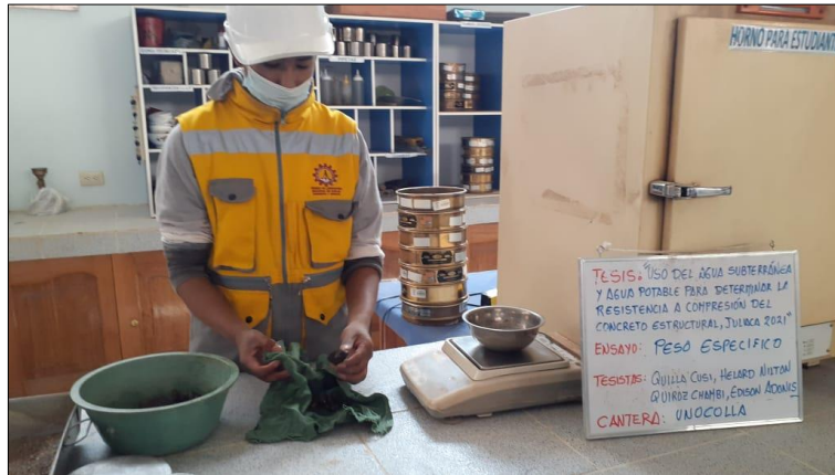
Figura 33: Ensayo de pesos específicos (peso saturado superficialmente seco).
