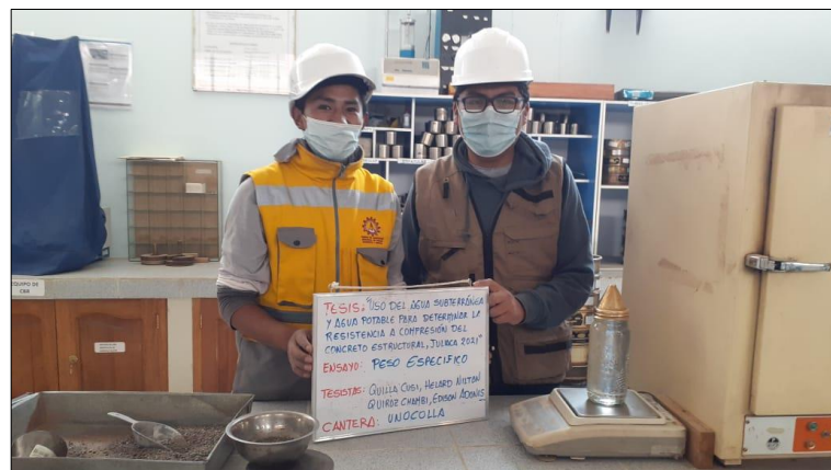
Figura 26: Ensayo de pesos específicos (peso de picnómetro más agua)
