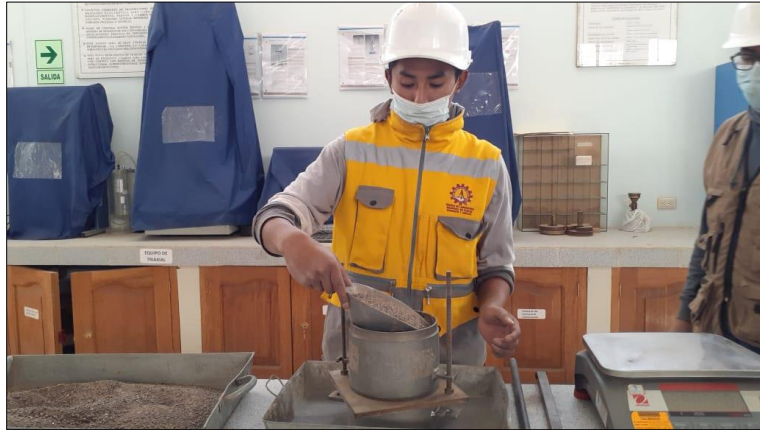
Figura 18: Ensayo de pesos unitarios, caída de la muestra al molde.
