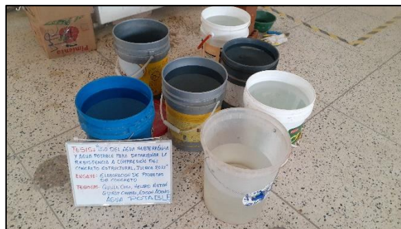
Figura 15. Agua potable para la elaboración de probetas de concreto.
