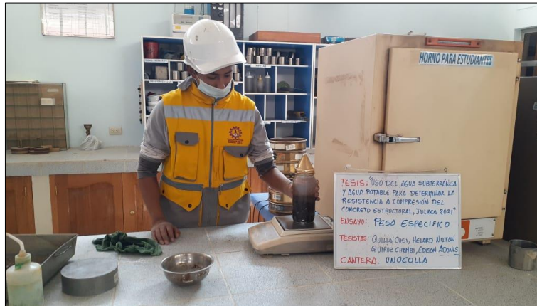
Figura 35: Ensayos de pesos específicos (peso de picnómetro con agua más muestra húmeda).
