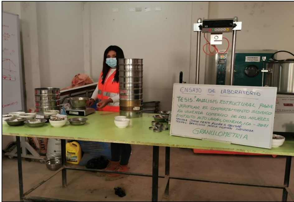
Fotografía 3. Peso de la muestra en balanza electrónica
