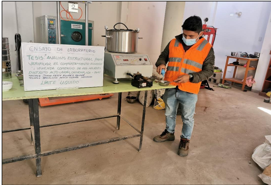
Fotografía 7. Para el límite líquido, se amasa con la cantidad de agua necesaria, según lo indicado en la norma
