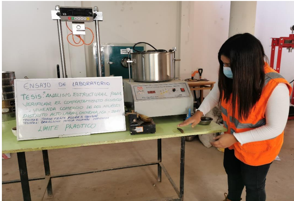
Fotografía 9. Limite plástico, se realiza con el suelo que pasa el tamiz #40, procediendo a hacer amasado de la muestra hasta conseguir cilindros de 3mm
