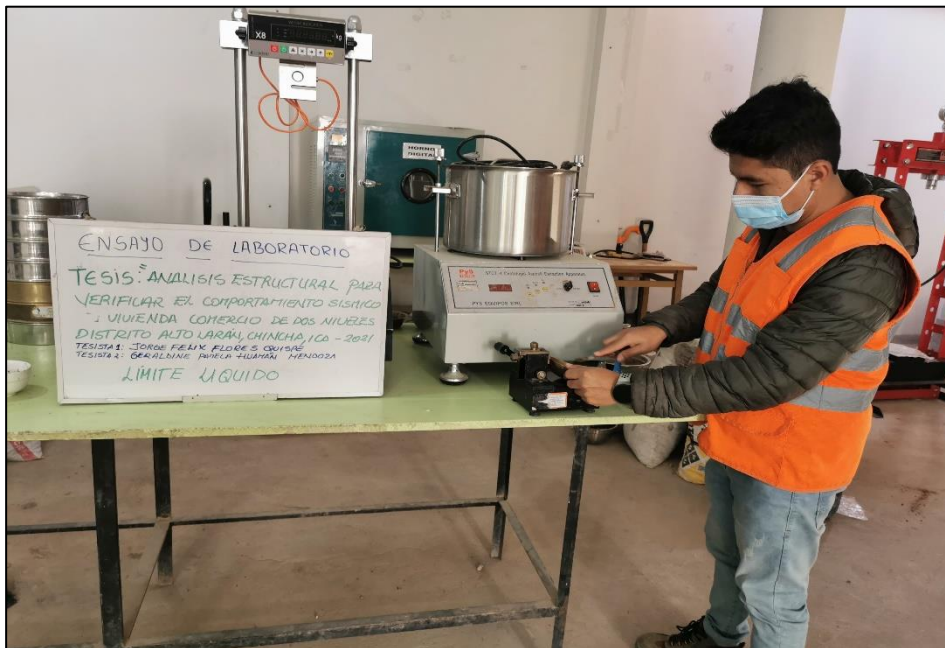
Fotografía 8. Se aplica la muestra en el aparato de Casagandre, luego se realiza una ranura al centro, para posteriormente realizar 25 golpes hasta que las paredes se unan en el fondo.
