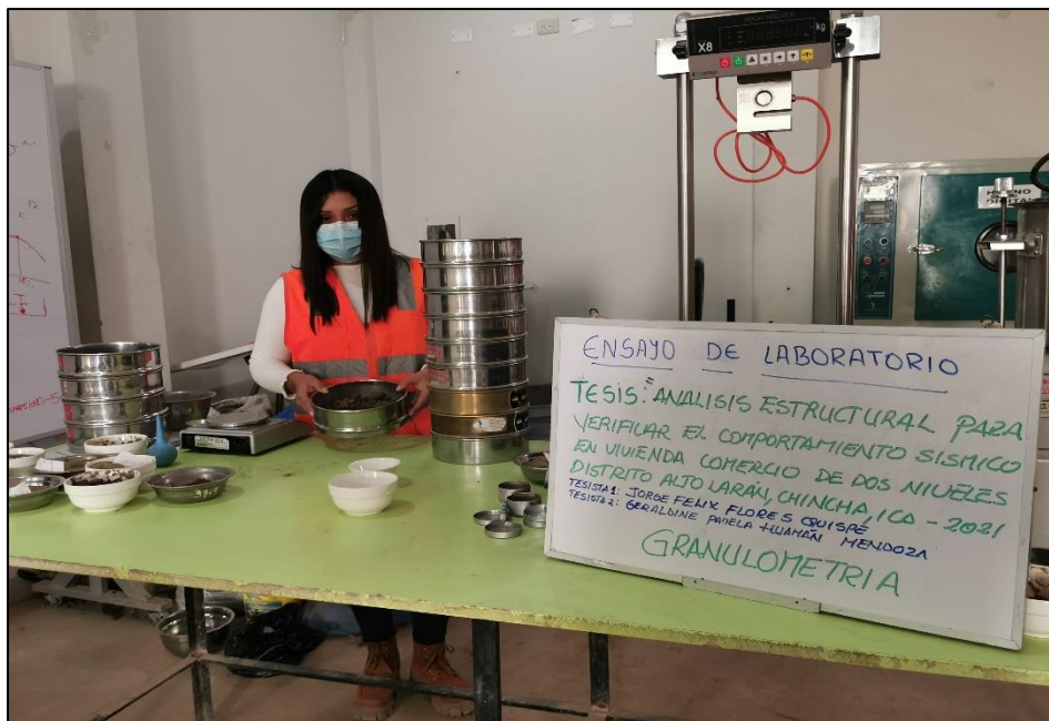
Fotografía 6. Se retira los tamices y se pesa por separado de cada tamiz retenido.
