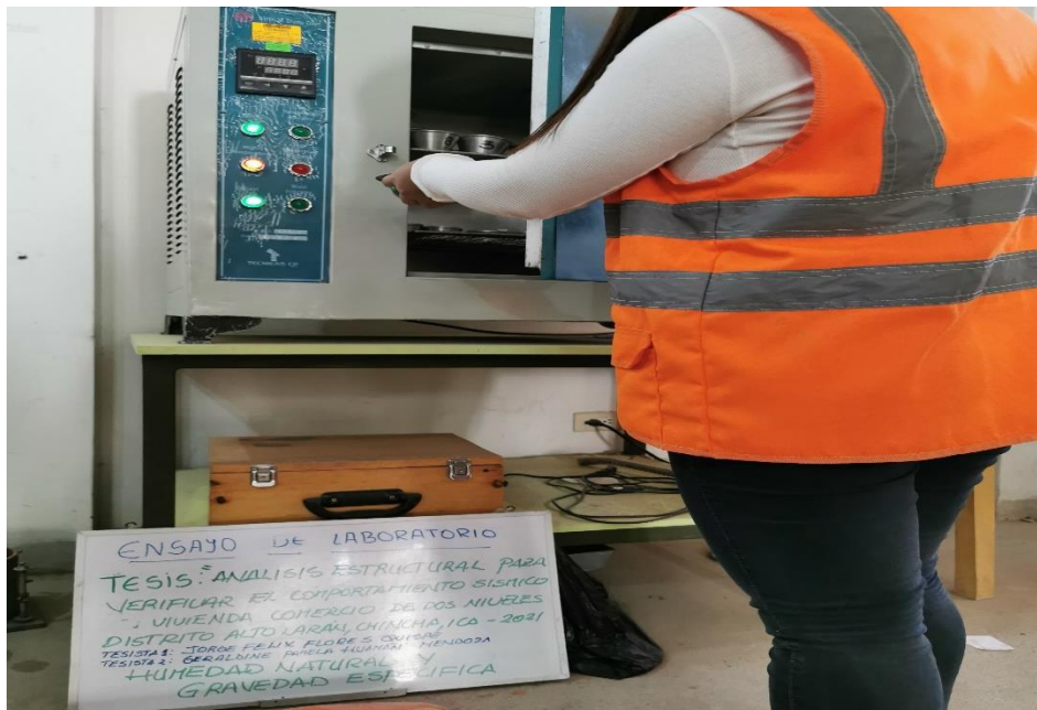
Fotografía 10. Una vez pesado en la balanza electrónica, se procede a llevar al horno y se vuelve a pesar.
