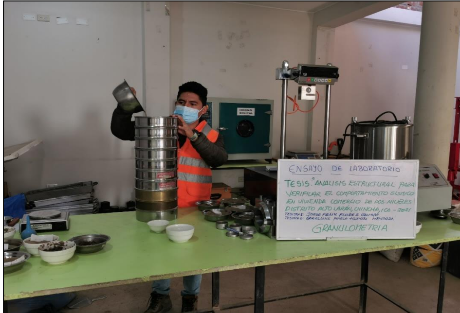
Fotografía 4. Vertido de la muestra en la columna de tamices
