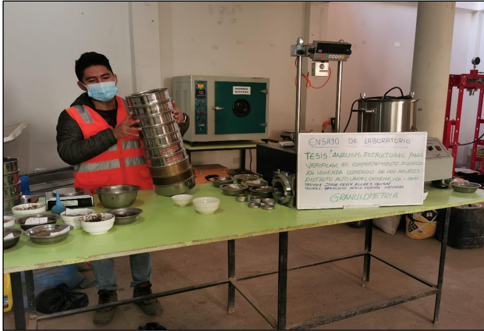
Fotografía 5. Zarandeo y/o agitación manual de la columna de tamices.
