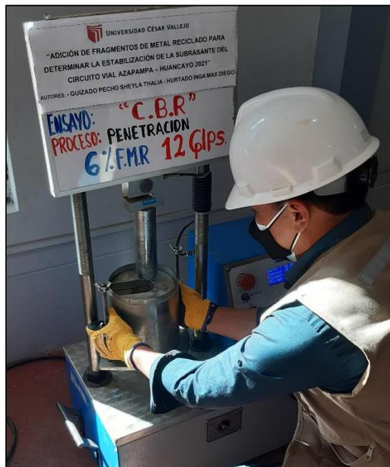
**Figura 47:** Penetración con el 6% de FMR – 12 golpes.
