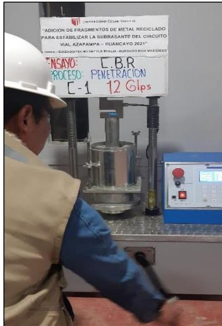
**Figura 36:** Penetración del espécimen - 12 golpes
