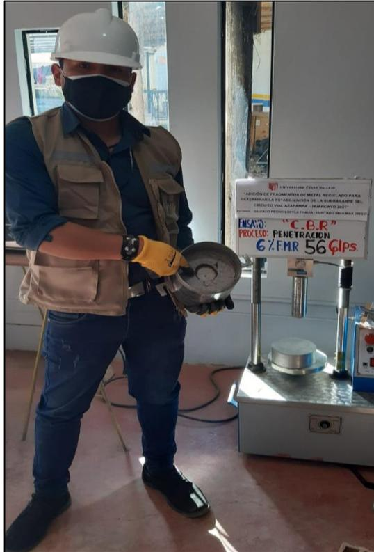
**Figura 50:** Espécimen penetrado con 6% de FMR.
