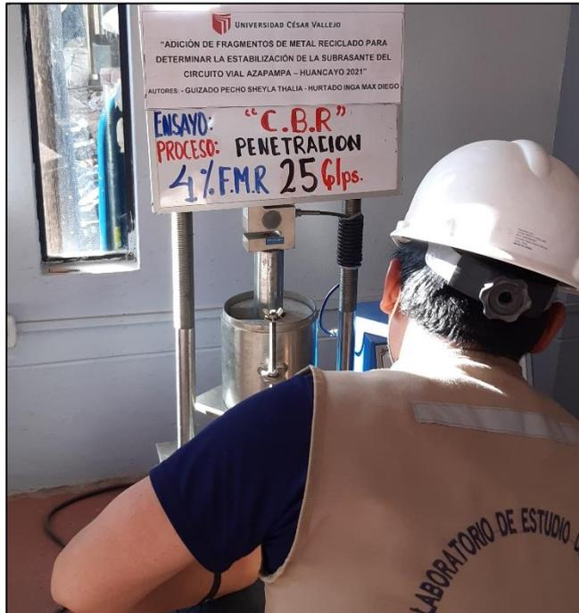
**Figura 42:** Penetración con el 4% de FMR – 25 golpes.
