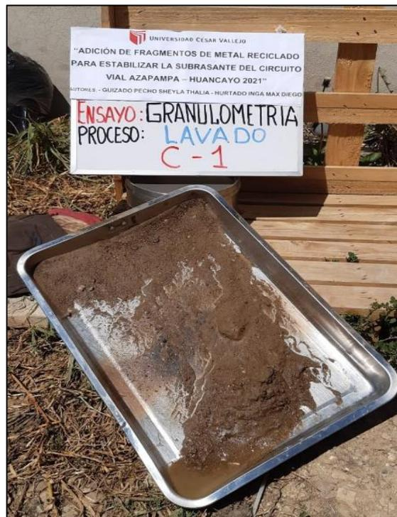
**Figura 23:** Proceso de lavado (después).
