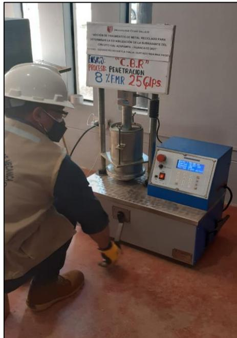
**Figura 54:** Penetración con el 8% de FMR - 25 golpes.
