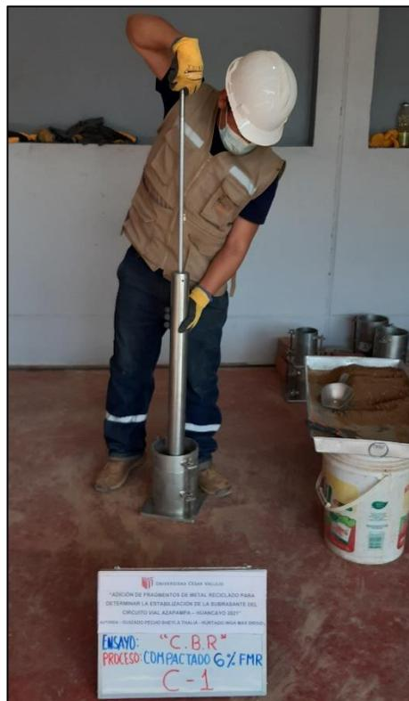
**Figura 33:** Compactado con el 6% de FMR.
