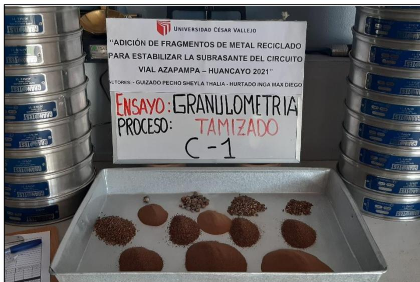
**Figura 12:** Tamizado de la muestra patrón.
