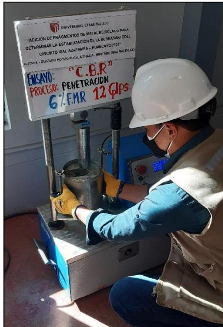
**Figura 15:** Colocación del molde con espécimen para CBR.
