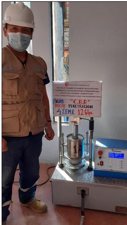
**Figura 41:** Penetración con el 4% de FMR - 12 golpes.
