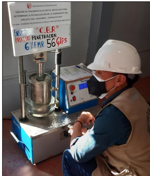
**Figura 49:** Penetración con el 6% de FMR - 56 golpes.
