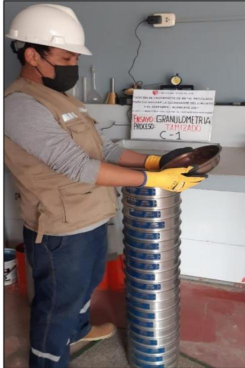
**Figura 24:** Proceso de tamizado.
