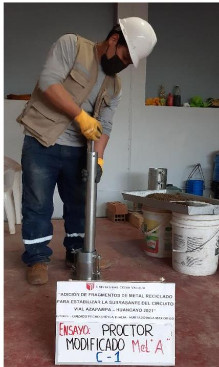
**Figura 27:** Proceso de compactado muestra patrón.
