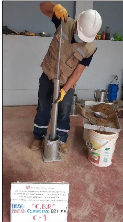
**Figura 52:** Compactado – CBR con el 8% de FMR.
