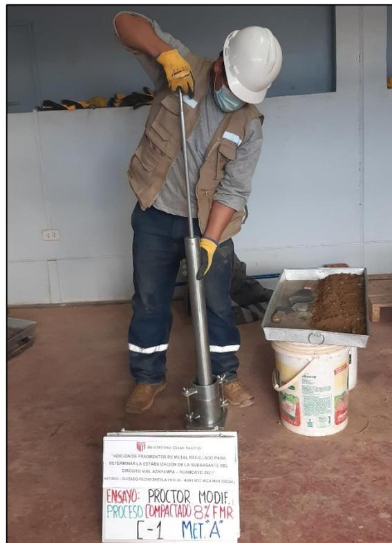
**Figura 35:** Compactado con el 8% de FMR.
