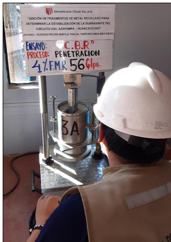
**Figura 43:** Penetración con el 4% FMR – 56 golpes.
