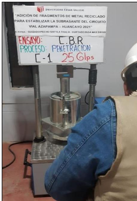
**Figura 37:** Penetración del espécimen - 25 golpes
