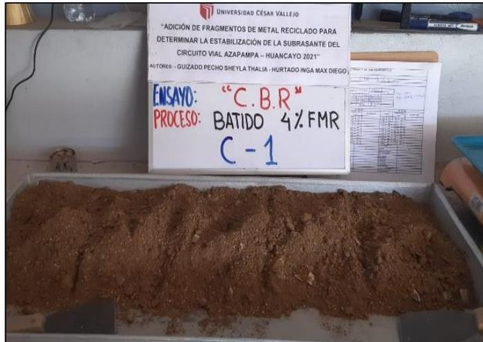
**Figura 40:** Batido de material con 4% de FMR.
