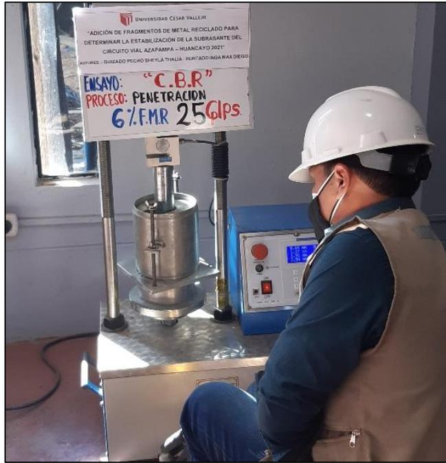
**Figura 48:** Penetración con el 6% de FMR - 25 golpes.
