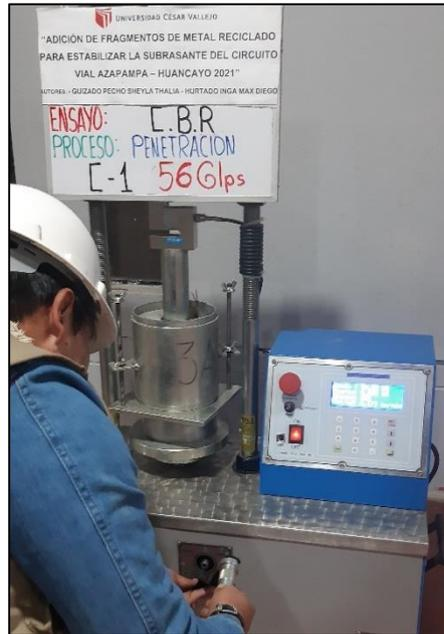
**Figura 38:** Penetración del espécimen – 56 golpes.
