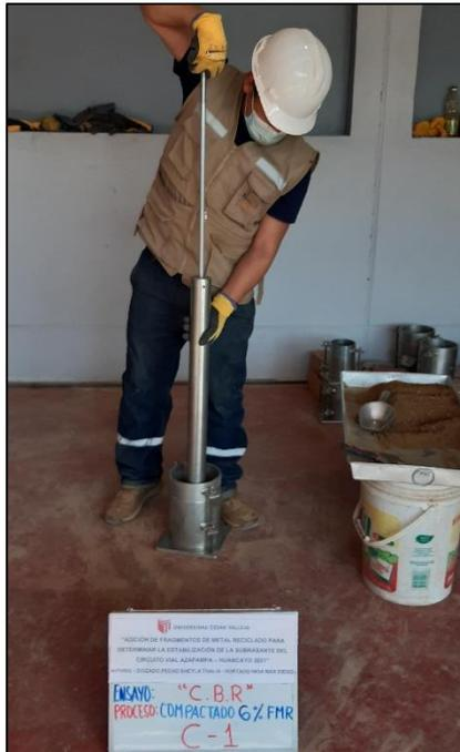
**Figura 46:** Compactado - CBR con el 6% de FMR.
