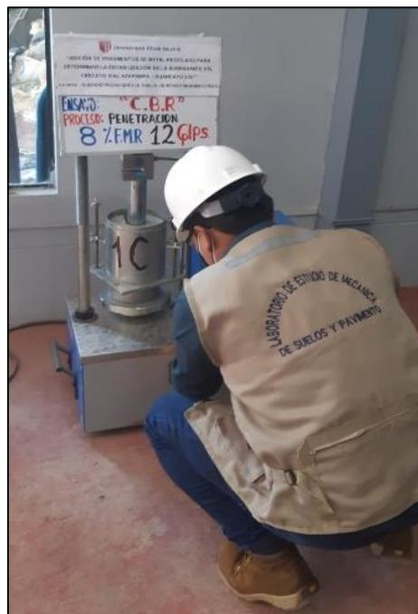
**Figura 53:** Penetración con el 8% de FMR - 12 golpes.
