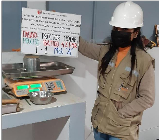
**Figura 30:** Peso del espécimen con el 4% de FMR.
