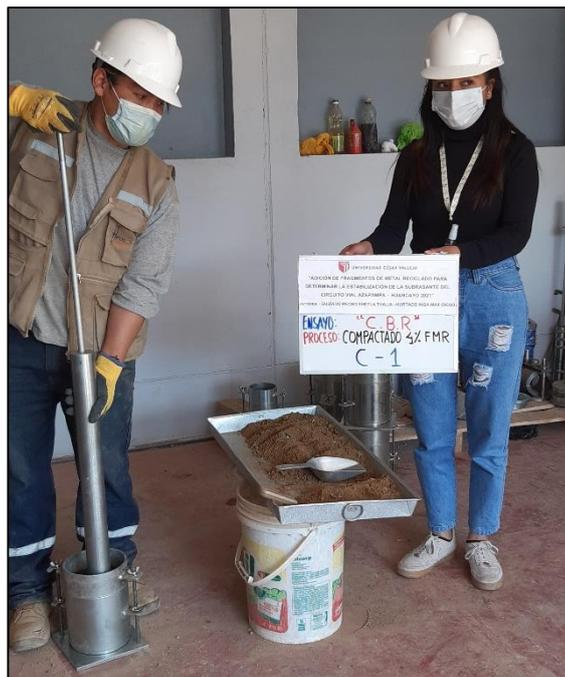
**Figura 31:** Compactado del espécimen con el 4% de FMR.
