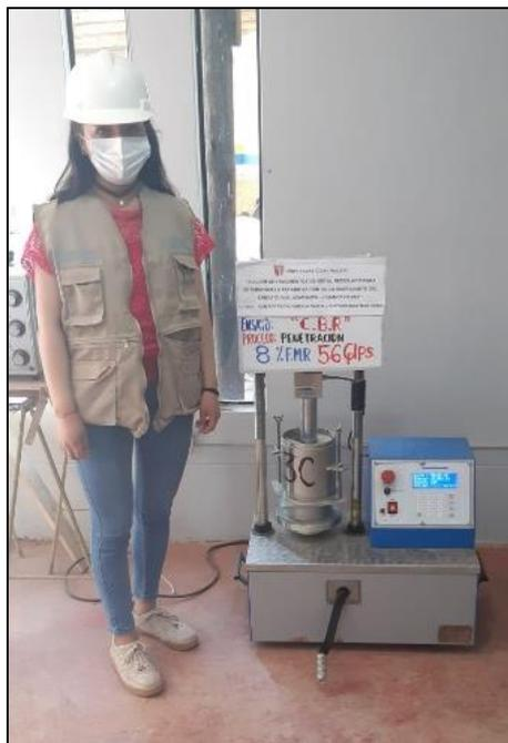
**Figura 55:** Penetración con el 8% de FMR - 56 golpes.
