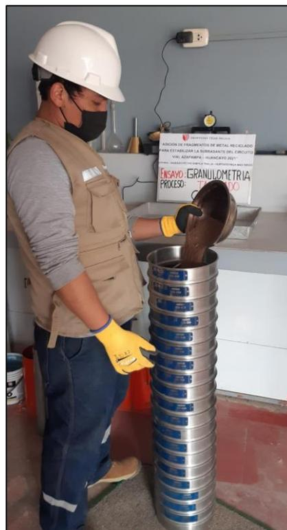
**Figura 7:** Tamizado de muestra de suelo.
