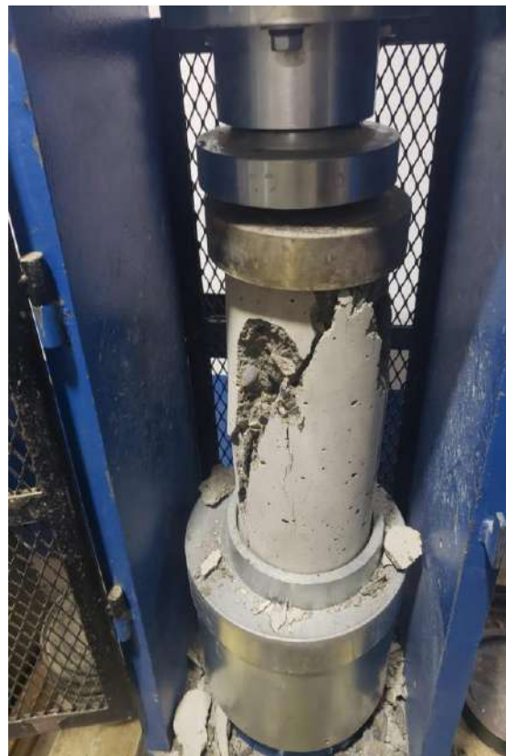
Rotura de Probeta a 14 días f'c=280 \text{ kg/cm}^2
