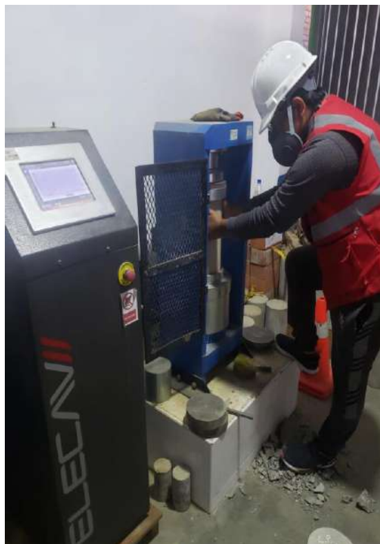
Rotura de Probeta a 14 días
