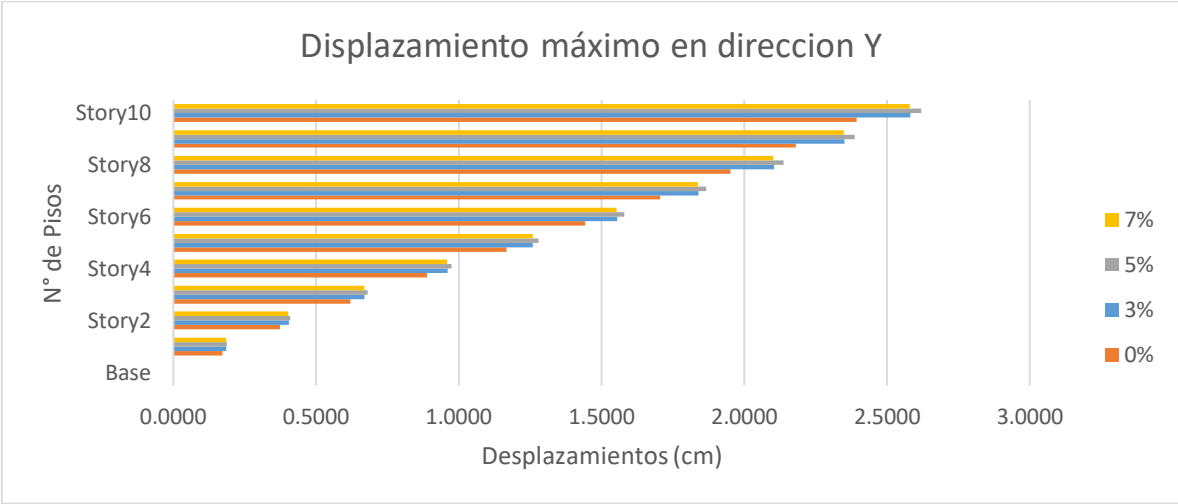
Gráfico 18: Comparación de desplazamiento máximo por sismo estático Y en estructura de 10 niveles.
