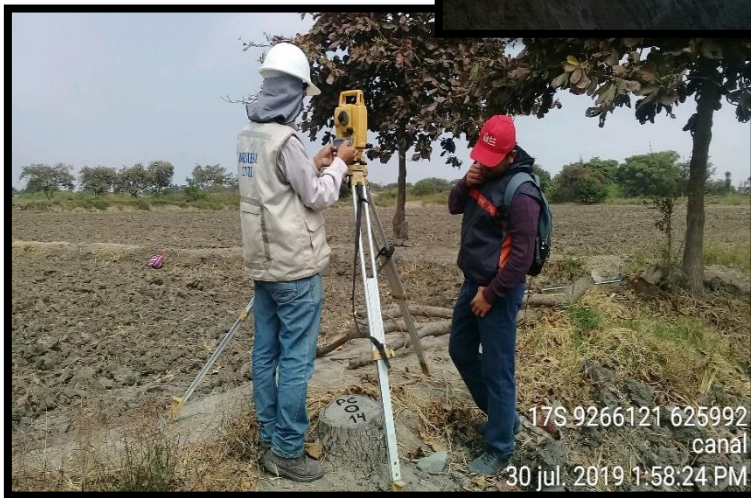
Figura 10: Punto de Control E-14 (Instalación del Equipo)
