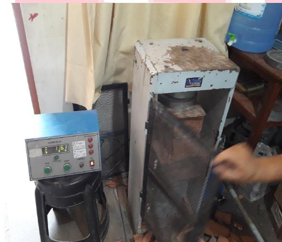
Fig E. Ensayo a compresión axial pilas de albañilería vivienda analizada.
