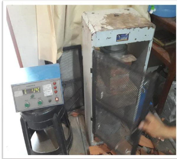
Fig D. Ensayo de pilas de albañilería.
