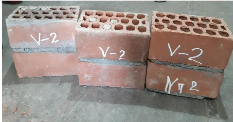
Fig D. Pilas de albañilería vivienda de 2 niveles (mismo espesor de juntas y tipo de unidad de albañilería).
