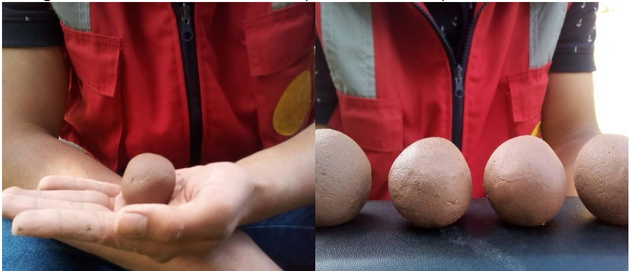
Figura 5. Conformación de las bolitas para determinar la presencia de arcilla.
