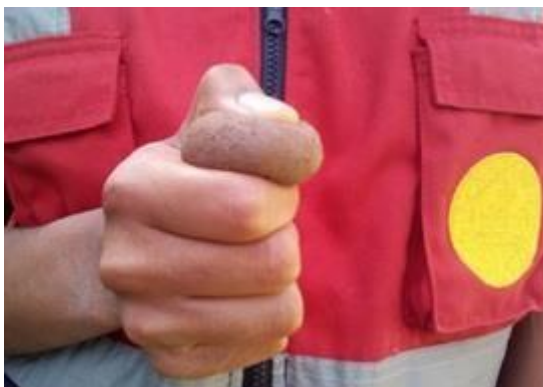
Figura 28 Aplastamiento de las bolitas de tierra
