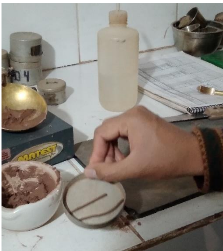
Figura 39 Separación de los bastoncillos para ser pesados
