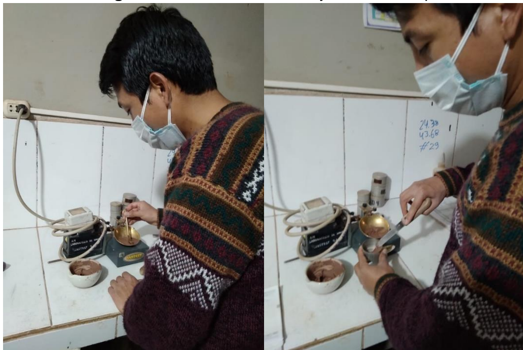
Figura 16. Realizando el ensayo del límite líquido.
