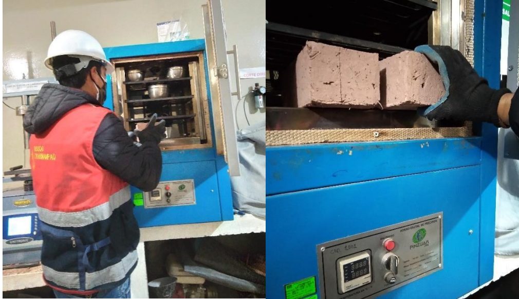
Figura 26. Secado del adobe para el ensayo de absorción.
