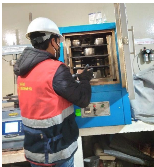
Figura 49 Secado de los ladrillos en el horno
