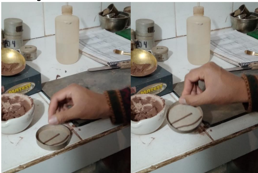
Figura 18. Colocación de los bastoncillos en las cazuelas.
