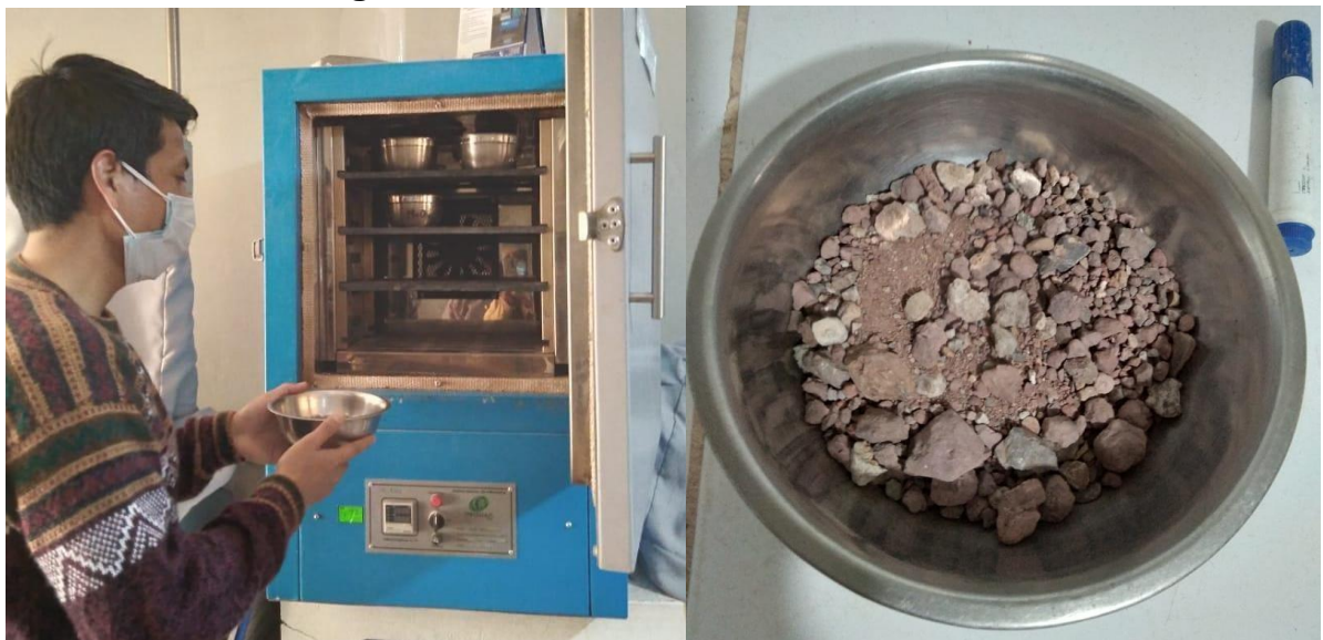
Figura 10. Secado de la muestra en el horno.
