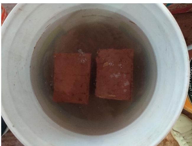
Figura 65 Inmersión de las muestras para realizar el ensayo de absorción.
