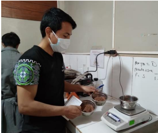
Figura 32 Registro del peso del suelo húmedo y dividido en tres cazuelas.
