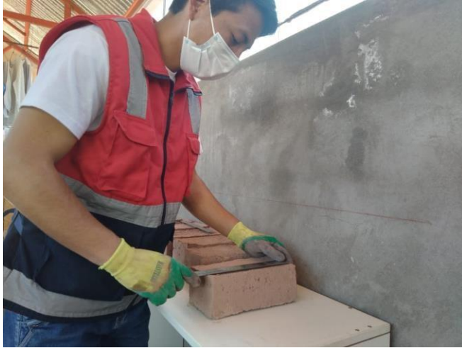
Figura 47 Medición de las dimensiones de cada bloque.
