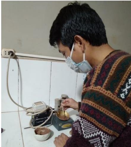
Figura 36 Separación de la muestra usando el ranurador
