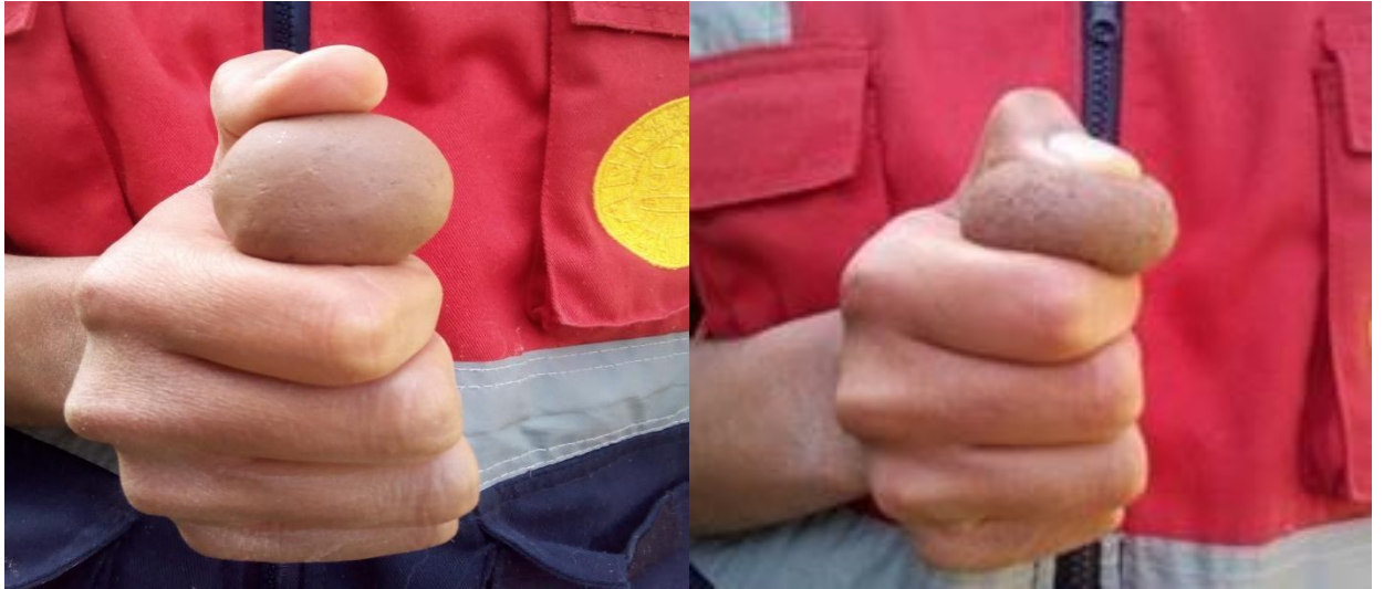
Figura 6. Prueba de la presencia de arcilla.
