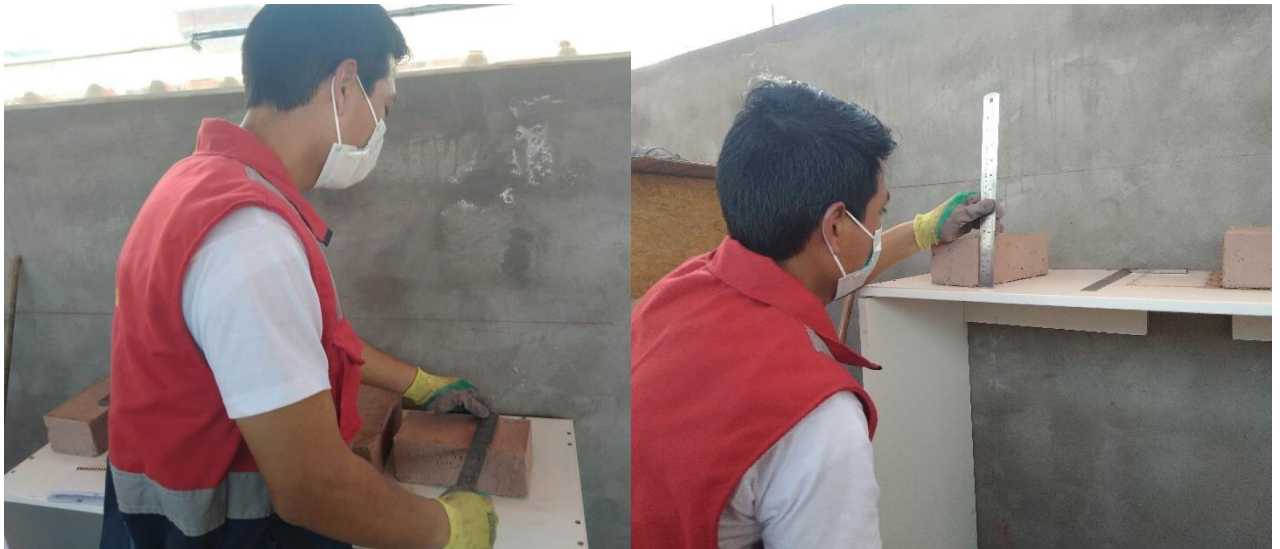
Fuente: Elaboración propia (2021) Figura 24. Medición de las dimensiones para el ensayo de Variación dimensional.
