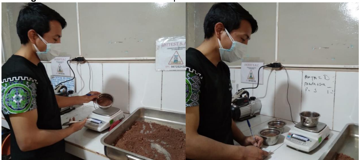
Figura 13. Pesado de las muestras para determinar el contenido de humedad.
