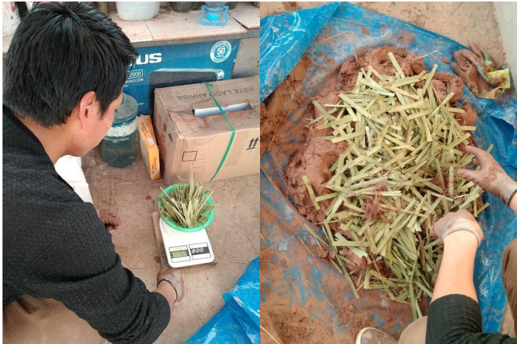
Figura 21. Dosificación de la palmera e integración con el barro.
