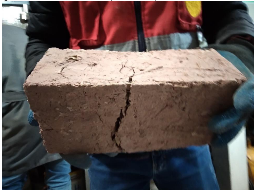
Figura 31. Falla del adobe producido por el esfuerzo de flexión.
