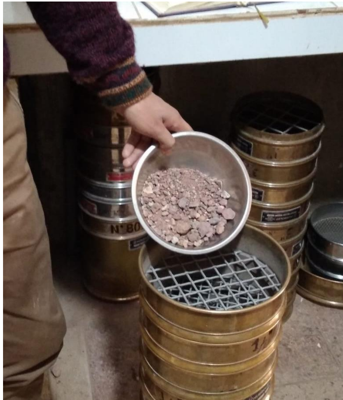
Figura 11. Tamizado de la muestra para determinar su granulometría.
