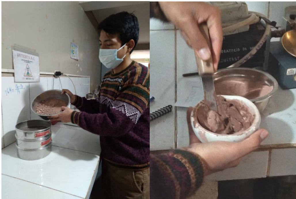
Figura 16. Realizando el ensayo del límite líquido.
