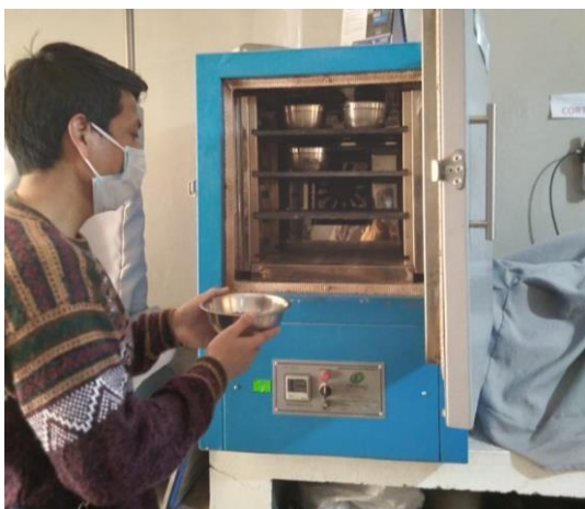
Figura 33 Secado de la muestra en el horno
