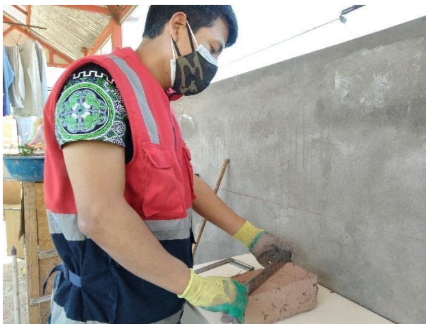
Figura 64 Medición del alabeo en el adobe.
