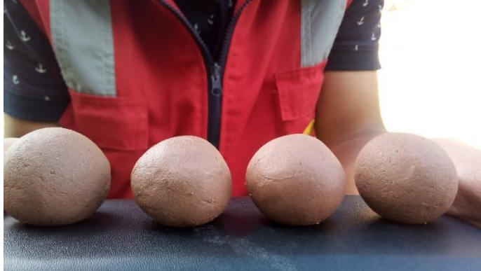
Figura 27 Conformación de las esferas para la comprobación del contenido de arcilla.
