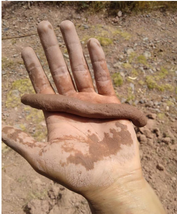
Figura 3. Conformación de la cinta de barro.
