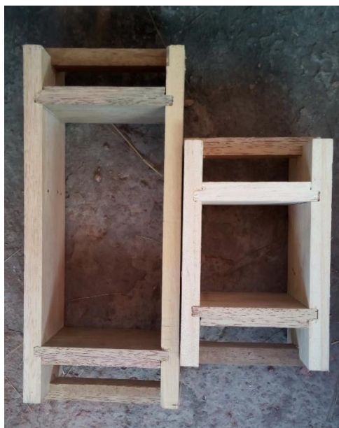
Figura 43 Moldes para la elaboración de los adobes
