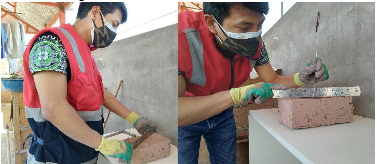
Figura 25. Medición de alabeo en las caras del adobe.
