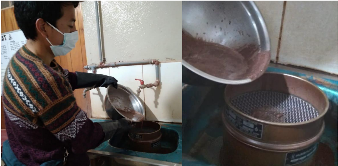
Figura 9. Lavado y secado de la muestra para el ensayo de granulometría.
