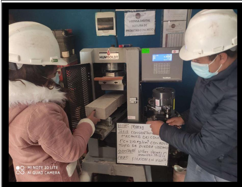
Imagen N° 04 COLOCACIÓN DE MUESTRA EN EQUIPO PARA LA FLEXIÓN
