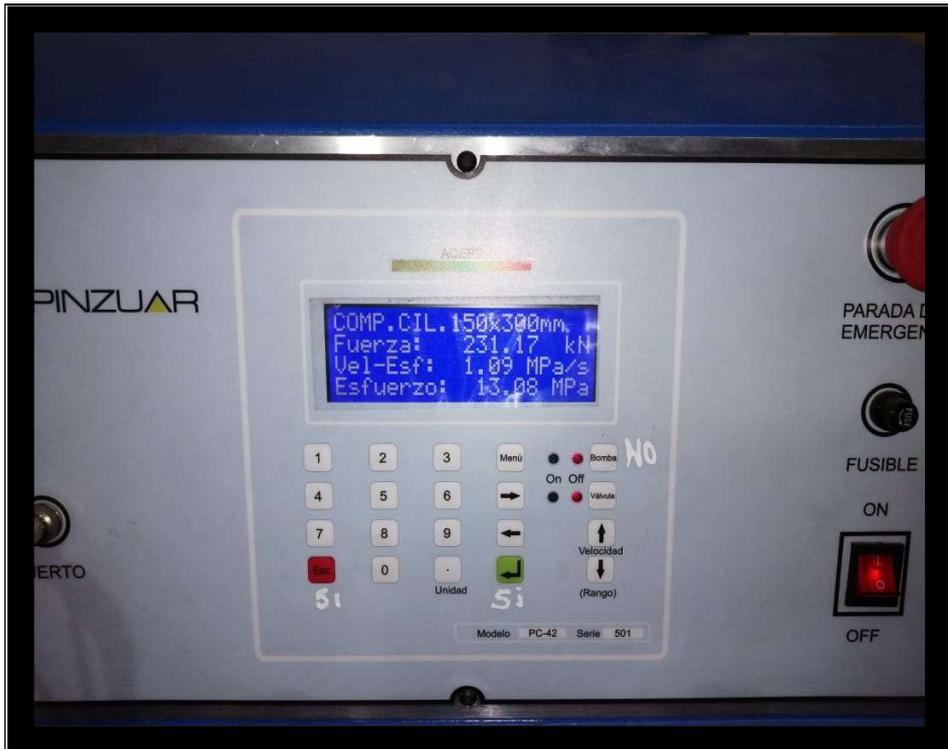
IMAGEN N° 09: SE OBSERVA LA MÁQUINA DE ENSAYO DE COMPRESIÓN
