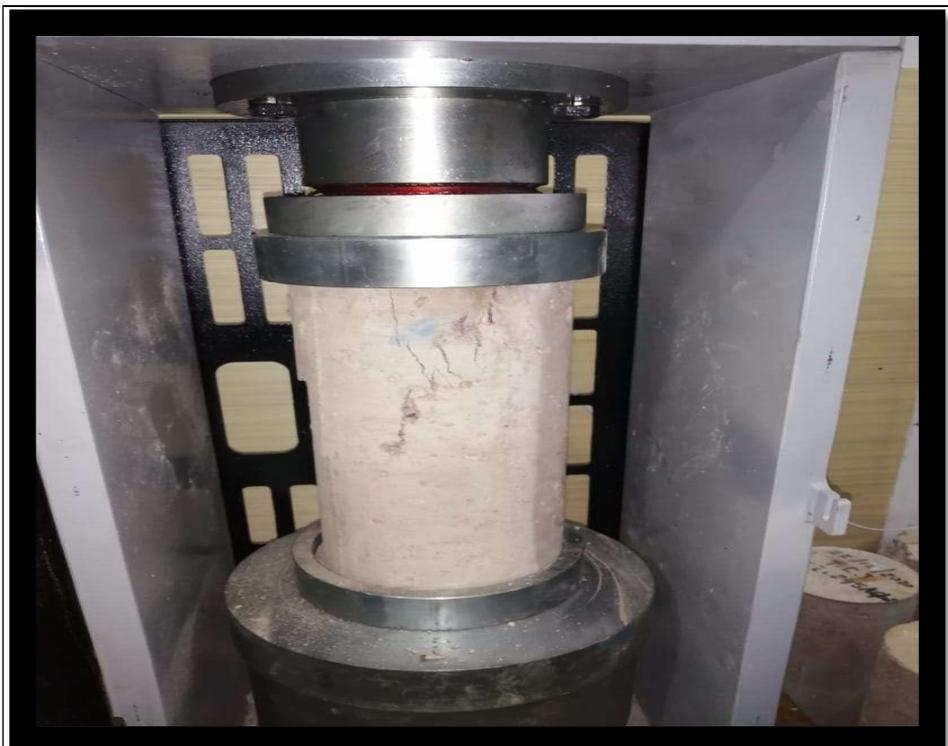
IMAGEN N° 10: ROTURA DE BRIQUETAS A COMPRESION
