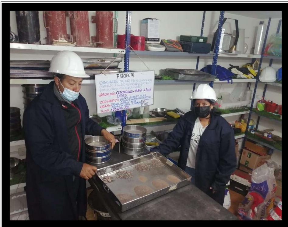
**IMAGEN N° 12: SE MUESTRA LA GRANULOMETRÍA PARA DISEÑO DE MEZCLAS**
