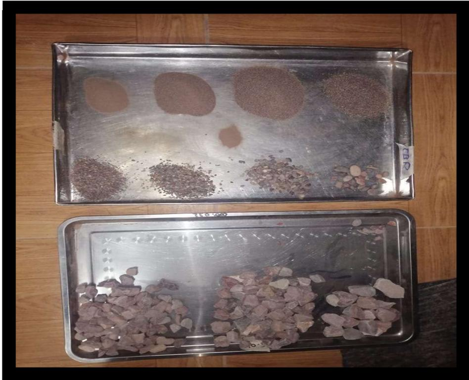
**IMAGEN N° 13: SE MUESTRA EL TAMIZADO PARA DISEÑO DE MEZCLAS**
