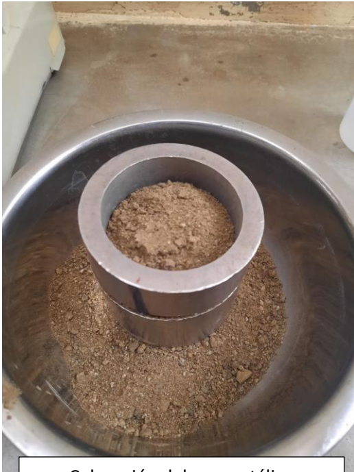
Colocación del aro metálico
