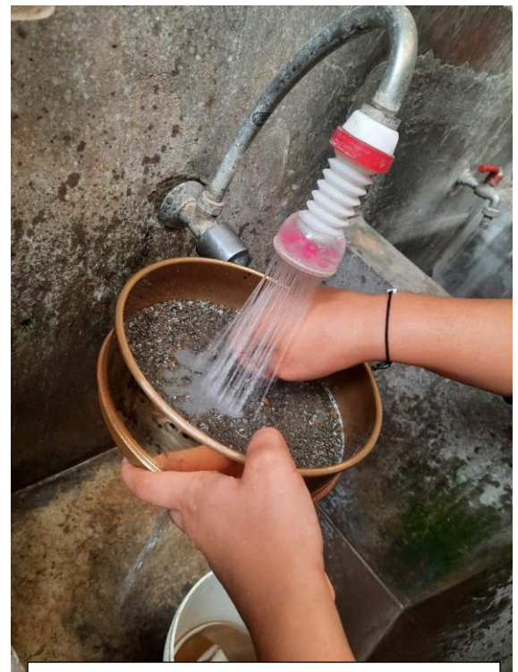
Lavado de la muestra que paso del tamiz N° 200
