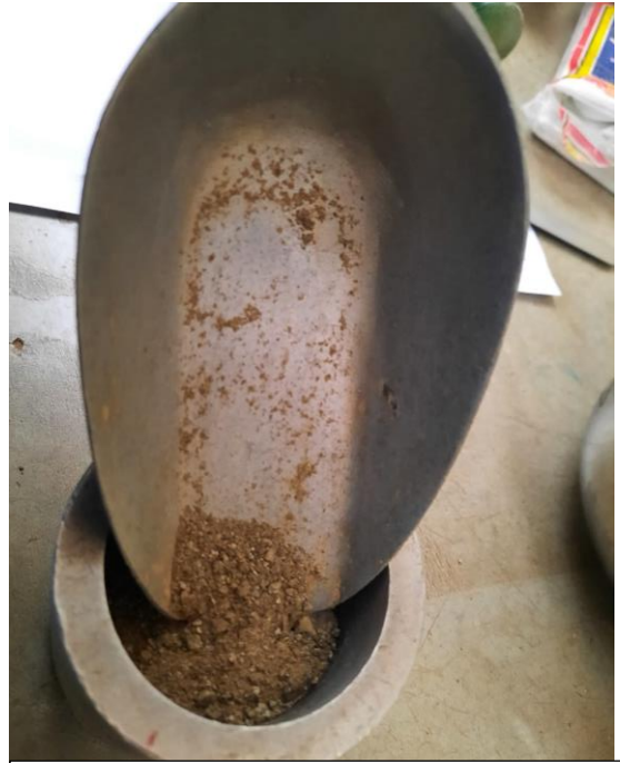
Colocación de la muestra dentro del aro y el recipiente metálico
