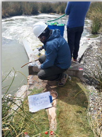
Figura 3.12 Muestras tomadas del agua que efluye del filtro percolador Fuente: Elaboración propia.
