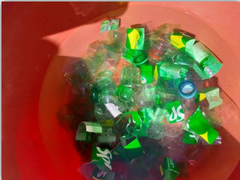
Figura 3.4 Lavado del PET para el lecho filtrante Fuente: Elaboración propia.
