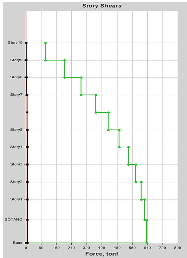
Figura N°27: Gráfico de fuerzas cortantes en “x” – análisis dinámico (Etabs)
