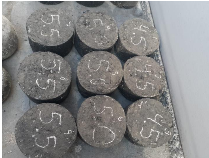
Briquetas con distintos porcentajes de cemento asfáltico
