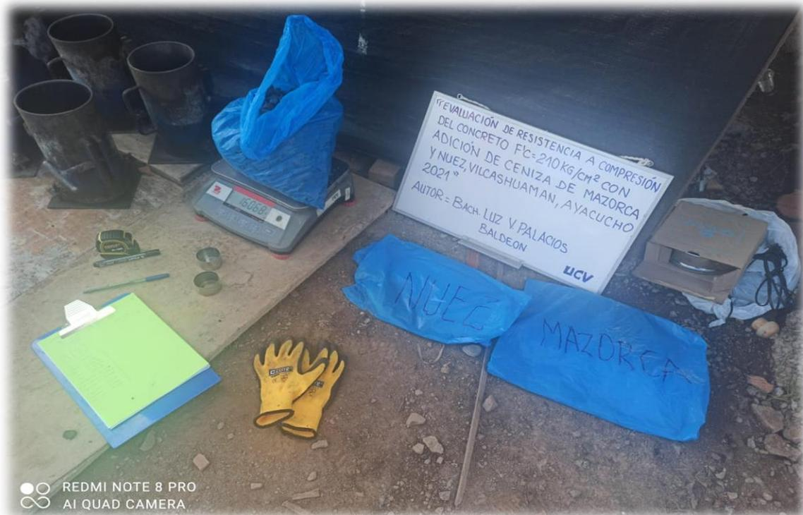
Fotografía 15. Materiales para la elaboración de probetas cilíndricas de concreto.
