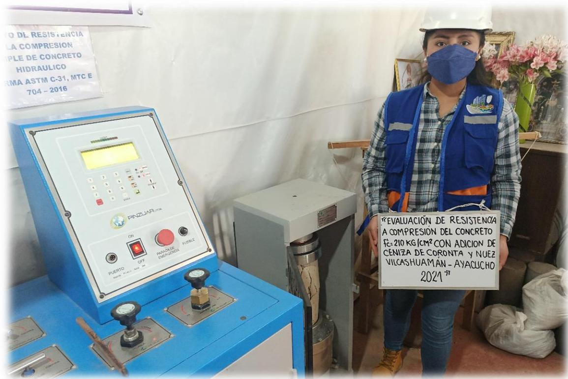
Fotografía 23. Ensayo de resistencia a compresión del concreto en probetas cilíndricas.
