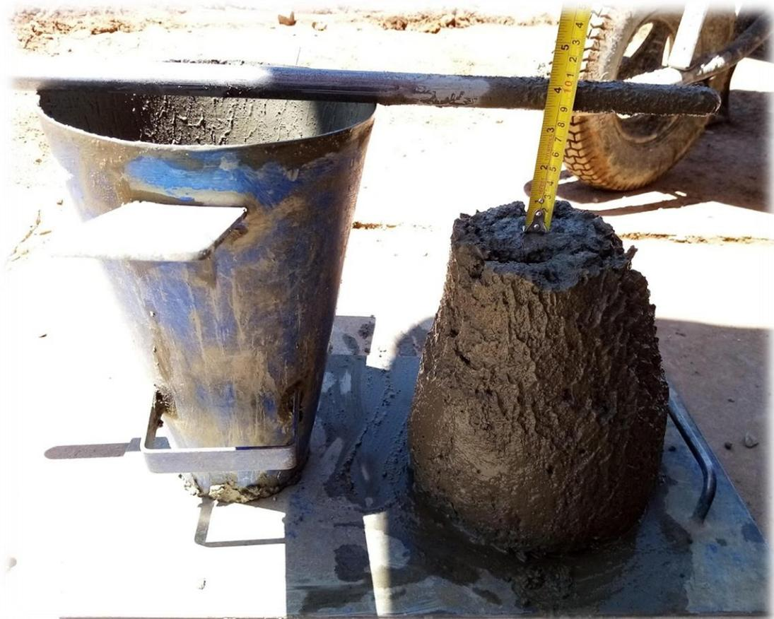
*Fotografía 18.* Ensayo del cono de Abrams.
