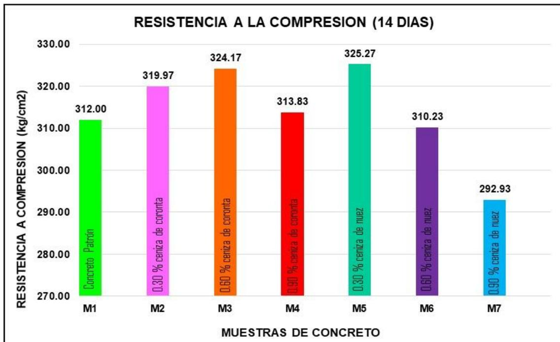
**Figura 29.** Gráfica de los resultados de resistencia a compresión (kg/cm<sup>2</sup>) de probetas cilíndricas con y sin adición de cenizas a los 14 días
