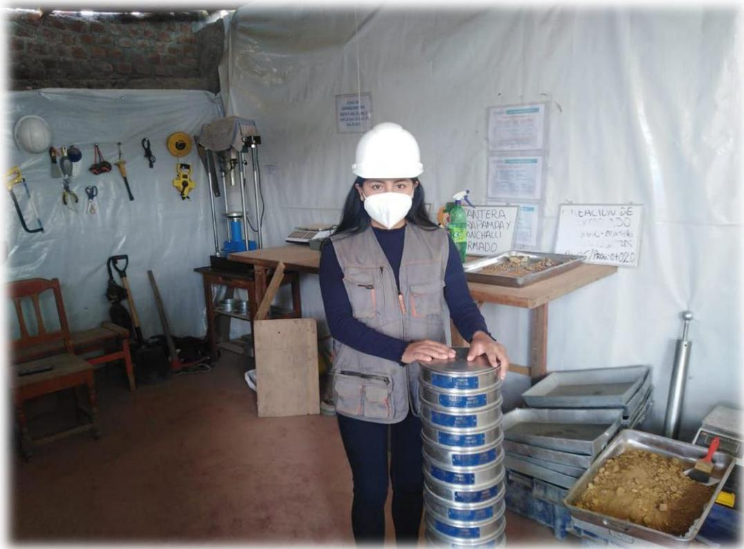
Fotografía 09. ensayo de granulometría de los agregados por tamices normados.
