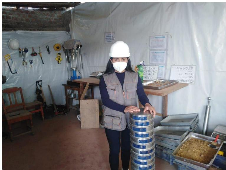
**Figura 9.** Análisis granulométrico de agregados ASTM C-136.
