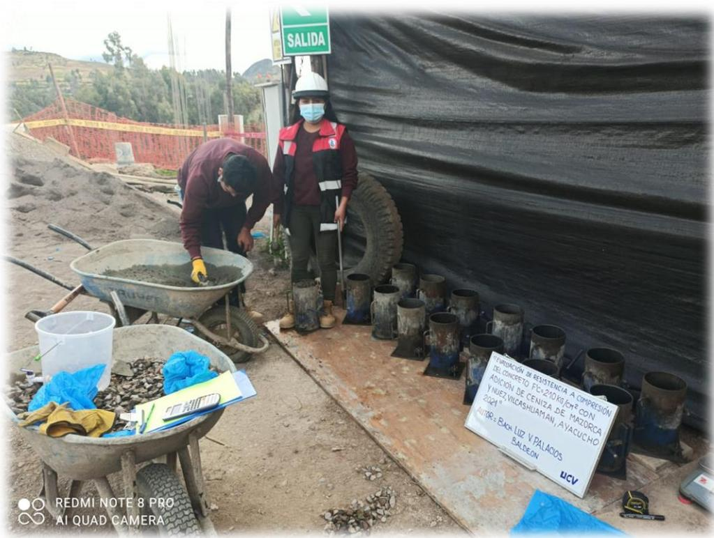
Fotografía 19. Elaboración de probetas cilíndricas de concreto para los 7, 14 y 28 días.
