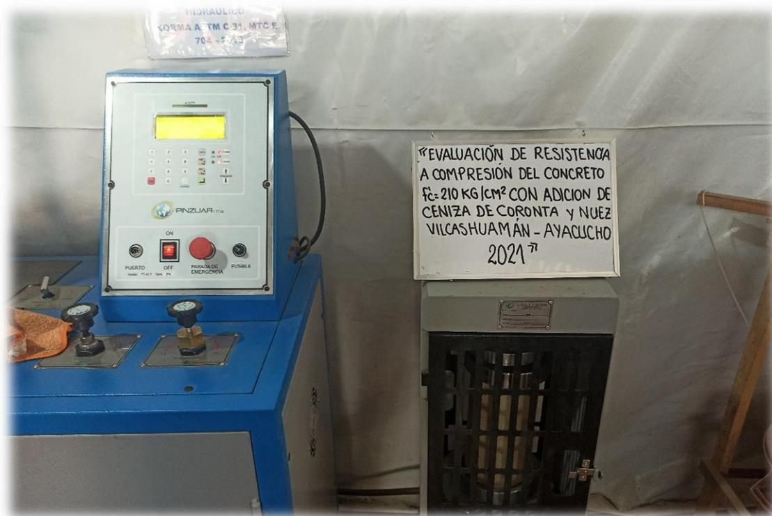
Fotografía 24. Prensa hidráulica para rotura de probetas de concreto.
