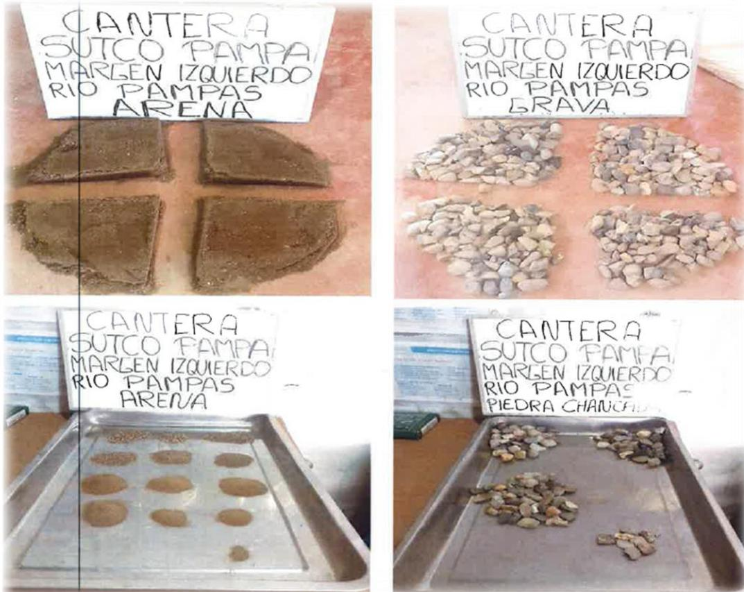
Fotografía 08. Cuarteo y ensayo de granulometría de los agregados.
