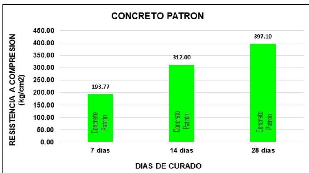
**Figura 31.** Gráfico de la resistencia a compresión kg/cm<sup>2</sup> a los 7, 14 y 28 días concreto patrón
