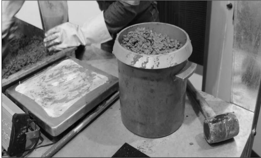
Figura 14. Proceso de la obtención del peso unitario del concreto fresco.
