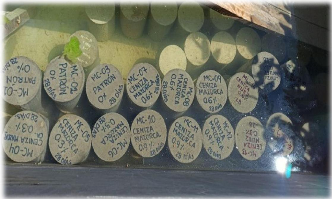
Fotografía 21. Curado de probetas cilíndricas de concreto.
