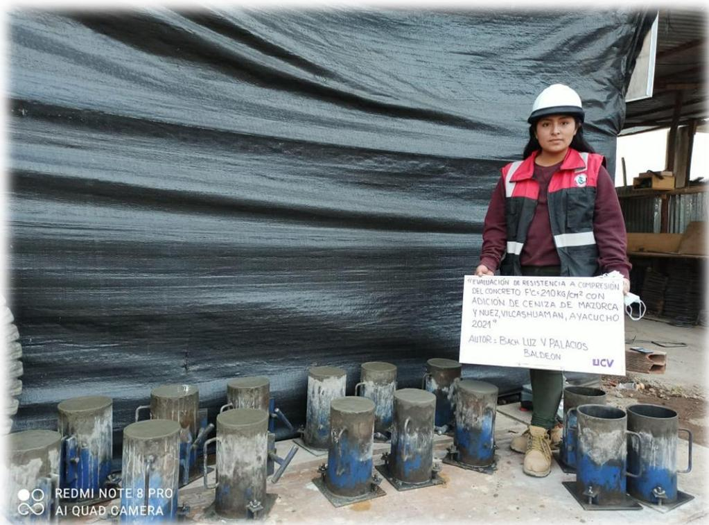
Fotografía 20. Probetas cilíndricas de concreto para los 7, 14 y 28 días.
