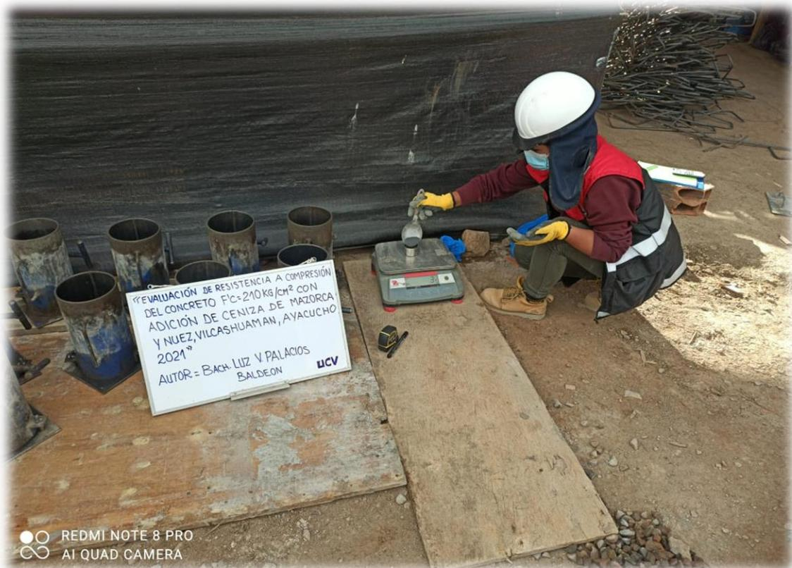
Fotografía 16. Pesaje de materiales para la elaboración de probetas con y sin adición de cenizas de coronta y nuez negra.
