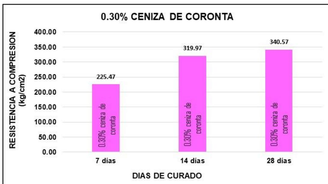
**Figura 32.** Gráfico comparativo de la resistencia del concreto, con adición de 0.30% de ceniza de coronta, a compresión respecto a los 7, 14 y 28 días.
