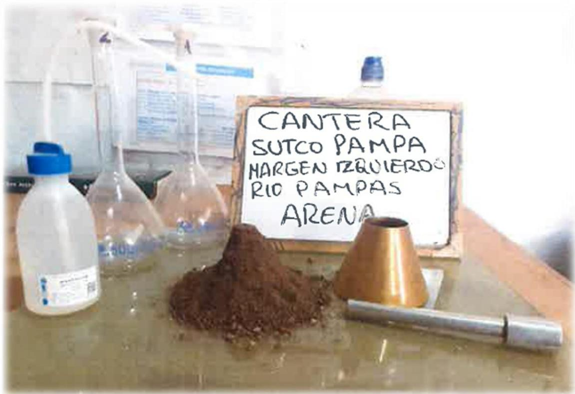
Fotografía 13. Ensayo de absorción y contenido de humedad en agregados.
