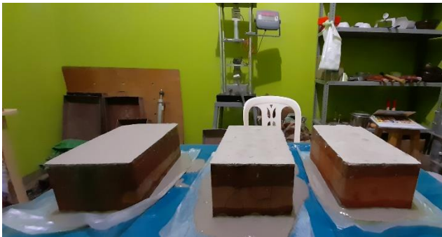
Fotografía 11. Ladrillos refrentados ambas caras.
