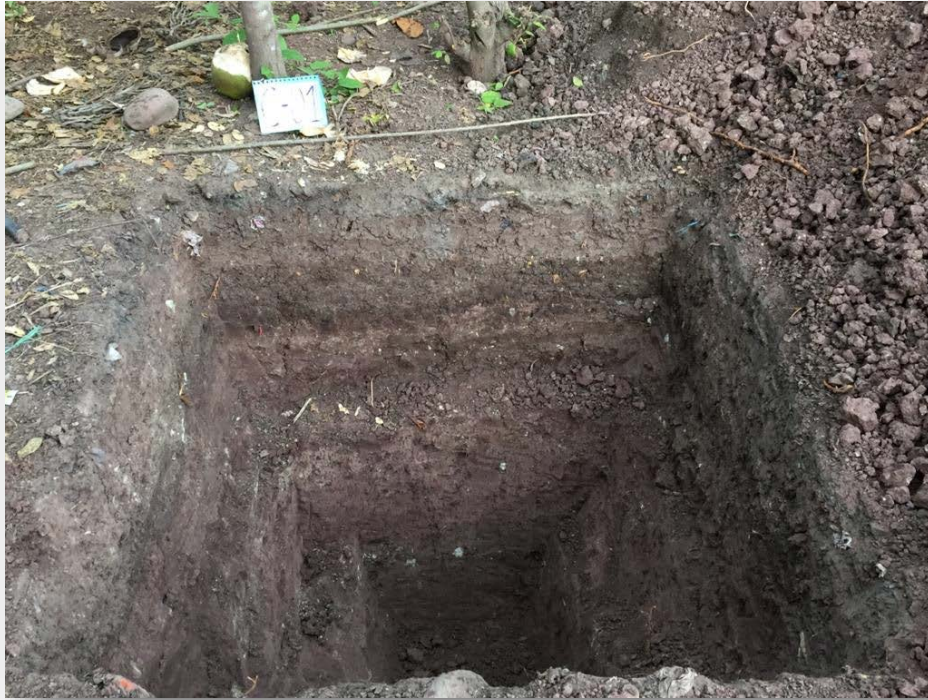
Foto 03: calicata 01 en la progresiva 0+000
