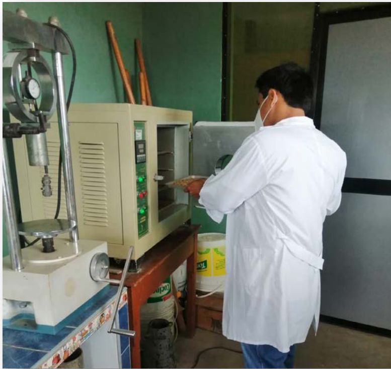
Foto 06: Colocación de la muestra natural en la estufa por 24 horas.
