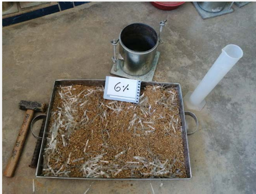
Foto 09: Muestra con adición de PET al 6%
