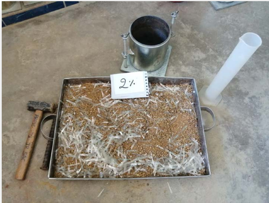
Foto 07: Muestra con adición de PET al 2%
