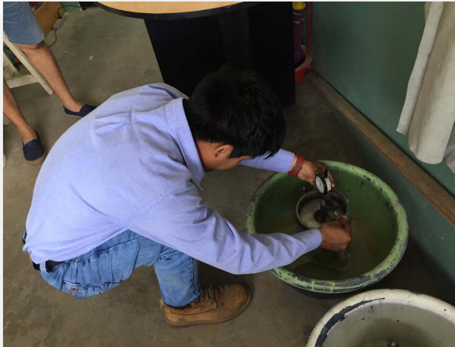
Foto 11: Preparación de la muestra para inmersión durante 5 días
