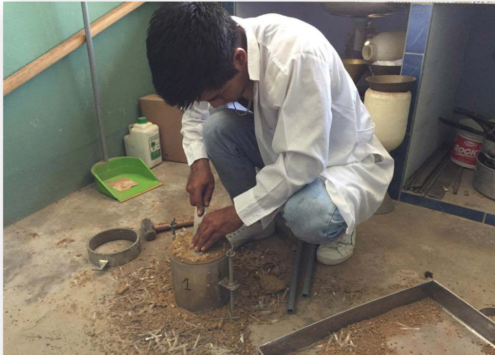
Foto 10: Ensayo de Proctor Modificado con adición de PET
