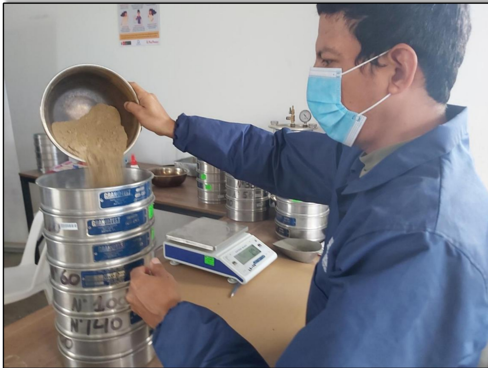
Figura 5 : Ensayo de granulometria por tamizado
