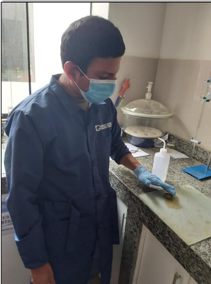
Figura 11 : Muestra de suelo para realizar el límite plástico
