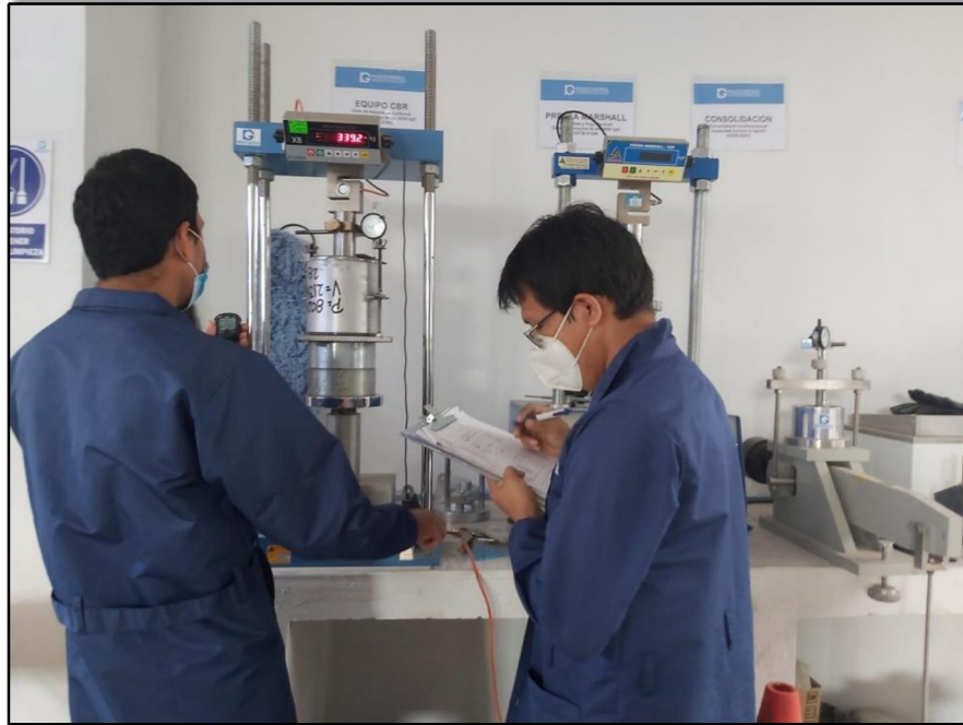
Figura 17 : Penetrando en la prensa CBR
