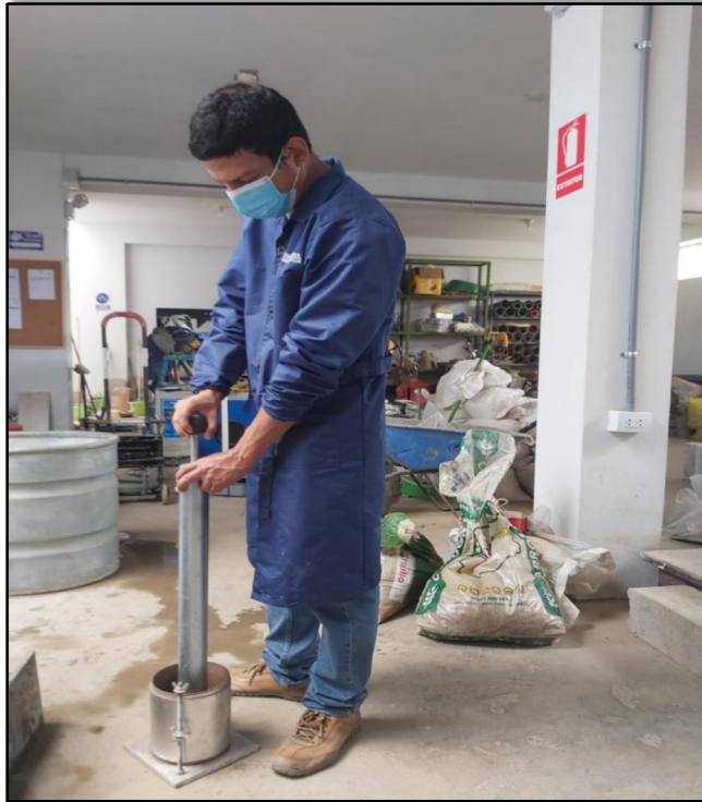
Figura 14 : Procedimiento de compactación por 5 capas
