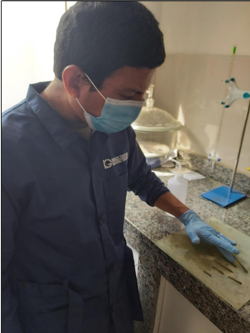
Figura 12 : Formando pequeños rollos para obtener el límite plástico
