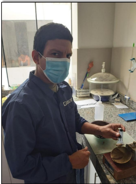
Figura 10 : Copa casa grande para realizar el límite líquido
