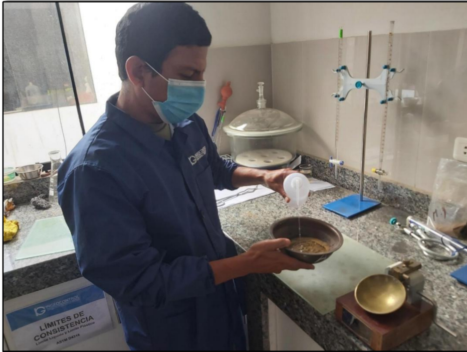
Figura 9 : Humedeciendo la muestra de suelo
