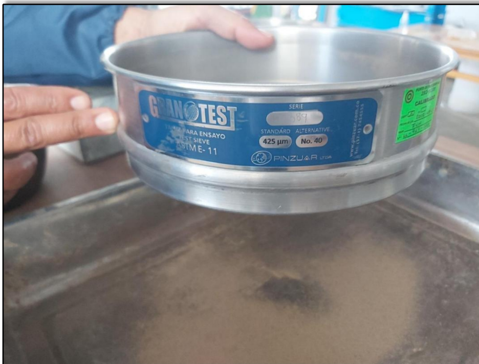
Figura 8 : Muestras pasantes la malla n° 40 para realizar el ensayo de límites de Atterberg
