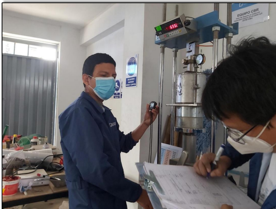
Figura 18 : Se registra las lecturas de carga
