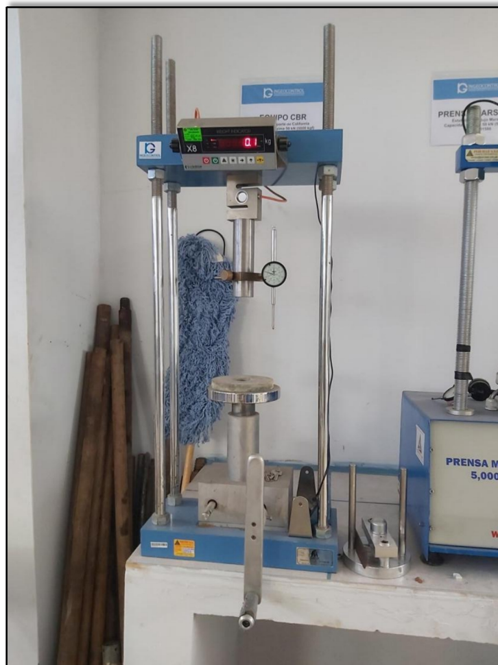
Figura 16 : Prensa multiusos para ensayo de CBR
