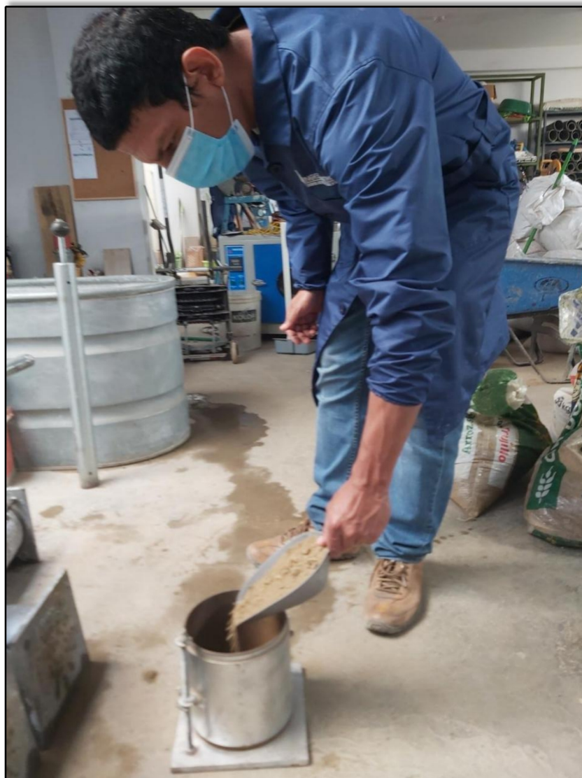
Figura 13 : Llenando los moldes para realizar el proctor modificado
