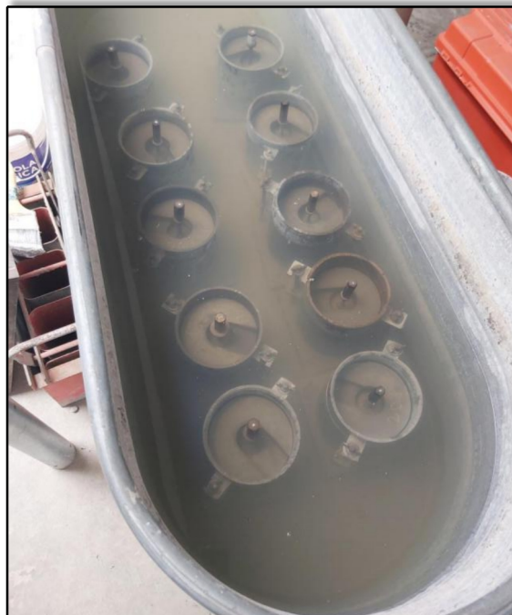
Figura 15 : Se sumergen por 96 horas los moldes
