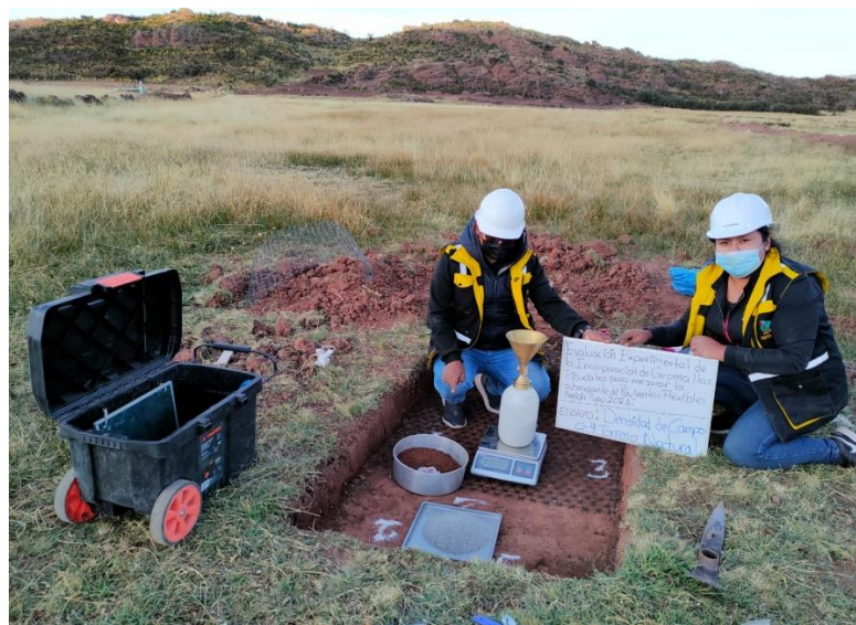
Figura 31. Ensayo de cono de arena
