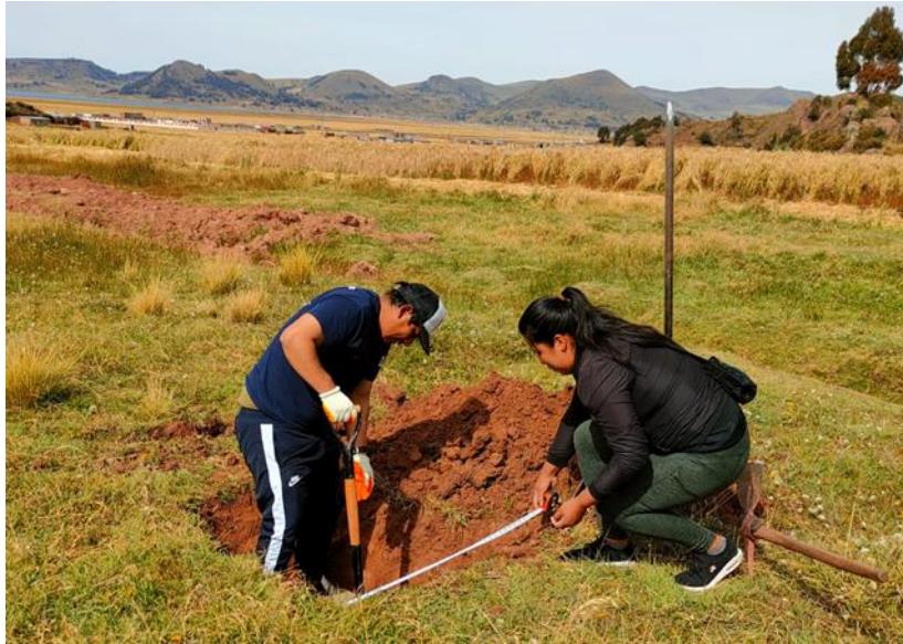
Figura 24. Preparación de la superficie donde se realizará el ensayo
