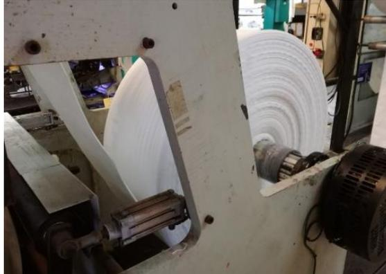
*Figura 19: Sistema desbobinador de máquina FEVA. (Fuerte propia)*
