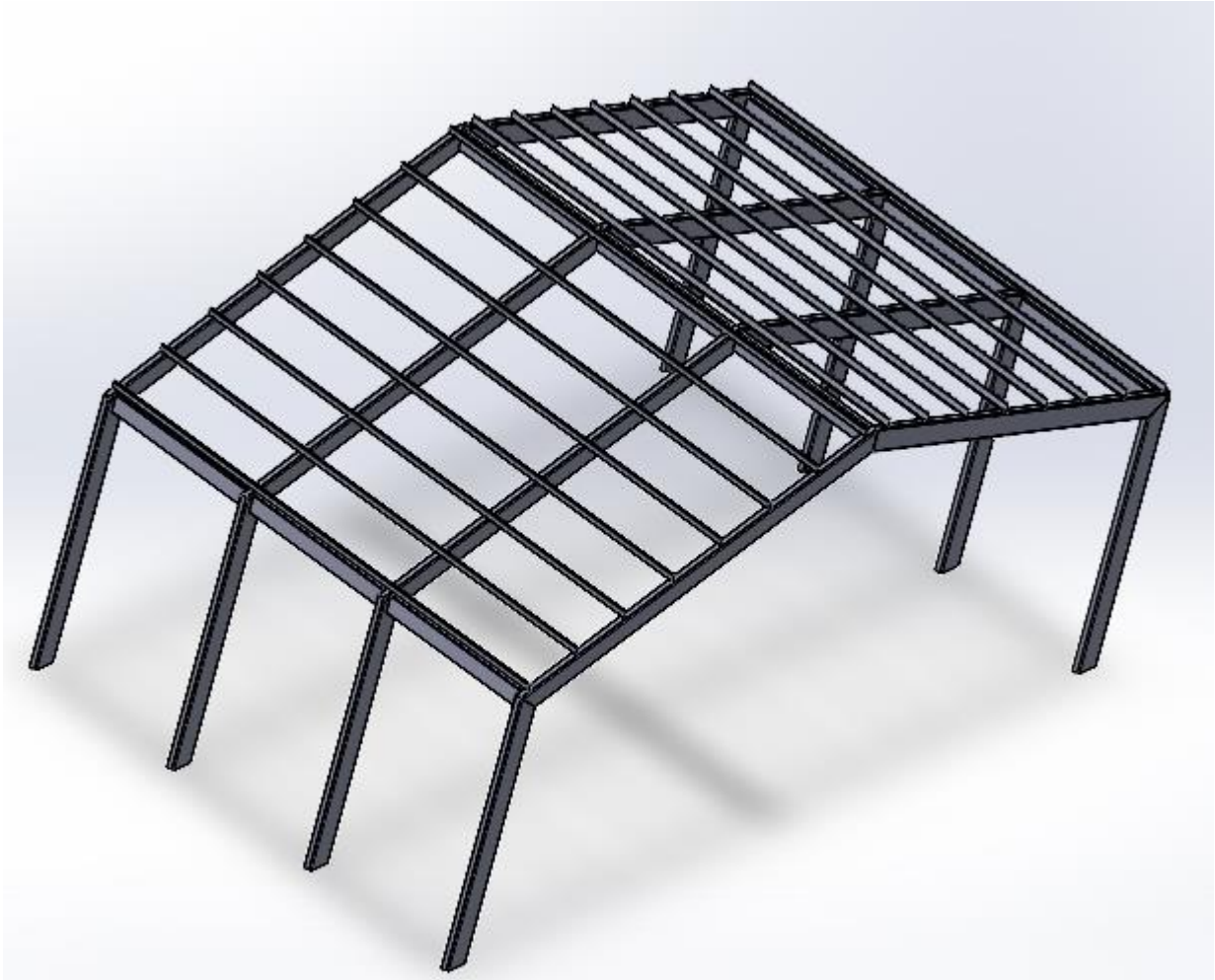
Figura 07. Selección de las viguetas que soportarán el techo de la estructura.
