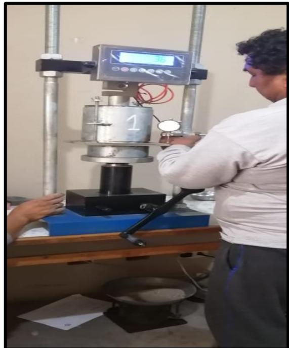
**Figura 38.** Penetración ensayo de CBR.
