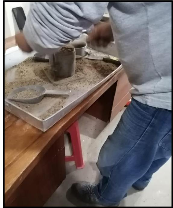
**Figura 36.** Molde compactado y enrasado.
