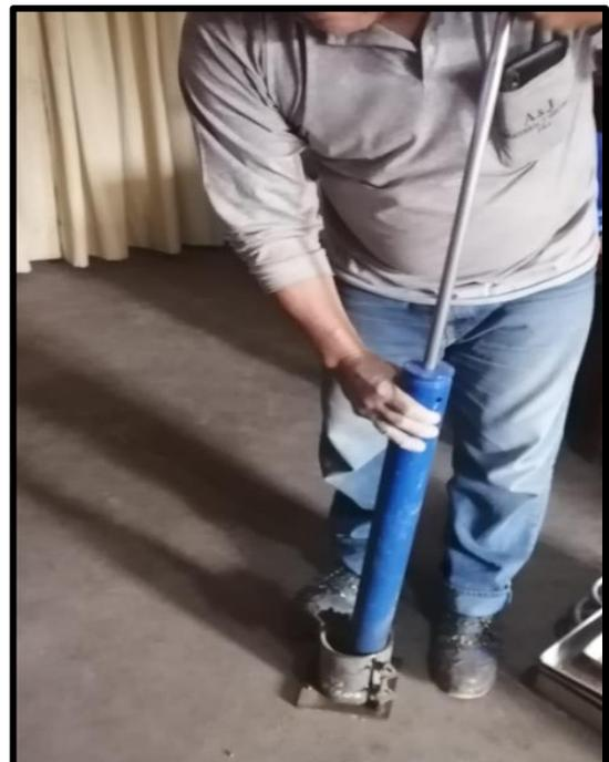
**Figura 34.** *Compactación en 5 capas con agua.*
