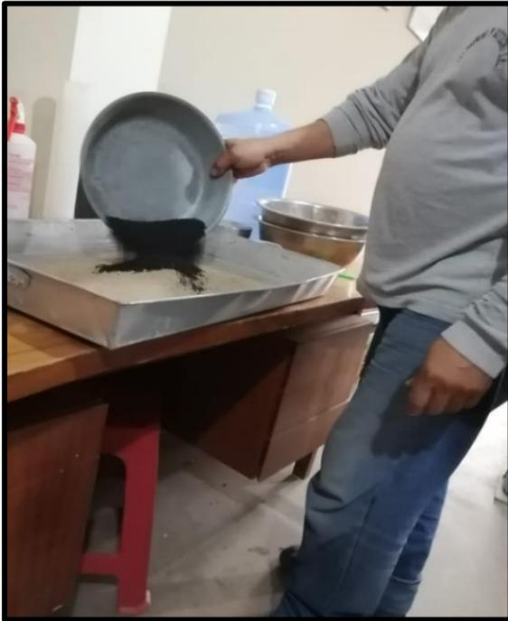
**Figura 35.** Homogenización de suelo+caucho.
