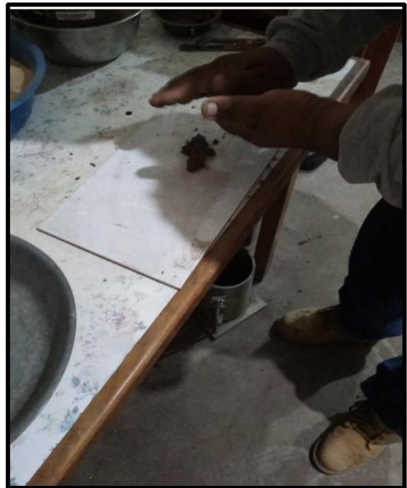
**Figura 30.** *Ensayo de límite plástico.*
