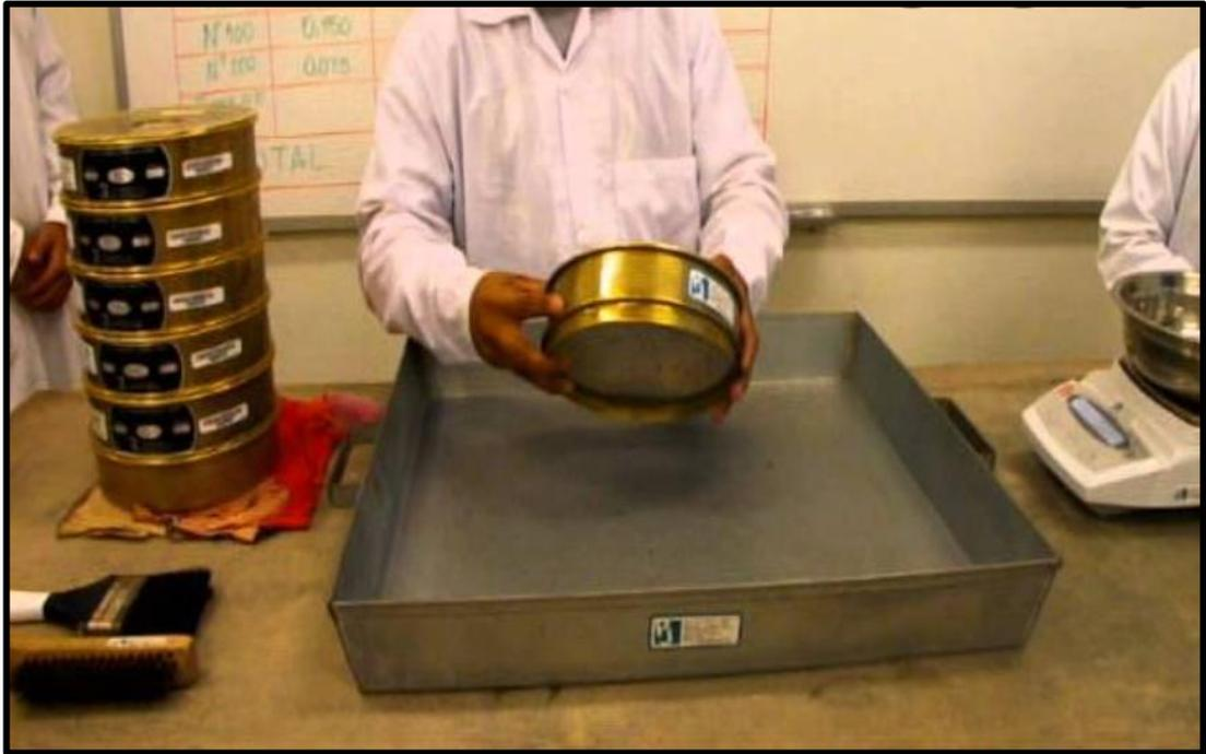
**Figura 4.** Ensayo de análisis granulométrico.
