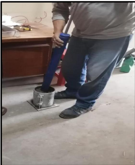
**Figura 37.** Compactación molde de 6" para el ensayo de CBR.
