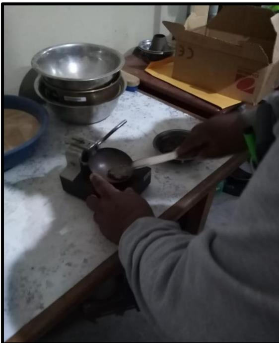
**Figura 29.** *Ensayo de límite líquido.*
