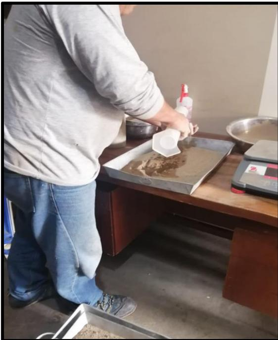
**Figura 33.** *Homogenización del suelo.*
