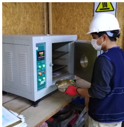
Figura 15. Contenido de Humedad. Fuente: Elaboración propia (2021).
