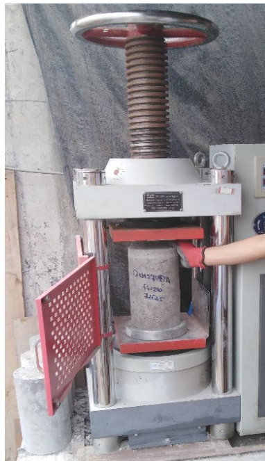
Figura 14. Roturas de probetas. Fuente: Elaboración propia (2021).
