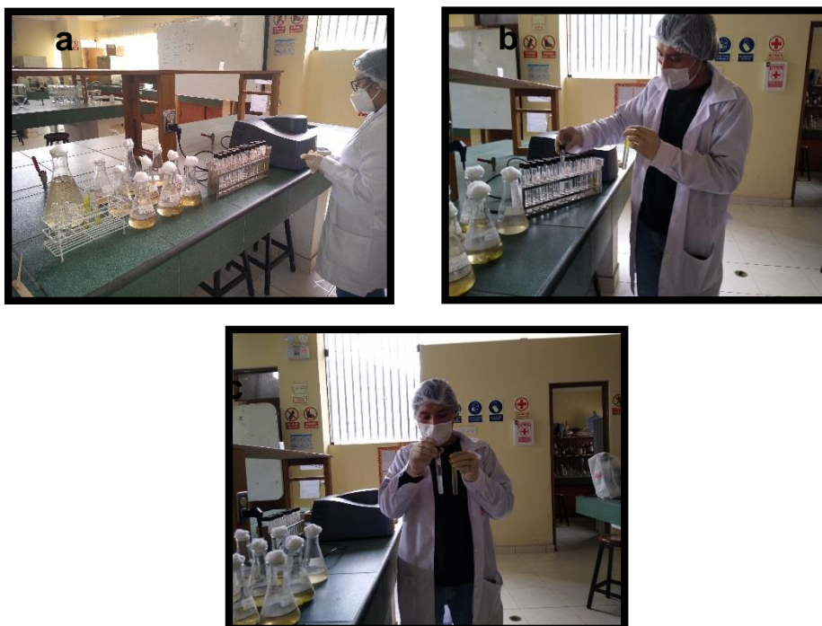
Figura 9. a) Instrumento de Mac Farland b) Uso del instrumento de Mac Farland y c) comparación del tubo 3 de Mac Farland con concentración de cianobacterias.
