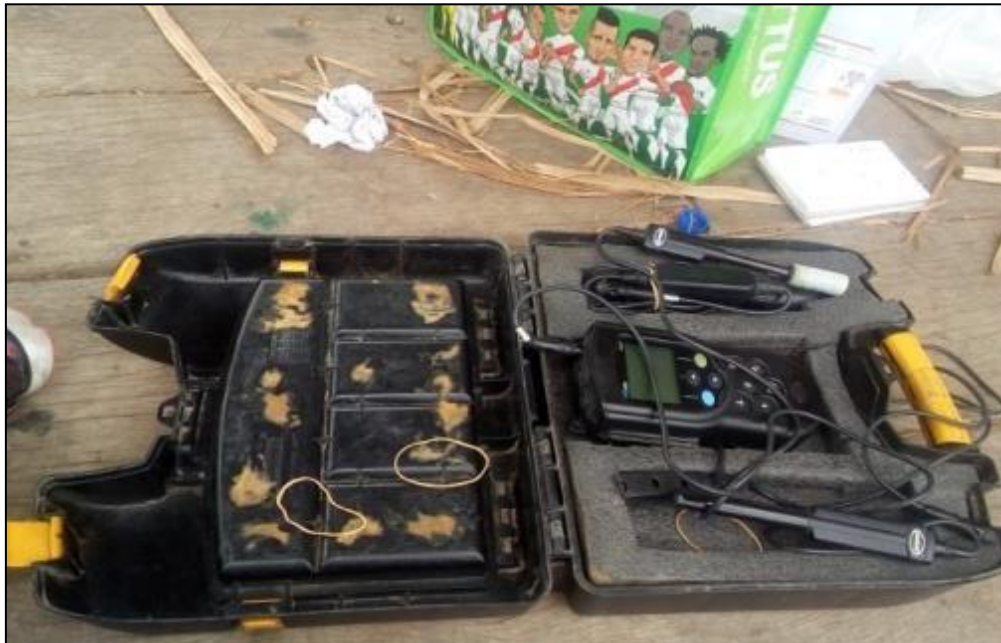
Foto N°3: Equipos a usar para la medición de parámetros insitu en el agua.
