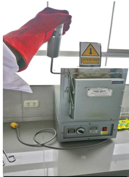
Colocación de la muestra del carbón activado a la mufla
