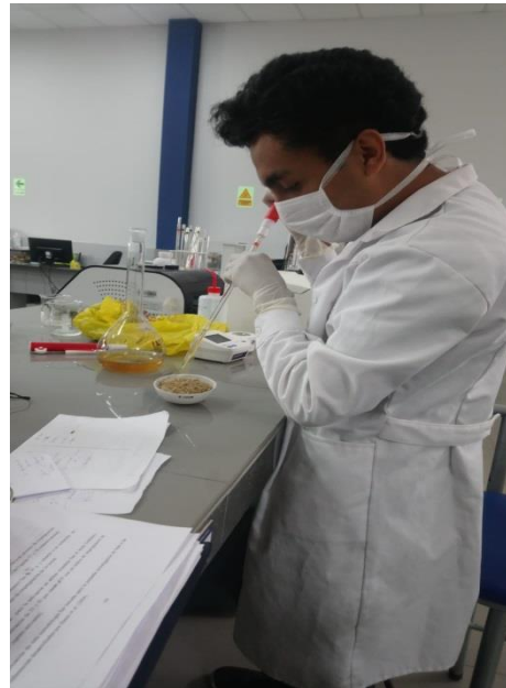
Impregnación del activante ( H_3PO_4 ) y dejarlo por 24 horas con dicho activante
