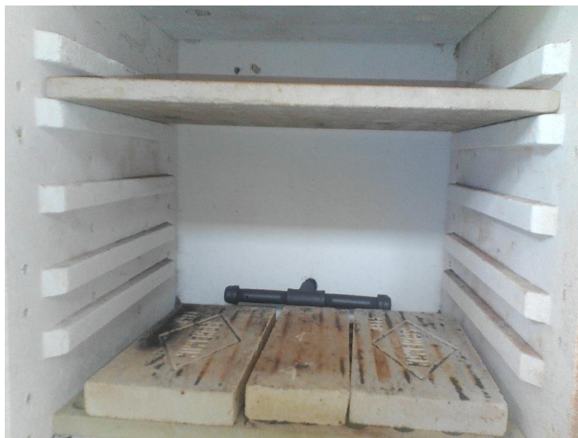
Imagen 06: Horno inerte de atmósfera controlada
