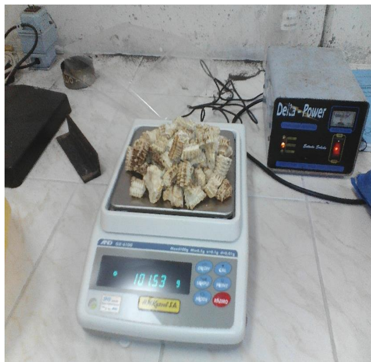
Imagen 04: Pesado del material seco antes de meterlo al horno inerte
