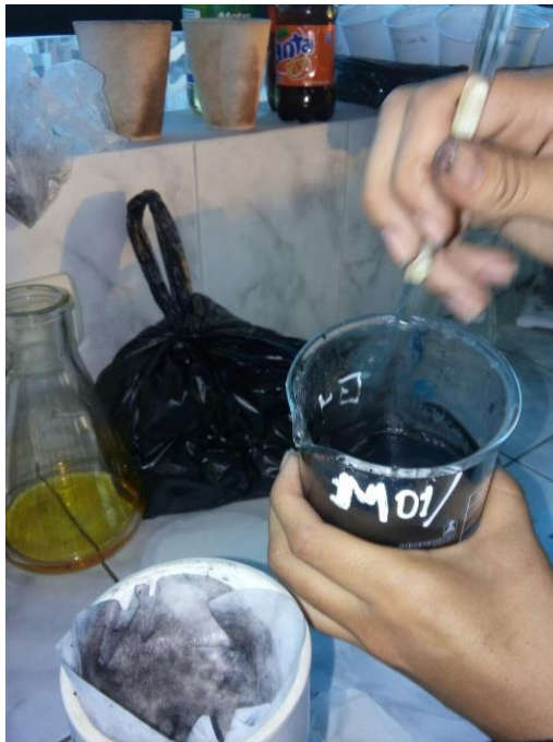
Imagen 01: Filtrado de la muestra tratada con carbón activado
