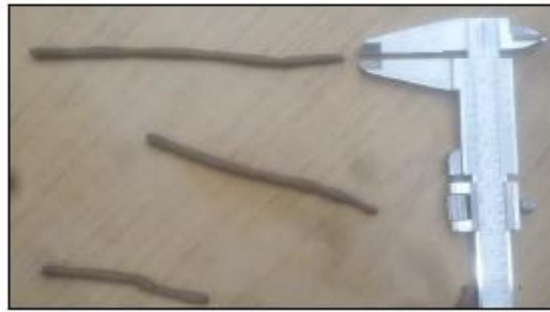
Figura 6. Muestra para la obtención del límite plástico.
