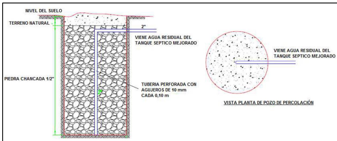
Figura 5. Pozo de Absorción
