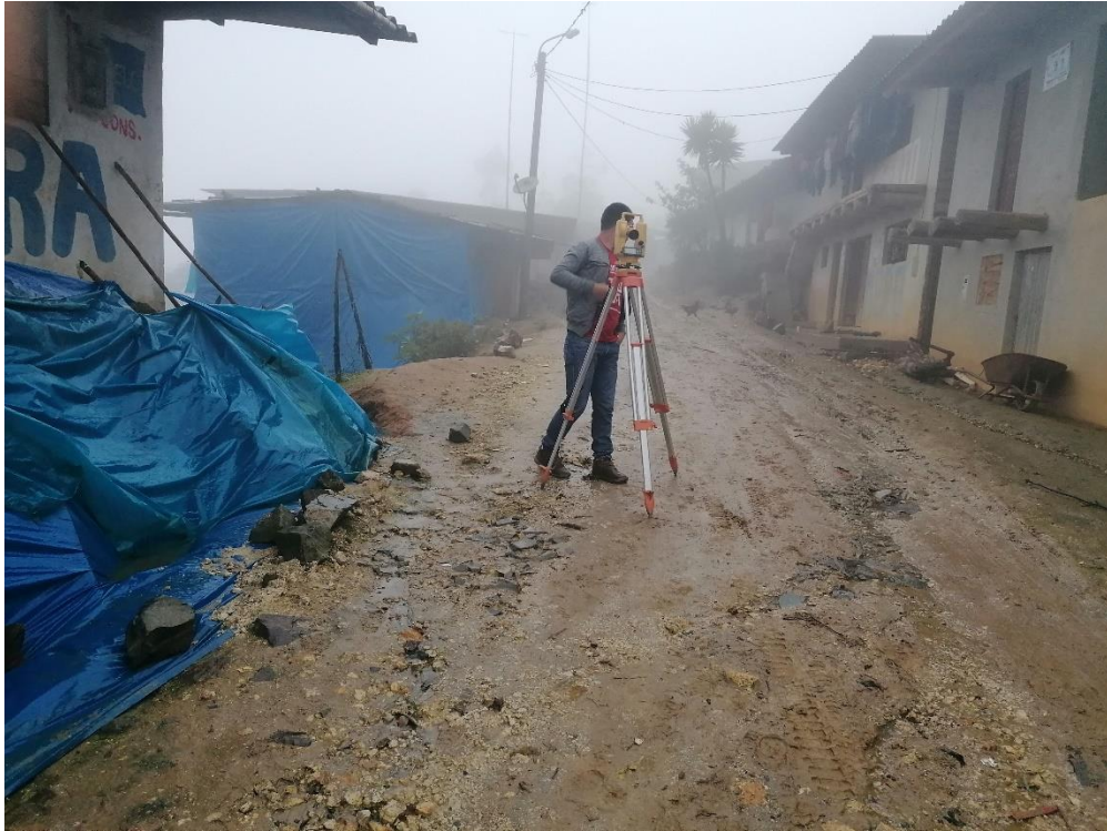
En la imagen se aprecia que se está haciendo un cambio de estación
