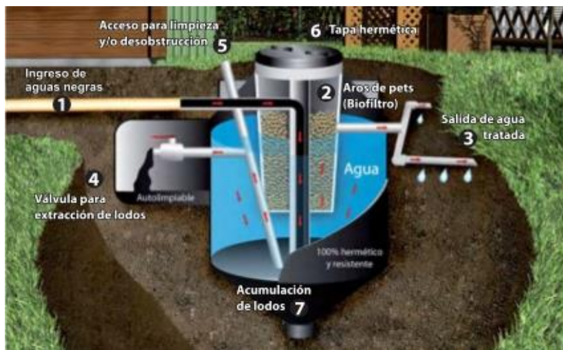
Figura 2. Biodigestor con sus elementos
