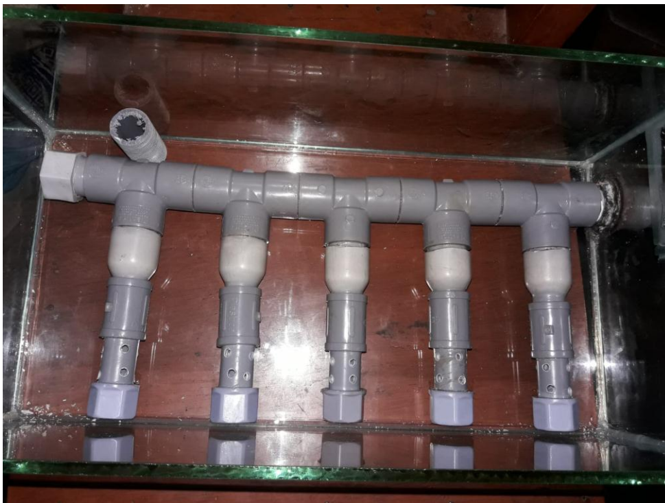
Imagen 5. Tubo colector y las tuberías laterales con orificios.
