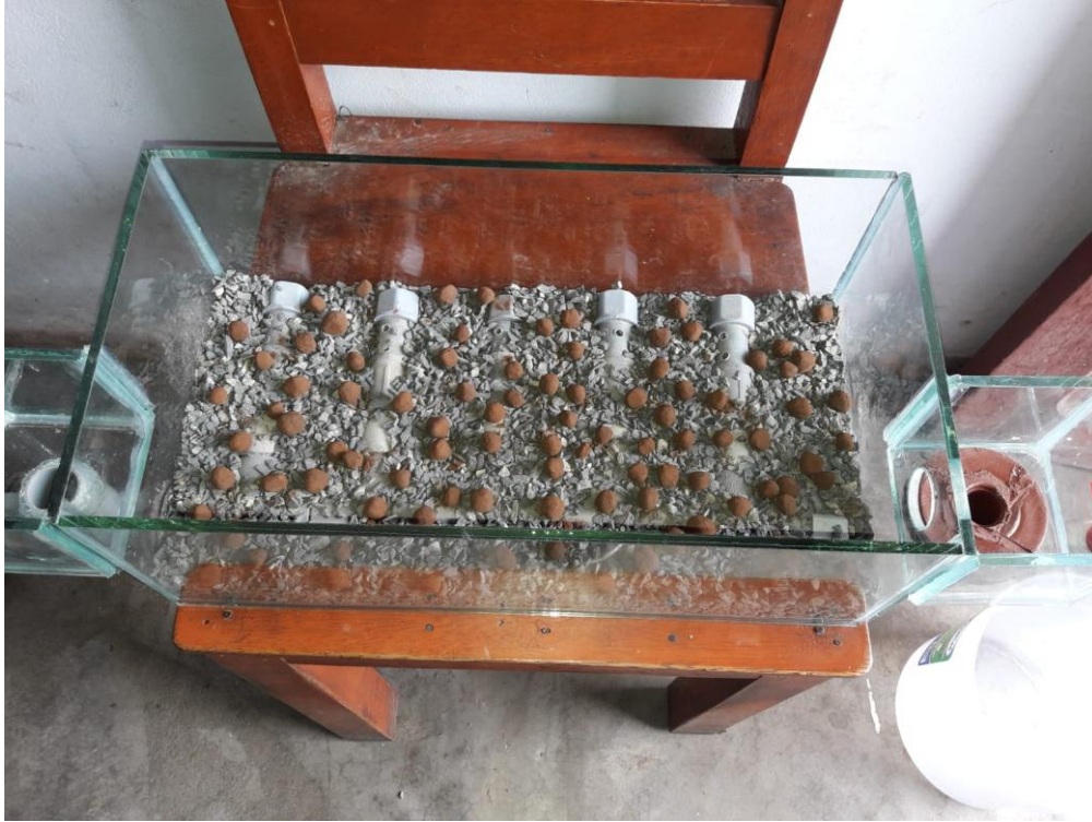
Imagen 8. Se colocan las esferas en el biofiltro
