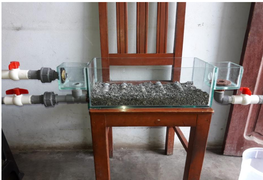
Imagen 7. Se coloca la capa de confitillo.
