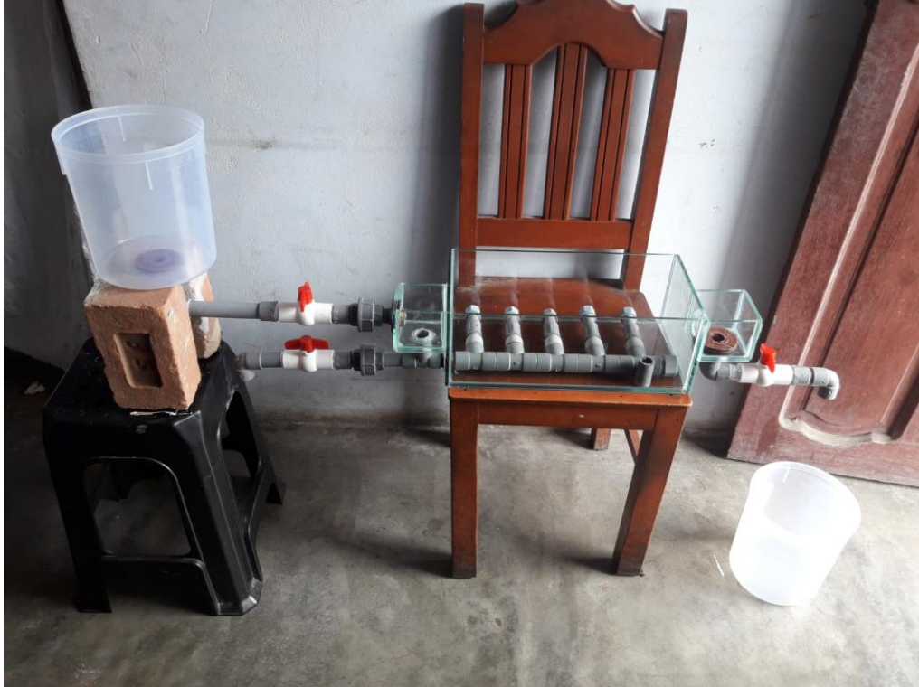
Imagen 6. Se colocan las válvulas al Biofiltro que ya contiene las tuberías.
