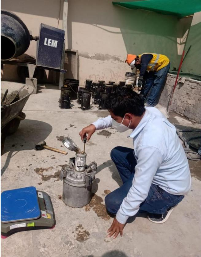
**Figura 33.** ensayo de contenido de aire en olla Washington
