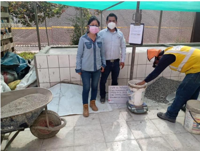
**Figura 24.** pesaje de los agregados. Fuente: Elaboración propia
