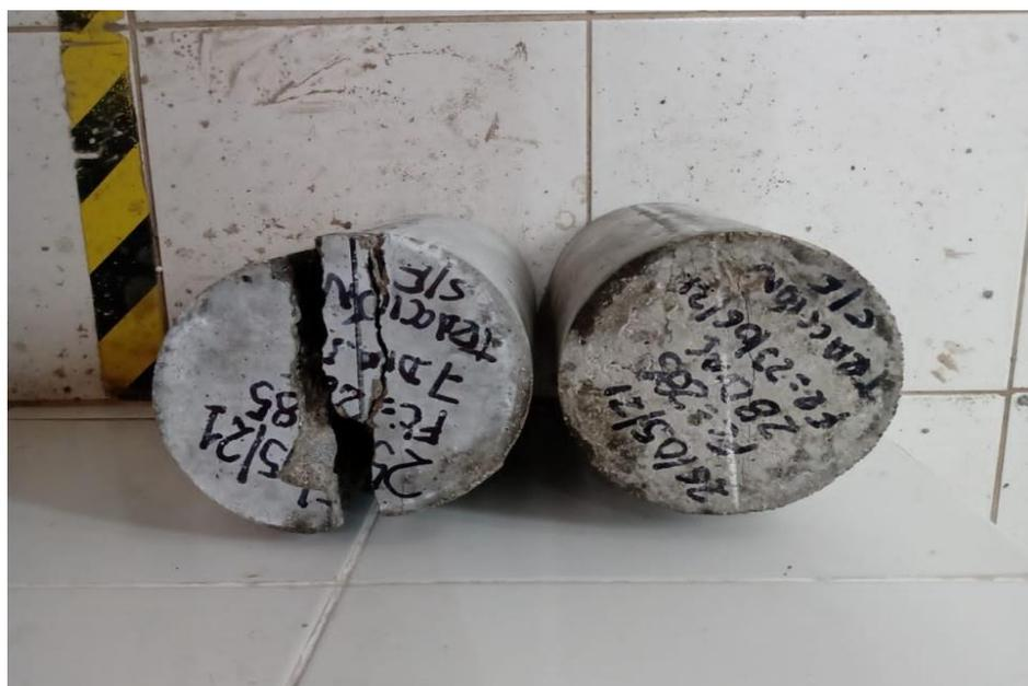
Figura 47. Ensayo de módulo de rotura a 28 días. Fuente: Elaboración propia
