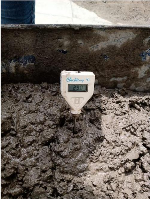
**Figura 29.** ensayo de temperatura en concreto fresco
