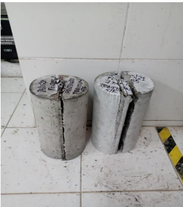
**Figura 46.** Ensayo a tracción de concreto 28 días. Fuente: Elaboración propia
