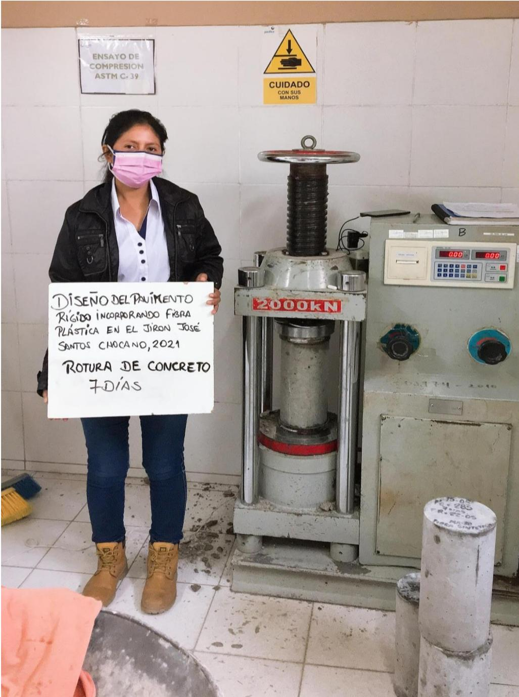
**Figura 43.** Ensayo a la compresión de Probetas cilíndricas a los 7 días. Fuente: Elaboración propia
