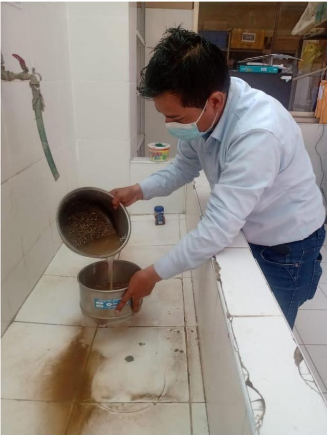
**Figura 18.** lavado de agregado fino
