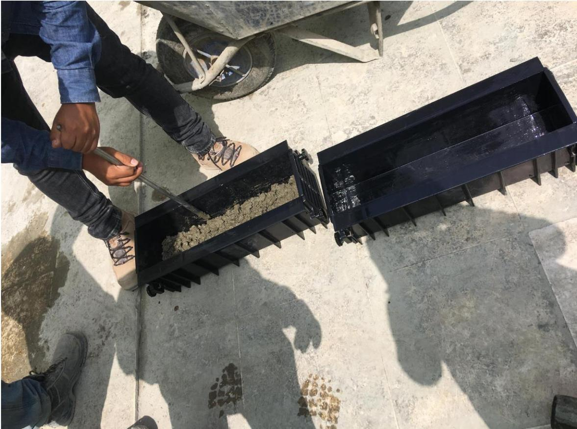
**Figura 37.** Golpes para disminuir espacios vacíos en vigas
