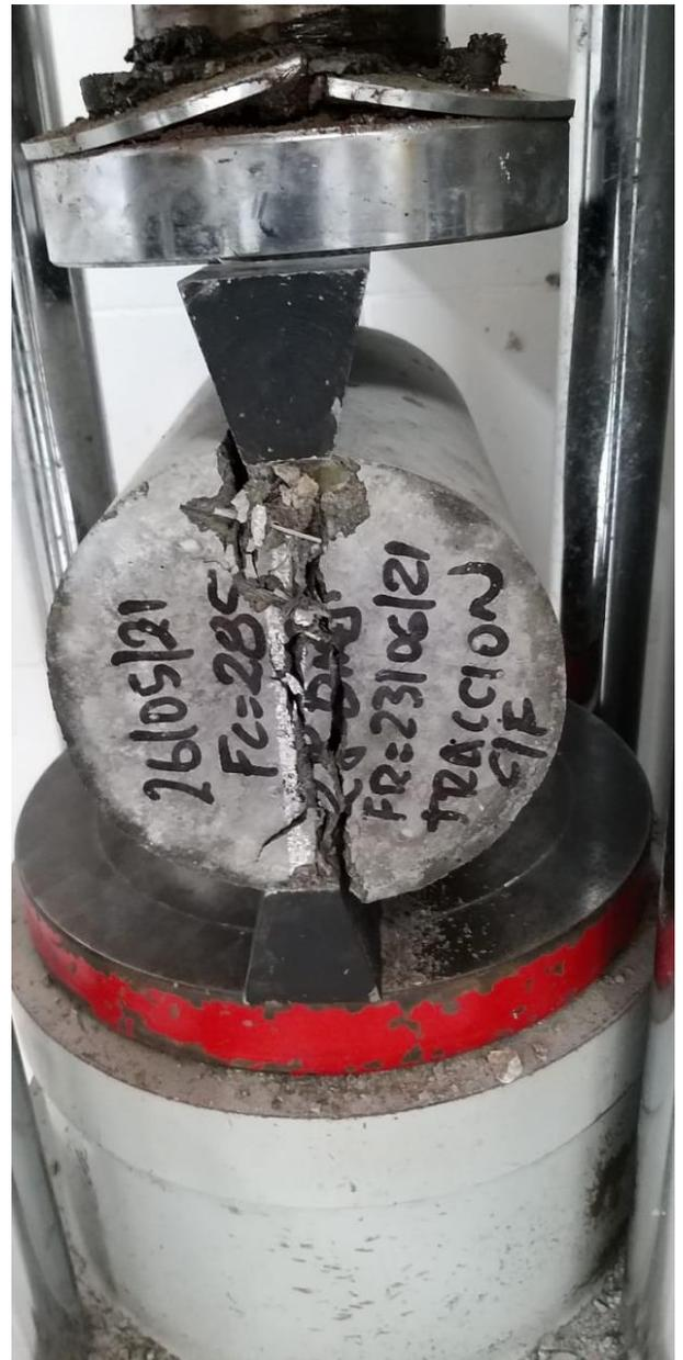
**Figura 48.** Ensayo a tracción de probetas a 28 días. Fuente: Elaboración propia
