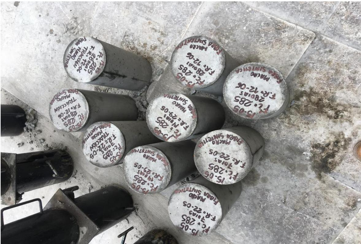
**Figura 42.** Secado de Probetas cilíndricas. Fuente: Elaboración propia
