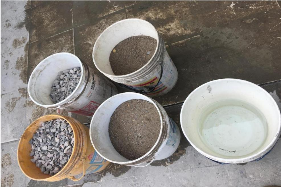
**Figura 23.** dosificación para el diseño de concreto. Fuente: Elaboración propia
