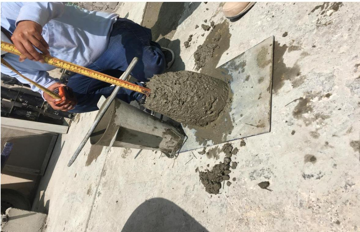
**Figura 40.** slump de concreto con fibra
