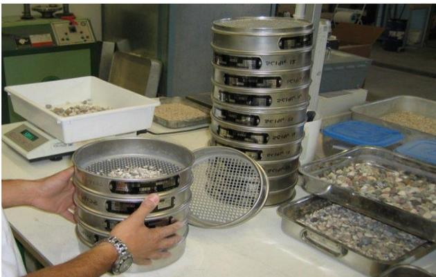
**Figura 8.** Proceso de granulometría por tamizado.
