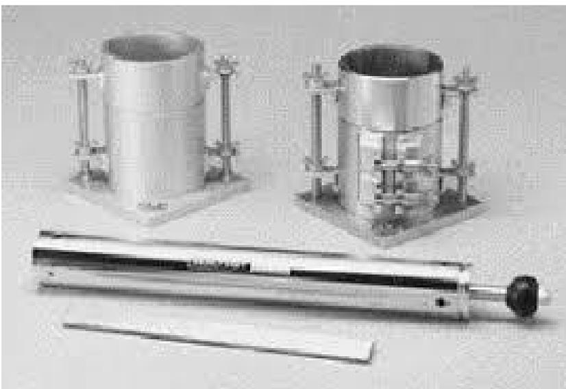
**Figura 11.** Equipo para realizar el ensayo de Proctor modificado.
