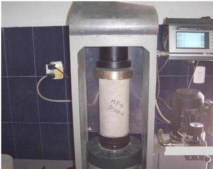
**Figura 13.** *Resistencia a la compresión de concreto.*
