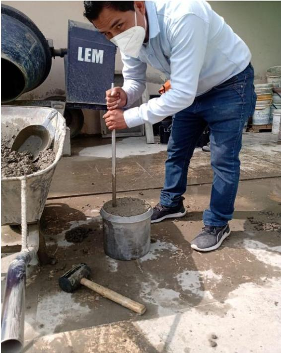
**Figura 31.** ensayo de contenido de aire en olla Washington
