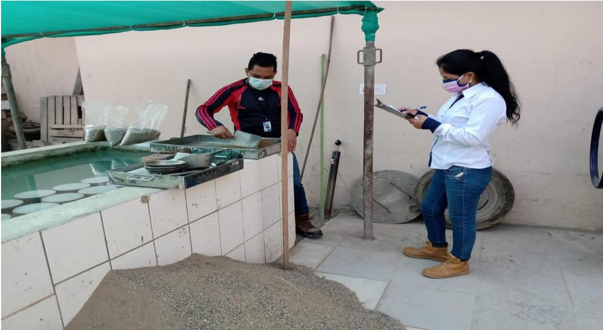
**Figura 21.** cuarteo de agregado para ensayo de proctor. Fuente: Elaboración propia
