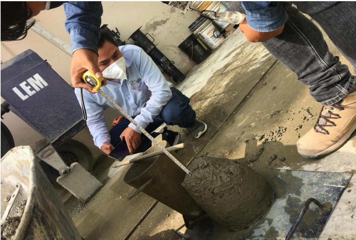
**Figura 28.** slump de concreto patrón. Fuente: Elaboración propia
