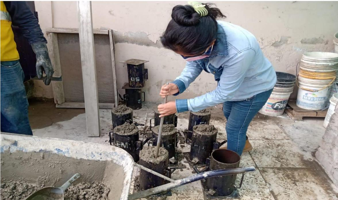
**Figura 36.** Golpes para disminuir espacios vacíos en probetas
