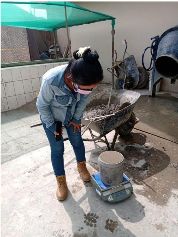
**Figura 32.** peso del concreto para el ensayo de contenido de aire en olla Washington
