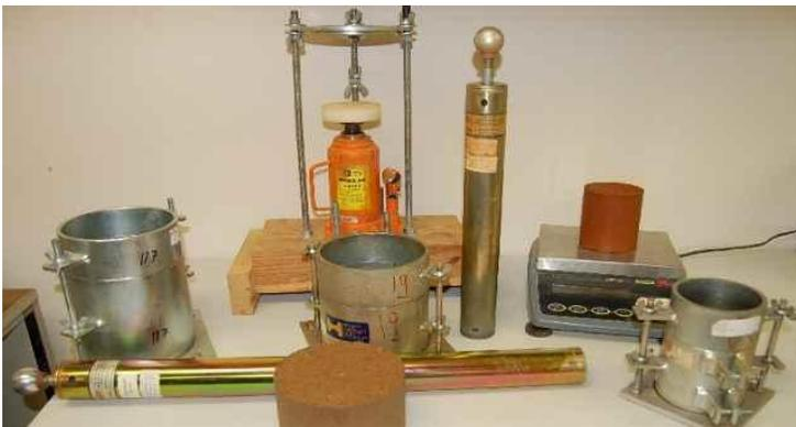
**Figura 10.** Materiales para el ensayo CBR.
