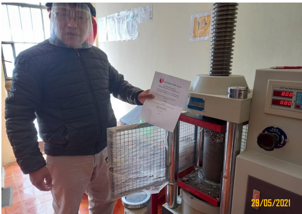
Figura 75: Rotura de probetas de concreto a los 14 días en laboratorio.
