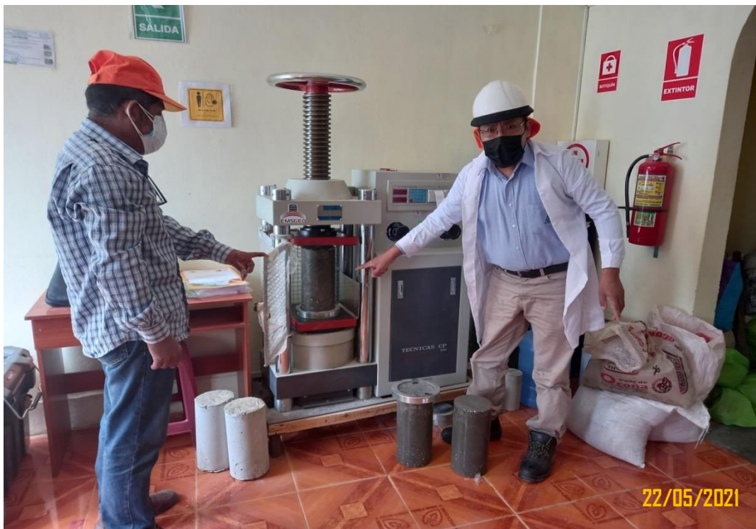
Figura 73: Rotura de probetas, patrón, con adiciones de perlas de poliestireno de 6, 12 y 18%, todas a la edad de 7 días en laboratorio.
