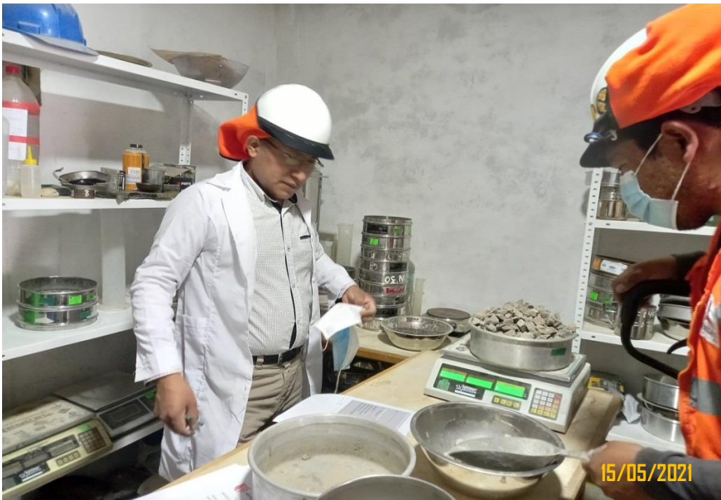
Figura 59: Vista de pesaje del agregado grueso (piedra ¾").
