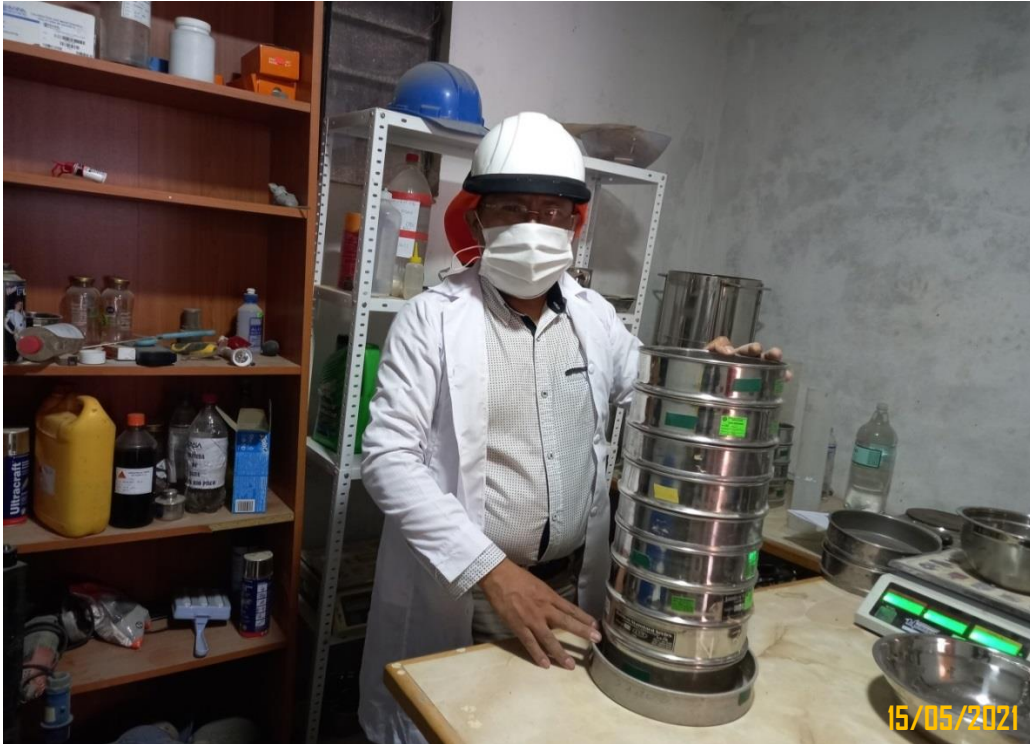
Figura 58: Vista del tamizado del agregado fino grueso de la cantera CONTA ROMA.
