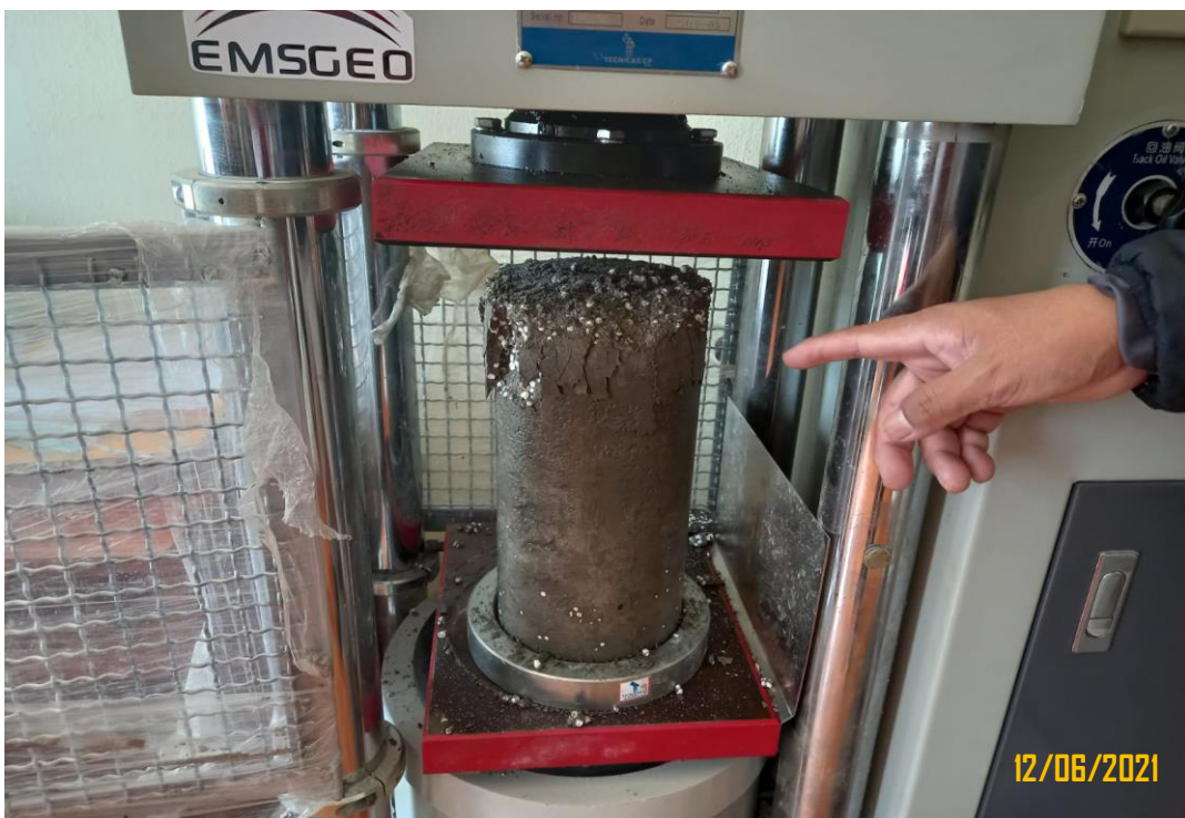
Figura 77: Rotura de probetas de concreto a los 28 días en laboratorio.
