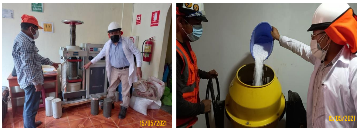
Figura 11: La fotografía de la derecha muestra la adición de perlas de poliestireno, y la fotografía izquierda muestra la rotura de probetas, con adiciones de perlas de poliestireno en laboratorio.
