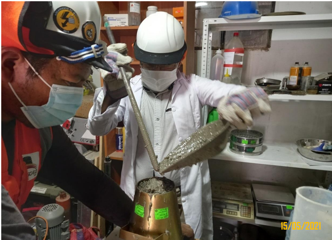
Figura 68: Vista que demuestra la realización de prueba de slump de la mezcla.
