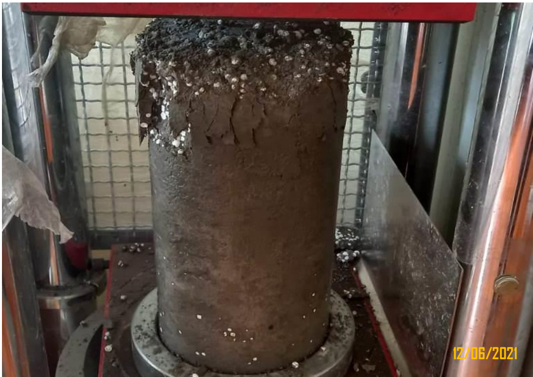
Figura 79: Probeta roturada, con adición de perlas de poliestireno de 6, 12 y 18%, motivo de la investigación.
