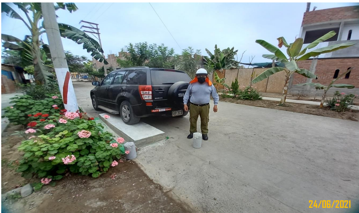
Figura 85: Se muestra el sometimiento real del peso de un vehículo liviano como una prueba de la deformación real en campo, en la cual se evidencia que el pavimento no sufre ningún deterioro, fisuras en la muestra del pavimento rígido de dimensiones de 2.50m x 0.60m x 0.22cm.
