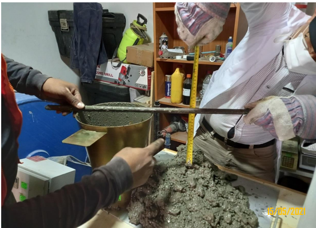
Figura 69: prueba de slump de la mezcla para vaciado de las probetas, en donde se visualiza un asentamiento 12cm que corresponde a consistencia fluida.
