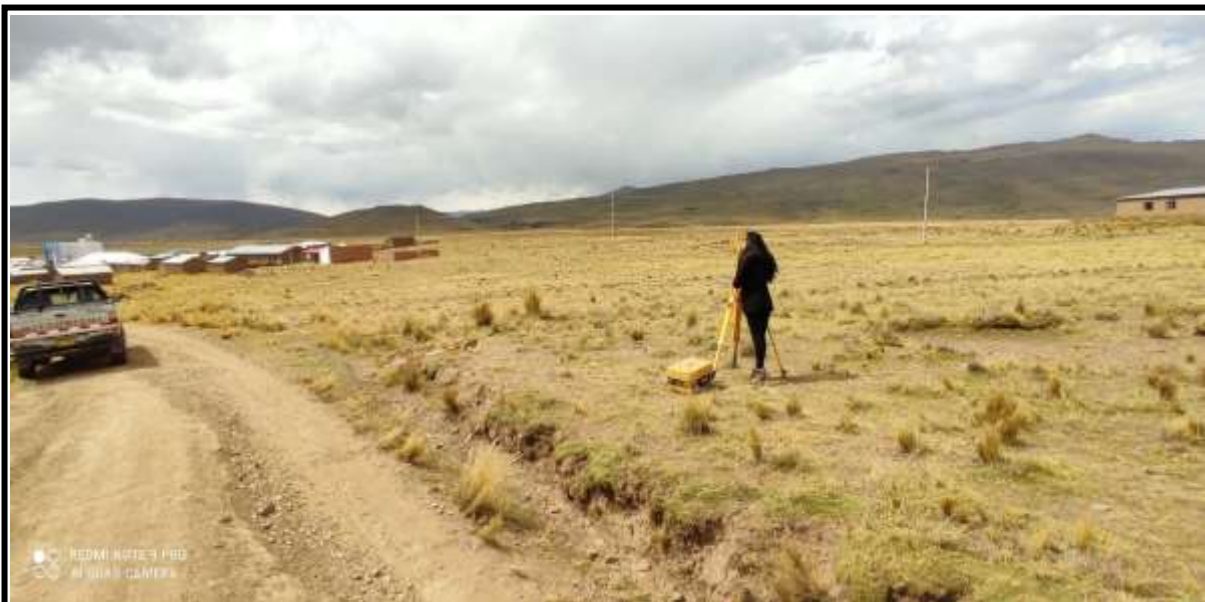
Fotografía 04: Lectura de vista atrás para punto de cambio.
