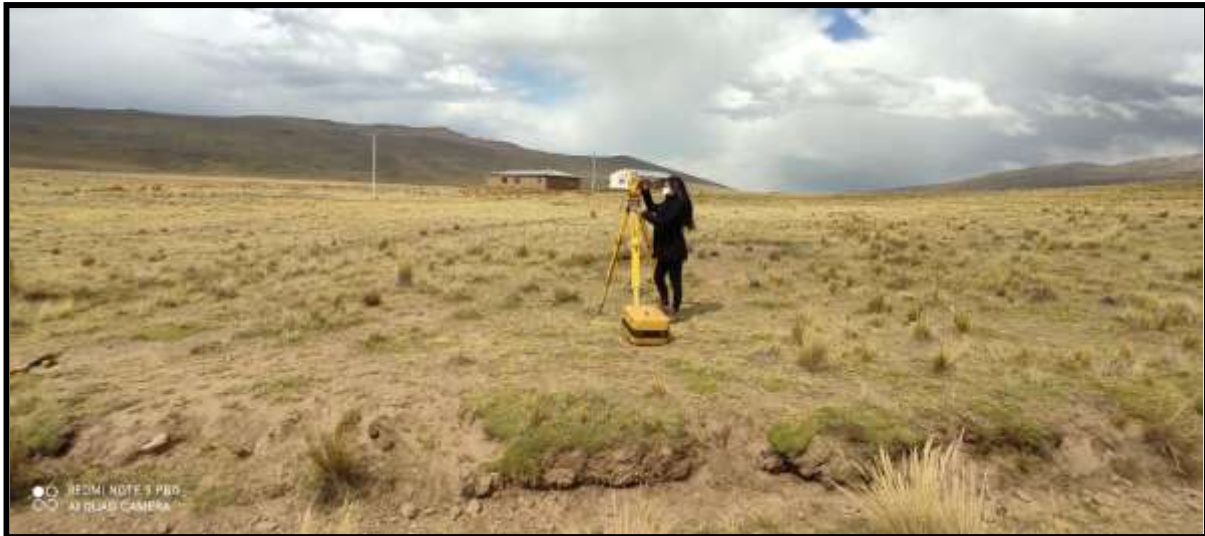
Fotografía 03: Estacionando el equipo para levantar los Puntos para el sistema de Agua Potable y Alcantarillado
