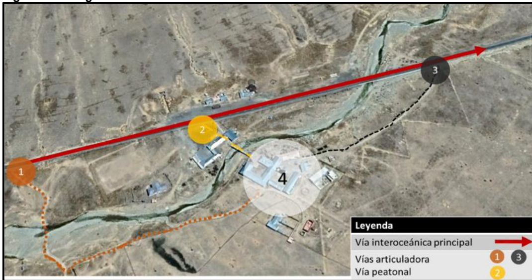
Figura 20 : Integración de vías internas en el terreno
